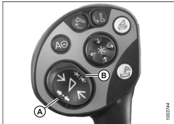
Figura 3.505: Pulsanti del controller CLAAS
