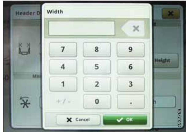
Figura 3.698: Display di John Deere S7 – Impostazione della larghezza della testata
