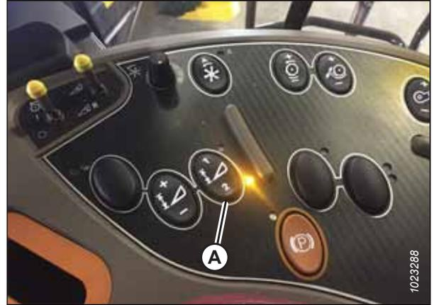
Figura 3.435: Quadro strumenti della mietitrebbia Case
