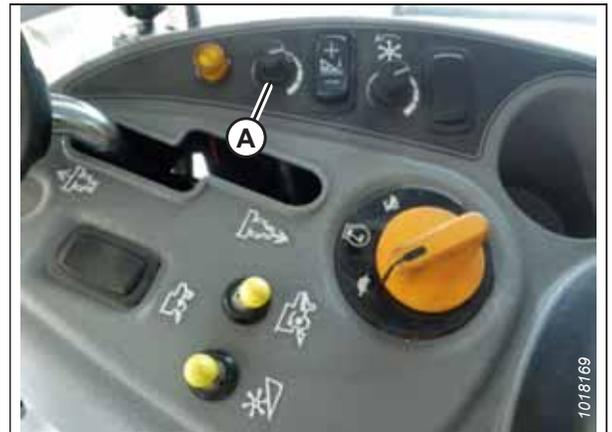
**Figura 3.484: Manopola di regolazione dell'altezza sul quadro strumenti della mietitrebbia**
