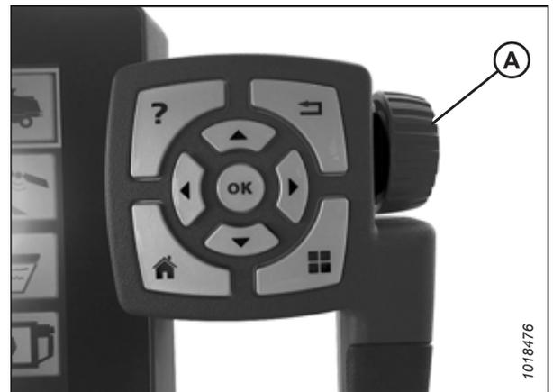
Figura 3.601: Rotella di regolazione sul lato destro del terminale Tyton
