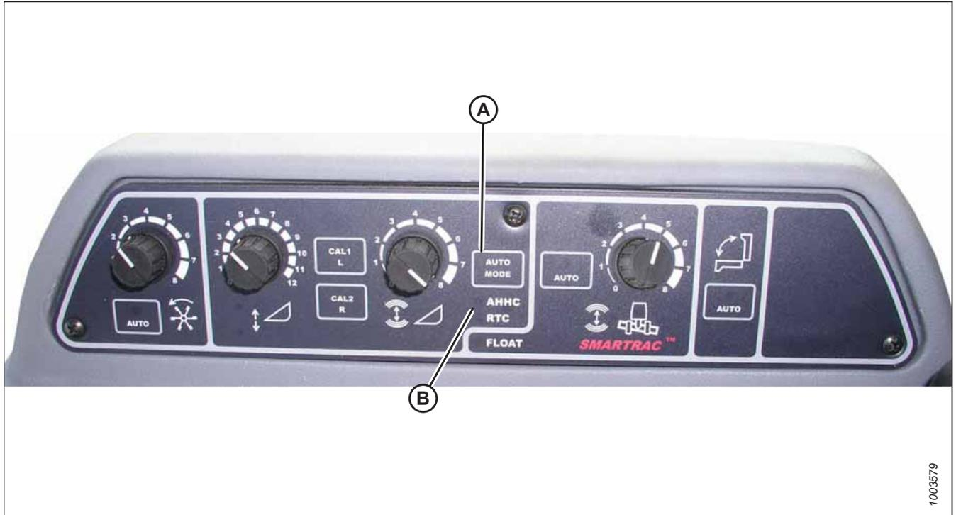
Figura 3.559: Controllo dell'altezza automatica testata della mietitrebbia
