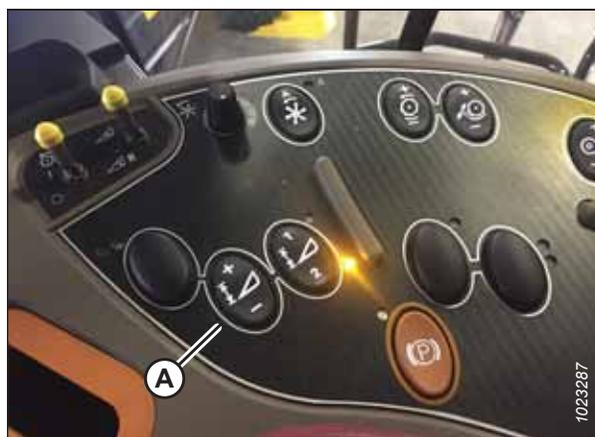
Figura 3.439: Quadro strumenti della mietitrebbia Case
