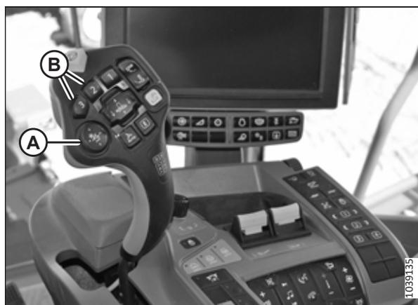
Figura 3.753: John Deere X9 – Leva multifunzione
