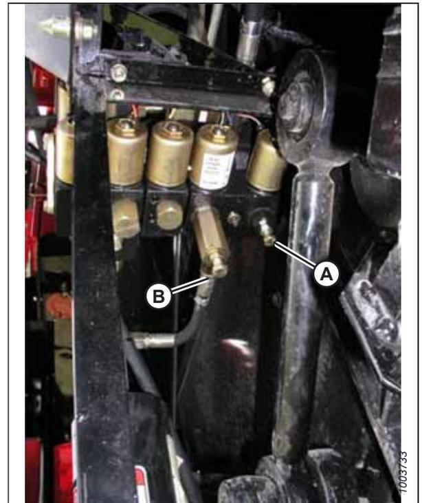
**Figura 3.563: Limitatori regolabili di sollevamento e abbassamento testata**
