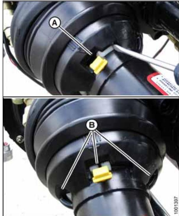
Figura 4.53: Protezione della trasmissione
