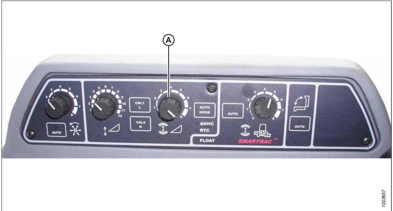
**Figura 3.566: Quadro strumenti di controllo dell'altezza automatica testata**
