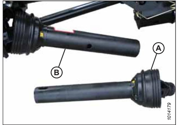
Figura 4.51: Trasmissione separata
