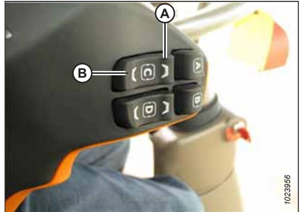
Figura 3.315: Comandi di inclinazione longitudinale del collo alimentatore per John Deere 700
