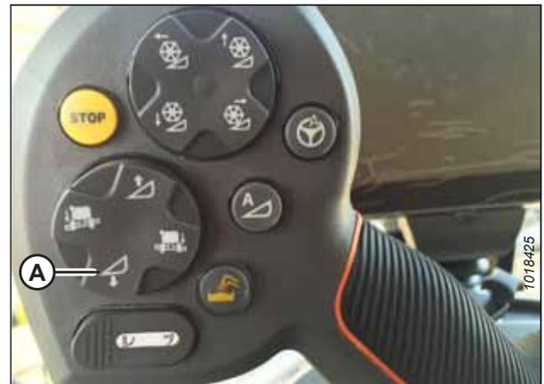
Figura 3.590: Interruttore di abbassamento testata
