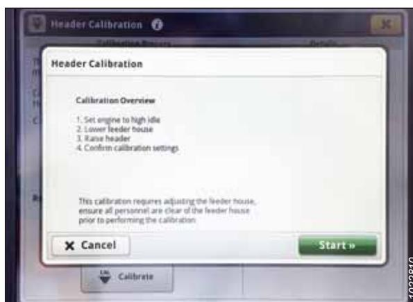
Figura 3.723: Display di John Deere S7 – Header Calibration (Calibrazione della testata)
