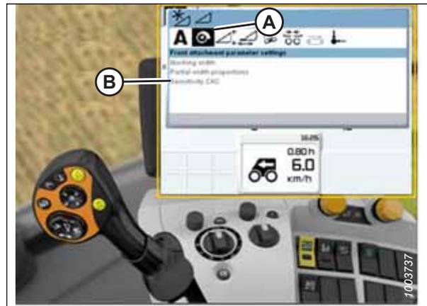
Figura 3.518: Display, quadro strumenti e controller della mietitrebbia CLAAS
