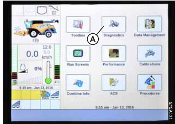
Figura 3.790: Display della mietitrebbia New Holland
