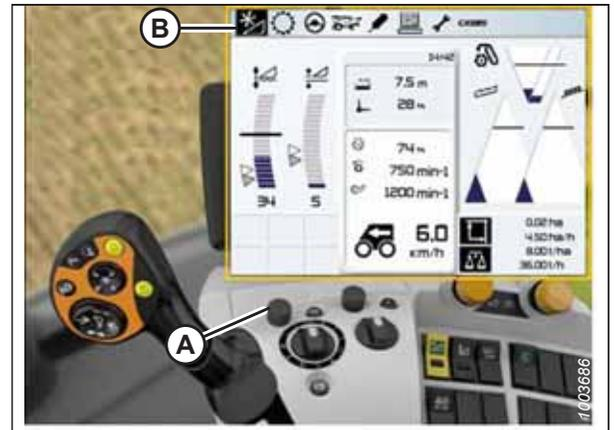
Figura 3.510: Display, quadro strumenti e controller della mietitrebbia CLAAS
