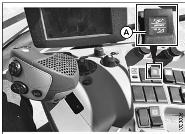
Figura 3.239: Interruttore basculante multifunzione
