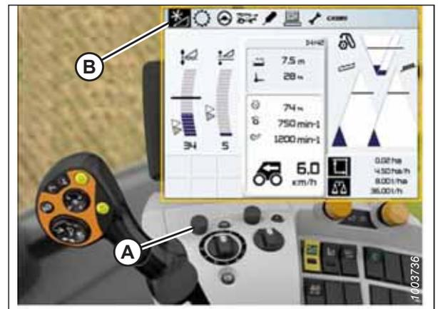
Figura 3.520: Display, quadro strumenti e controller della mietitrebbia CLAAS
