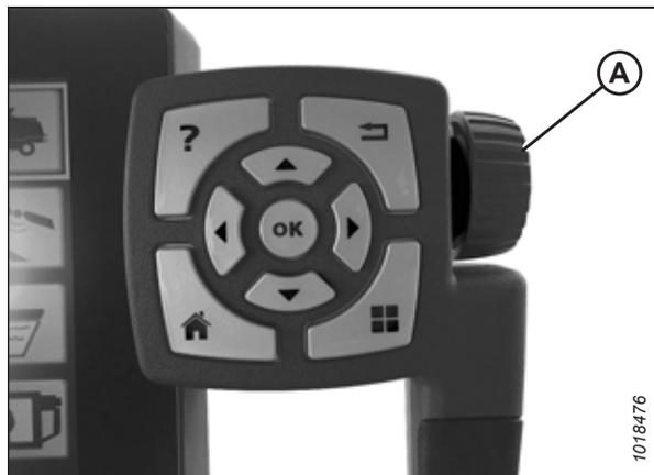
Figura 3.631: Rotella di regolazione sul lato destro del terminale Tyton
