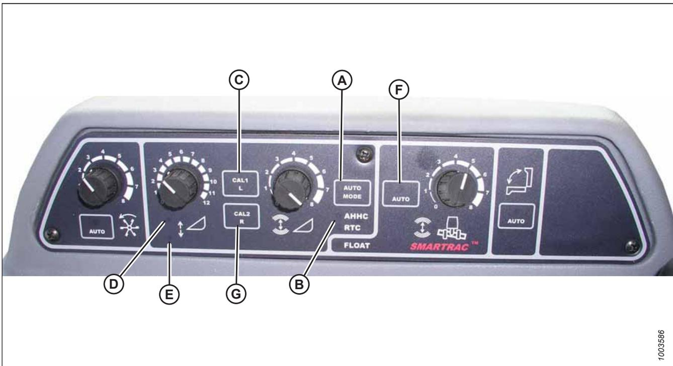
Figura 3.561: Controllo dell'altezza automatica testata della mietitrebbia
