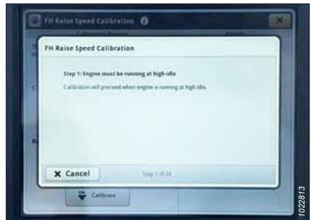
Figura 3.716: Display di John Deere S7 – Calibrazione del collo alimentatore
