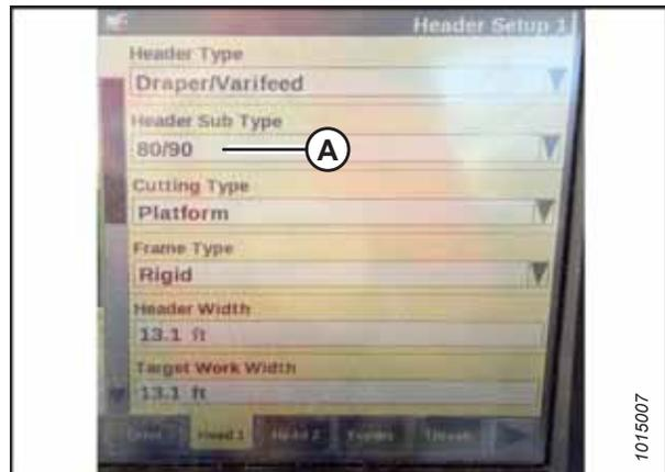
Figura 3.829: Display della mietitrebbia New Holland
