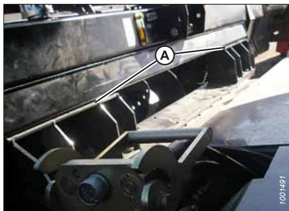
Figura 3.42: Collo alimentatore e modulo flottazione
