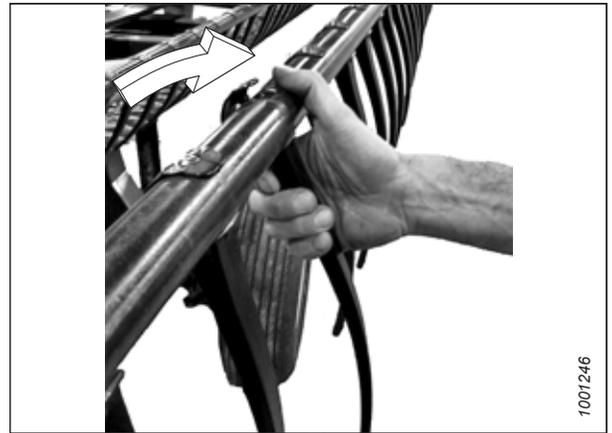
Figura 4.296: Installazione del dito in plastica
