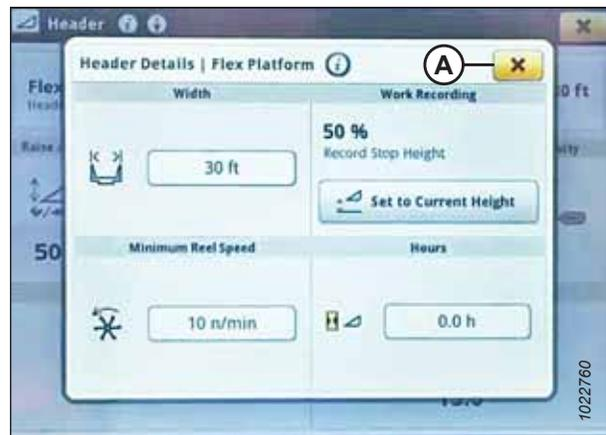
Figura 3.699: Display di John Deere S7 – Finestra di dialogo HEADER DETAILS (Dettagli testata)
