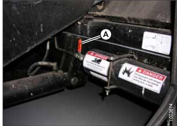
**Figura 3.562: Interruttore ON/OFF dell'accumulatore della mietitrebbia**
