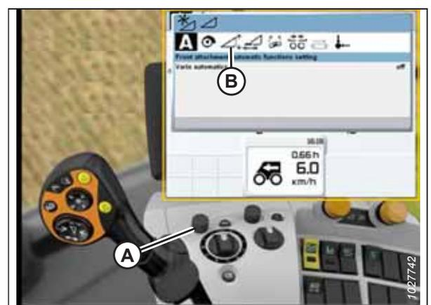
Figura 3.512: Display, quadro strumenti e controller della mietitrebbia CLAAS
