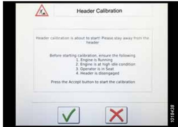
Figura 3.592: Avvertenza sulla calibrazione della testata
