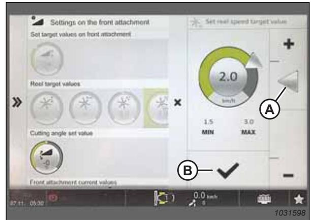
Figura 3.550: Schermata Valore target velocità dell'aspo
