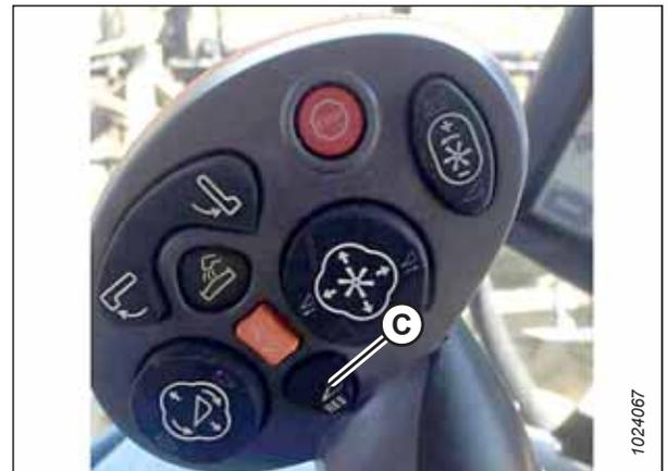
Figura 3.821: Leva multifunzione della mietitrebbia New Holland
