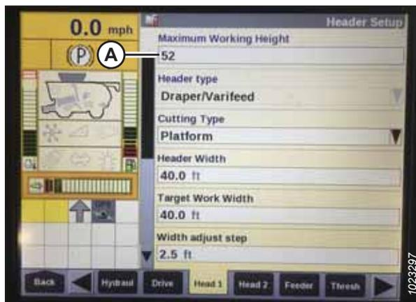
Figura 3.438: Display della mietitrebbia Case – Schermata di impostazione testata
