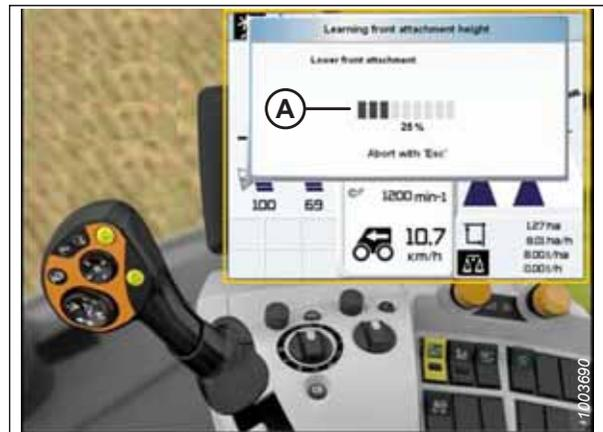
Figura 3.514: Display, quadro strumenti e controller della mietitrebbia CLAAS
