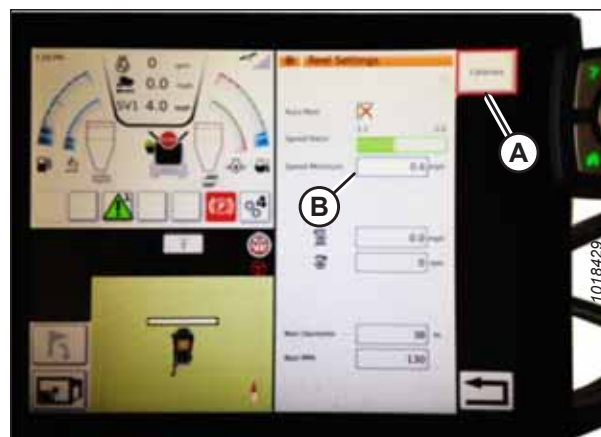
Figura 3.399: Calibração das configurações do molinete
