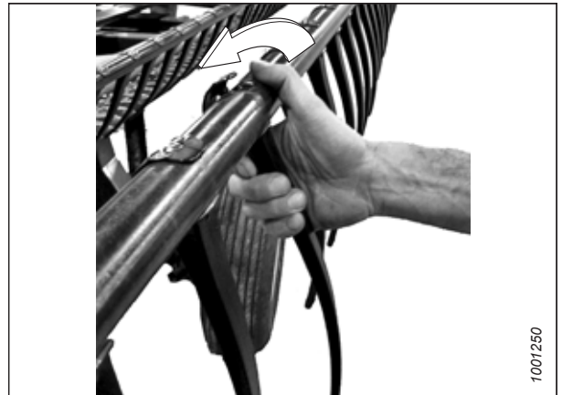
Figura 5.244: Remoção do dedo de plástico
