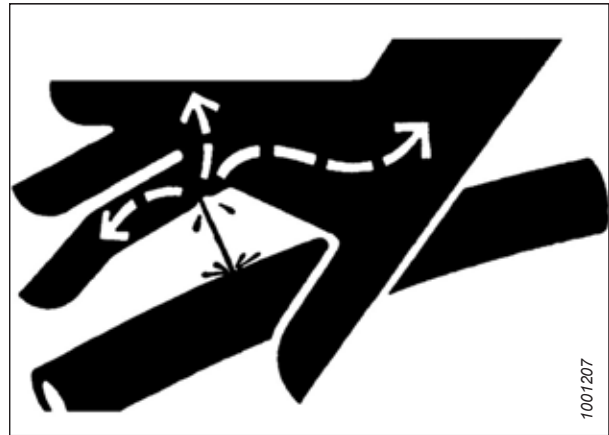
Figura 5.1: Perigo da pressão hidráulica
