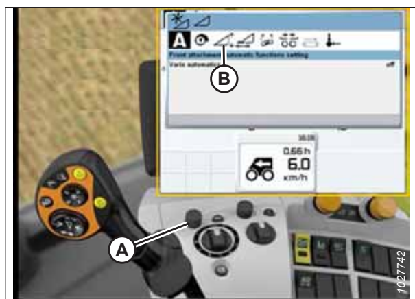
Figura 3.293: Monitor da colheitadeira CLAAS, console e alavanca de controle
