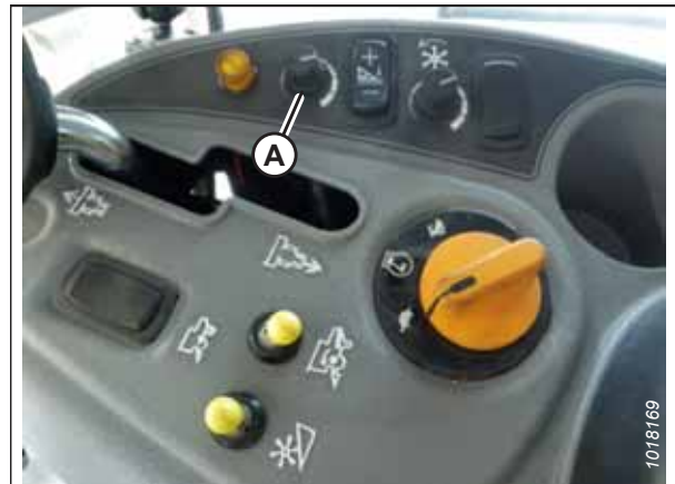
Figura 3.265: Botão de ajuste de altura no console de controle da colheitadeira
