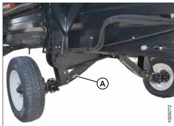
Figura 3: Local da roda de transporte/estabilizadora
