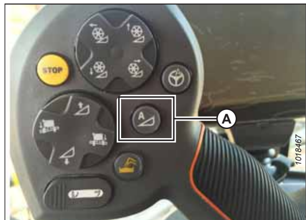
Figura 3.383: AHHC (Controle Automático de Altura da Plataforma) na alavanca de controle
