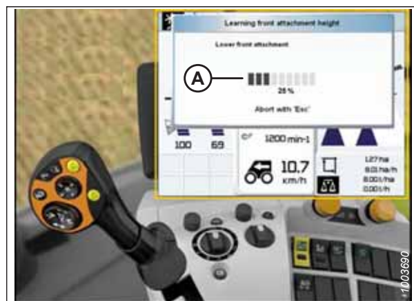
Figura 3.295: Monitor da colheitadeira CLAAS, console e alavanca de controle
