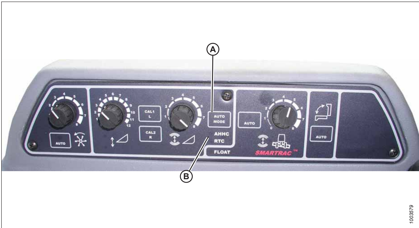
Figura 3.344: Controles de altura automática da plataforma da colheitadeira
