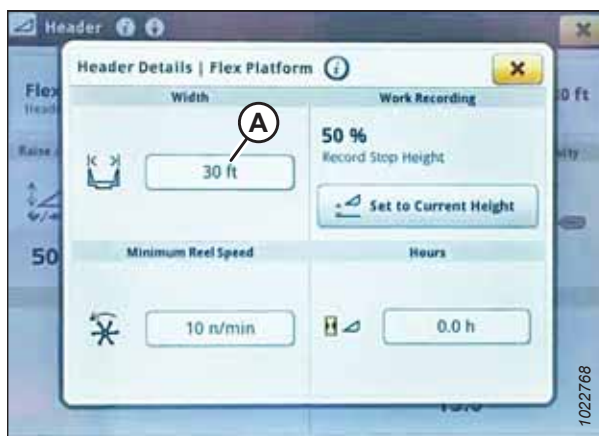
Figura 3.494: Monitor John Deere S7 – Janela de detalhes da plataforma
