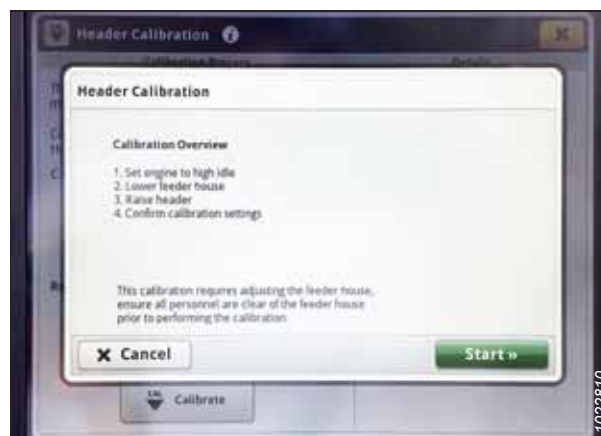
Figura 3.520: Monitor John Deere S7 – Calibração da plataforma
