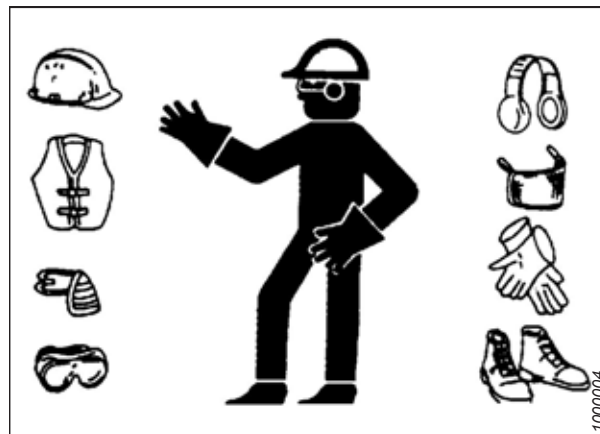
Figura 1.2: Equipamento de segurança
