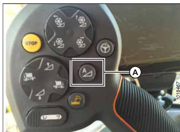
Figura 3.413: AHC (Controle Automático de Altura da Plataforma) na alavanca de controle
