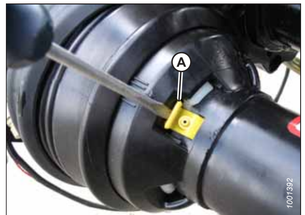
Figura 5.43: Proteção do eixo de transmissão
