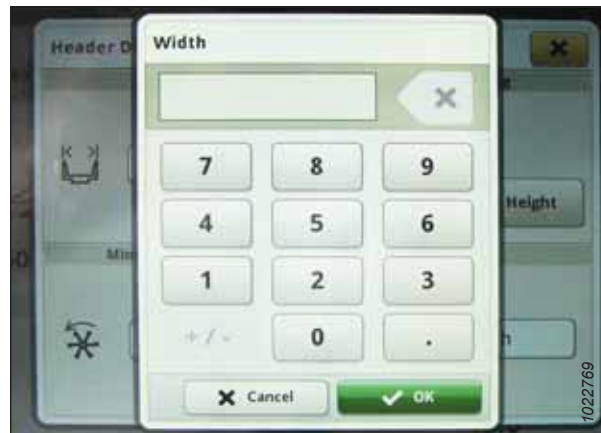
Figura 3.495: Monitor John Deere S7 – Ajuste de largura da plataforma
