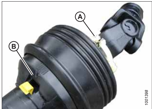
Figura 5.45: Proteção do eixo de transmissão
