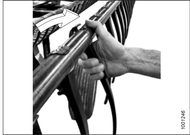
Figura 5.245: Instalação do dedo de plástico
