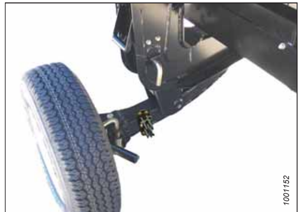
Figura 3.600: Roda esquerda em posição de transporte
