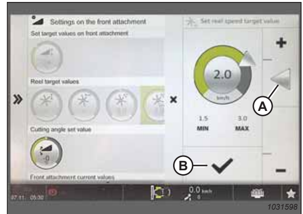
Figura 3.336: Página do valor alvo de velocidade do molinete
