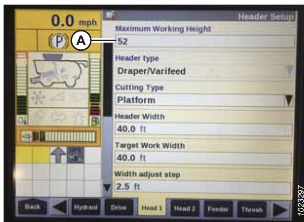
Figura 3.207: Monitor da colheitadeira Case – Tela de configuração da plataforma
