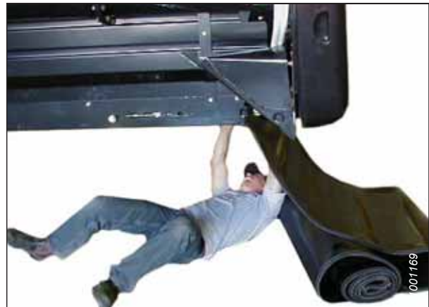
Figura 5.189: Instalação das esteiras
