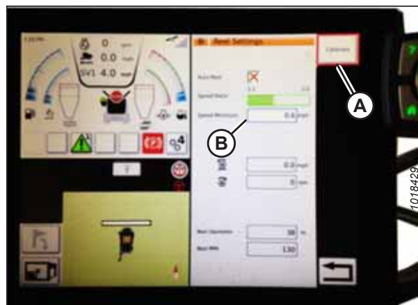
Figura 3.365: Calibração das configurações do molinete
