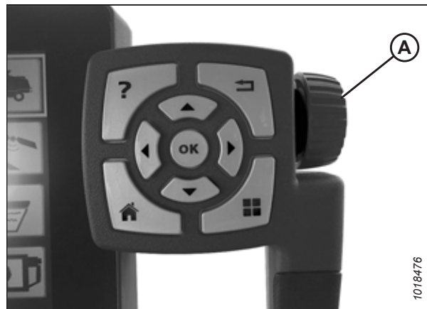
Figura 3.416: Roda de ajuste direita do terminal Tyton
