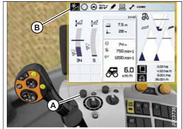
Figura 3.298: Monitor da colheitadeira CLAAS, console e alavanca de controle
