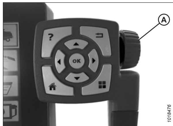
Figura 3.386: Roda de ajuste no lado direito do terminal Tyton
