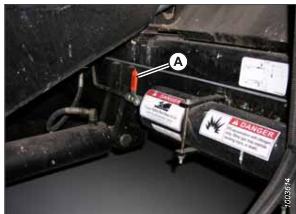
Figura 3.347: Interruptor Ligar/Desligar do acumulador da colheitadeira
