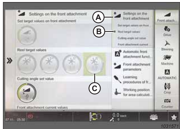
Figura 3.335: Página de configurações no acoplamento dianteiro
