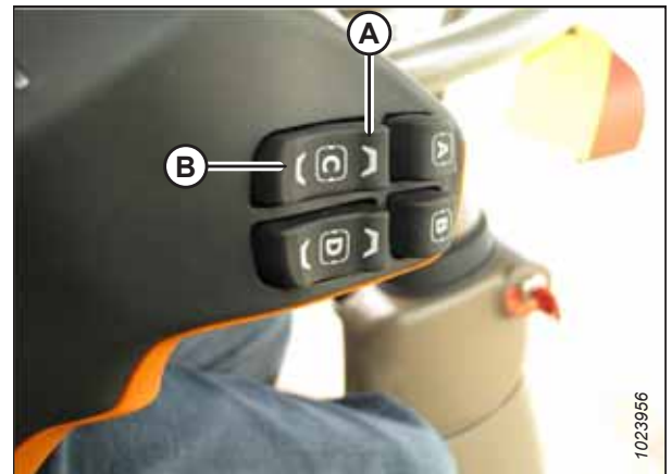
Figura 3.89: Controles de inclinação do avanço-recuo do alimentador John Deere 700
