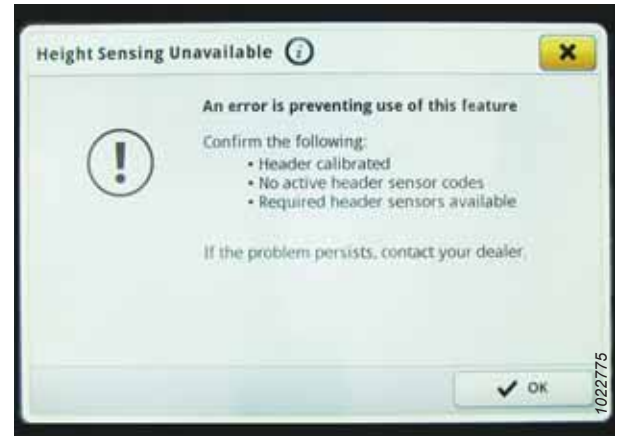
Figura 3.501: Monitor John Deere S7 – Mensagem de erro do sensor de altura
