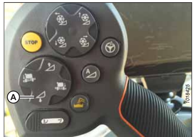
Figura 3.375: Interruptor de descida da plataforma
