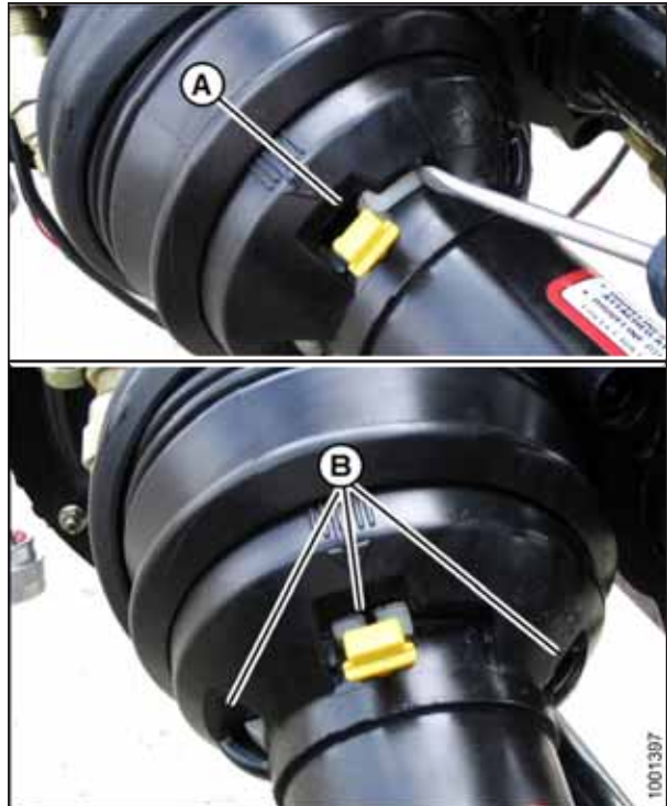
Figura 5.44: Proteção do eixo de transmissão
