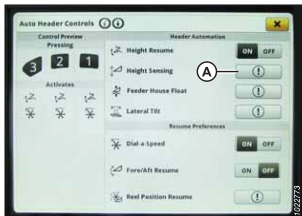
Figura 3.500: Monitor John Deere S7 – Controle automático da plataforma
