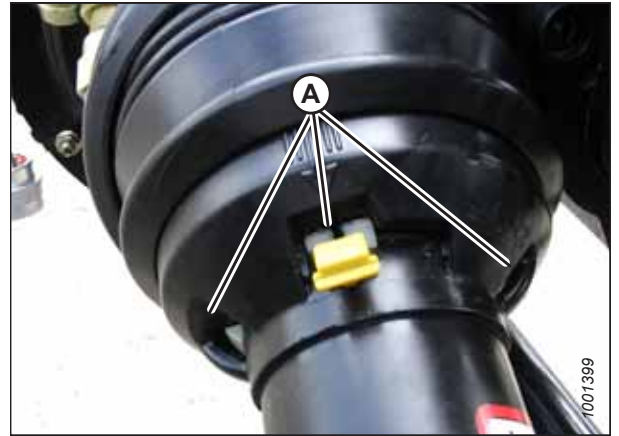
Figura 5.46: Proteção do eixo de transmissão
