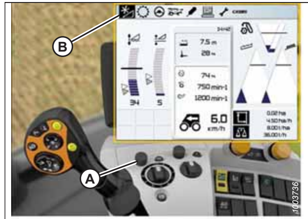
Figura 3.301: Monitor da colheitadeira CLAAS, console e alavanca de controle
