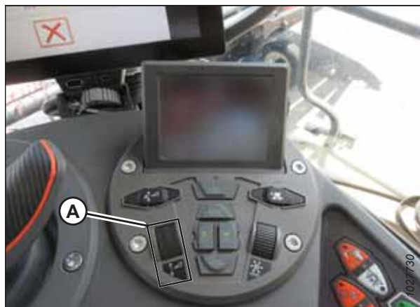
Figure 3.432: Groupe de commande de la plateforme
