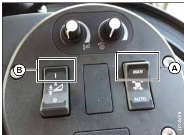
Figure 3.397: Groupe de commande de la plateforme
