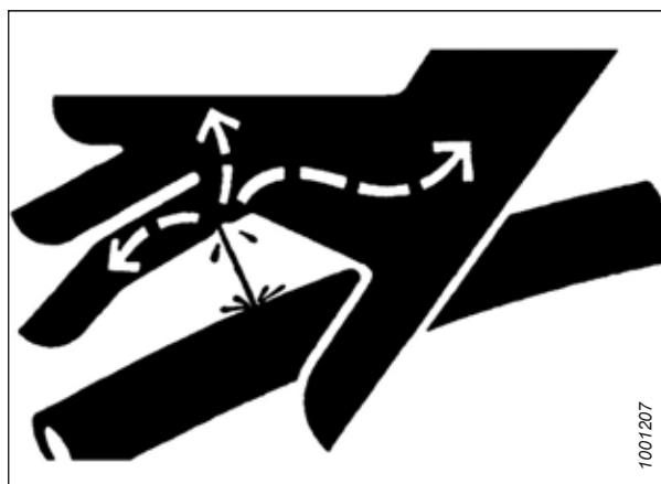
Figure 5.1: Risque lié à la pression hydraulique
