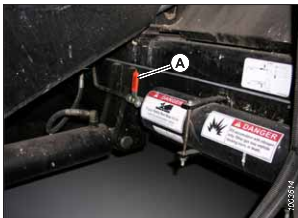
Figure 3.362: Commutateur ON/OFF (marche/arrêt) de l'accumulateur de la moissonneuse-batteuse A – Levier de l'accumulateur (position Off)
