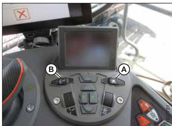
Figure 3.427: Groupe de commande de la plateforme
