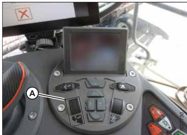
Figure 3.429: Groupe de commande de la plateforme
