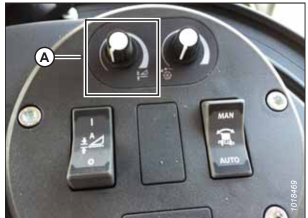
Figure 3.399: Groupe de commande de la plateforme
