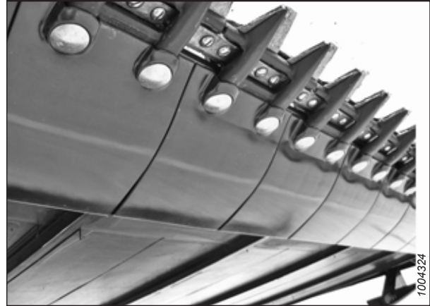
Figure 6.8: Plaques d'usure de la barre de coupe
