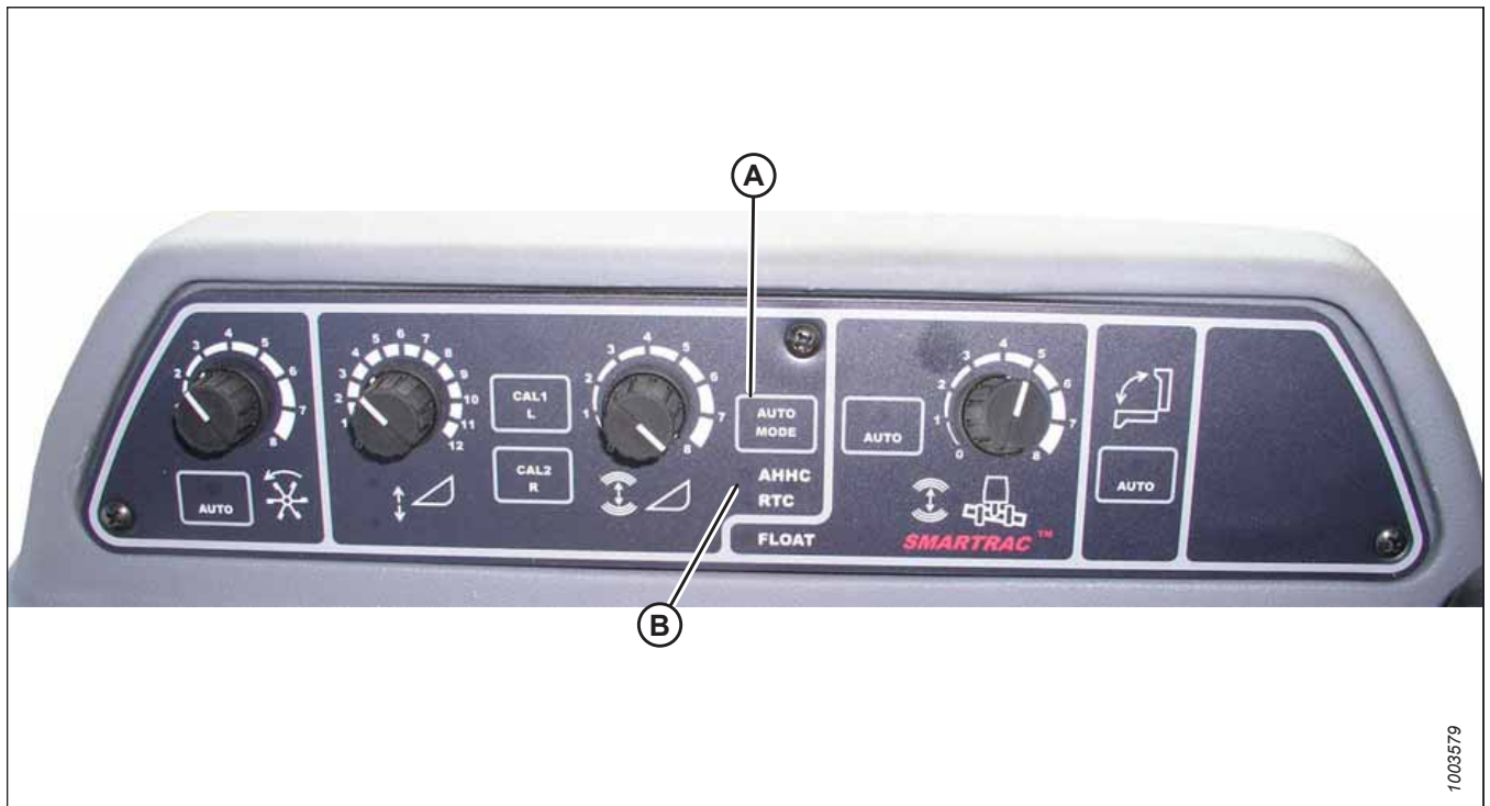
Figure 3.359: Commandes du système de réglage automatique de la hauteur de la plateforme de la moissonneuse-batteuse
