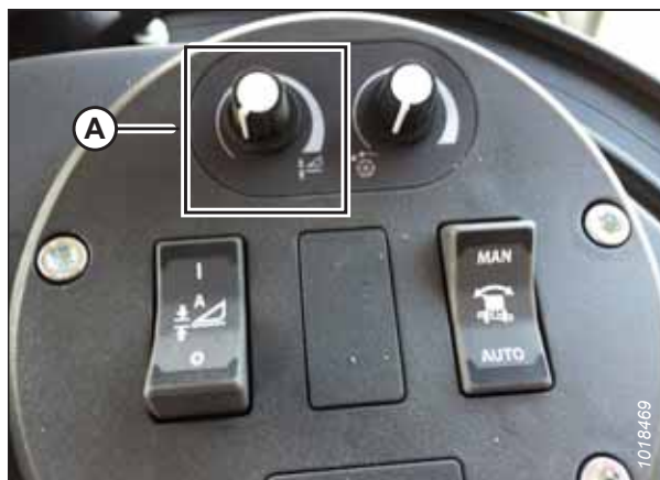
Figure 3.402: Groupe de commande de la plateforme
