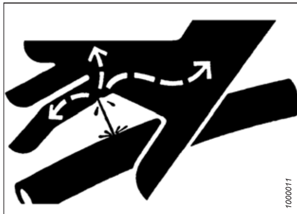
Obrázek 5.26: Nebezpečí tlaku v hydraulice
