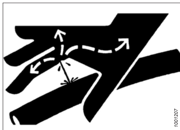
Obrázek 1.12: Nebezpečí tlaku v hydraulice
