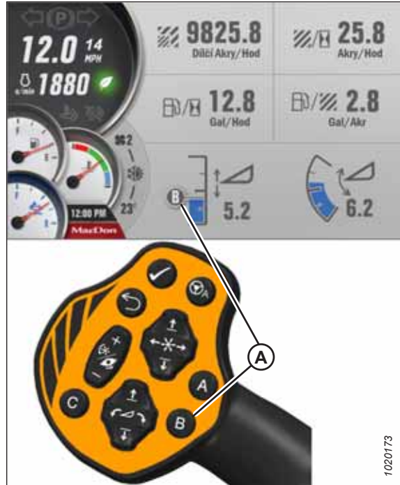
Obrázek 4.91: Tlačítka vrácení jedním dotykem na páce GSL
