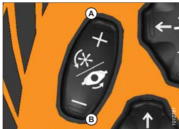
Obrázek 3.60: Přepínač rychlosti přiháněče a kotouče na páce GSL
