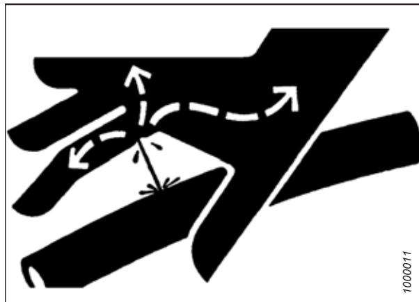
Obrázek 5.55: Nebezpečí tlaku v hydraulice
