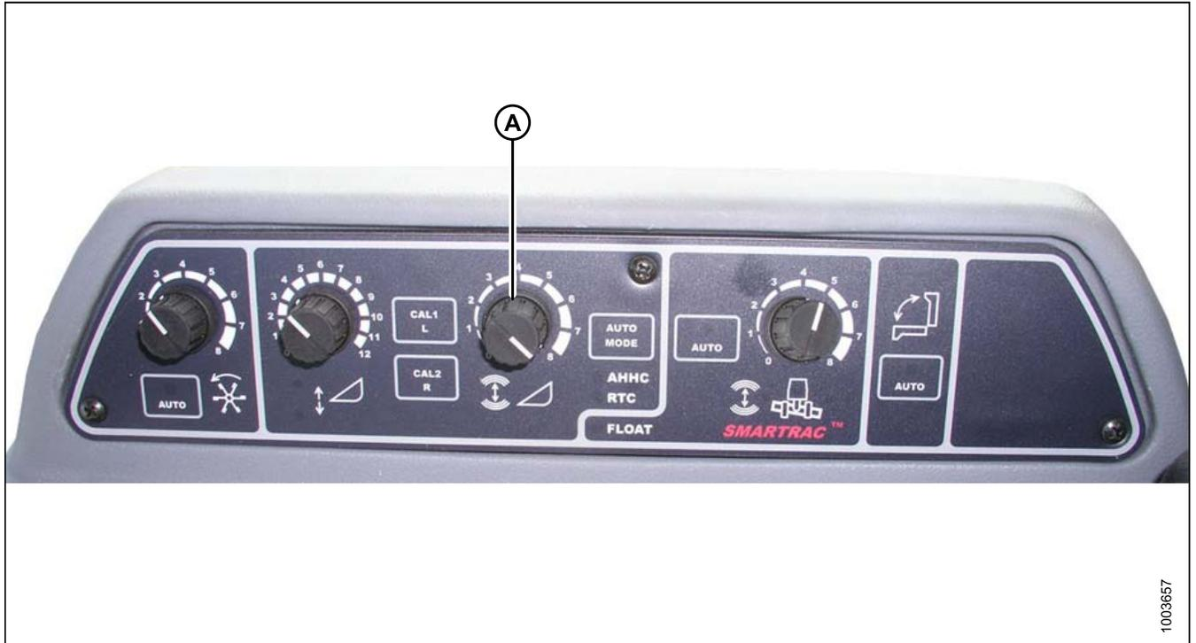
**Figura 3.164: Consola de control automático de altura de la plataforma (AHHC)**
