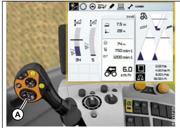
Figura 3.237: Consola, palanca de mando y pantalla de la cosechadora
