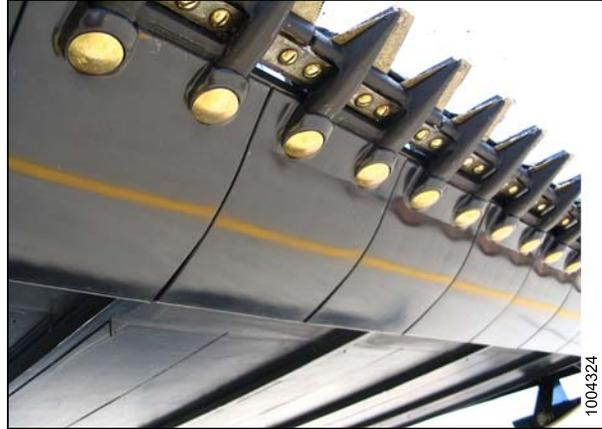
Figura 6.5: Placa protectora de la barra de corte
