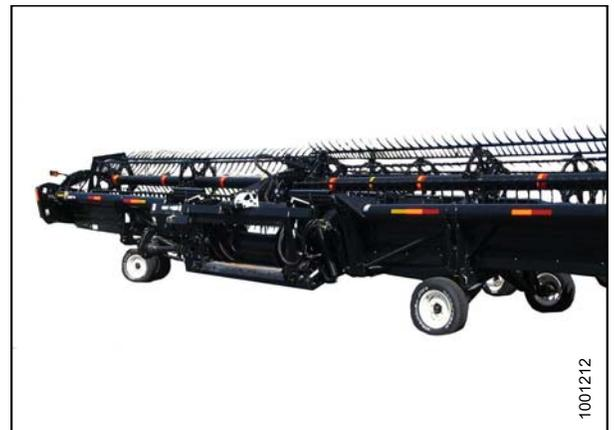
Figura 6.12: Ruedas de transporte/estabilizadoras
