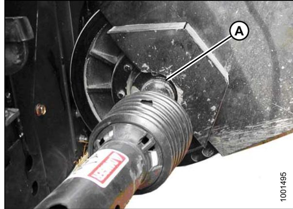
Figura 4.91: Desconexión del mando
