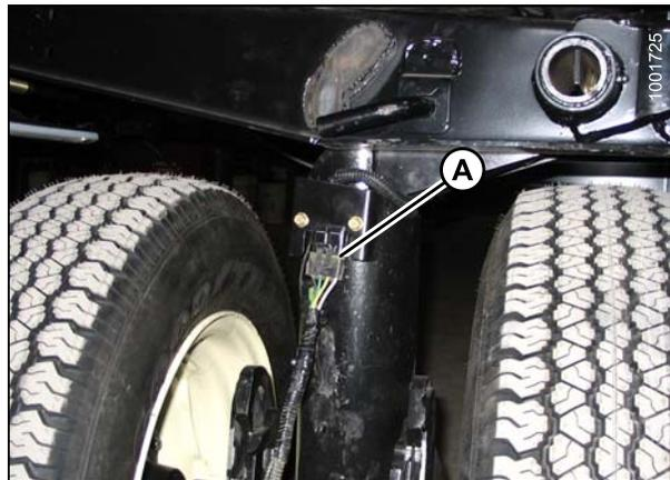
Figura 3.270: Conector de cableado
