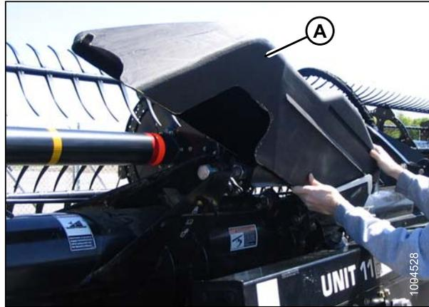
**Figura 3.19: Cubierta de conexión**
