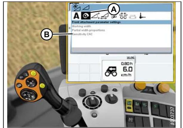
**Figura 3.239: Consola, palanca de mando y pantalla de la cosechadora**
