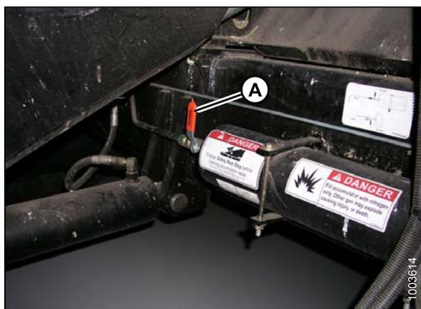
**Figura 3.160: Interruptor de encendido/apagado del acumulador de la cosechadora**
