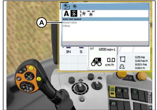
Figura 3.228: Consola, palanca de mando y pantalla de la cosechadora
