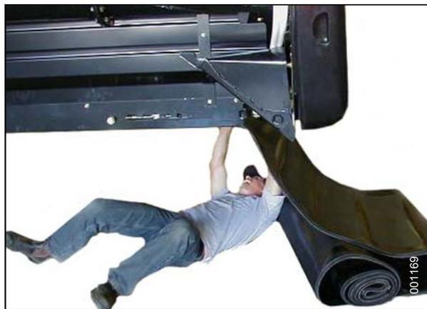
Figura 5.156: Instalación de la lona
