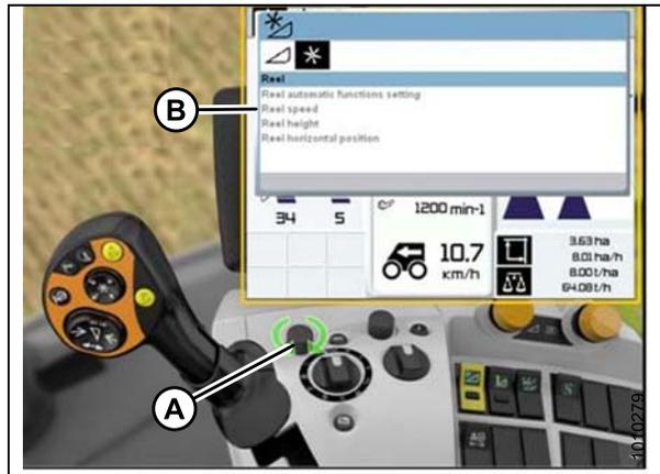
Figura 3.227: Consola, palanca de mando y pantalla de la cosechadora
