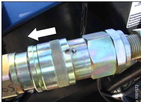
**Figura 4.124: Desconexión rápida**
