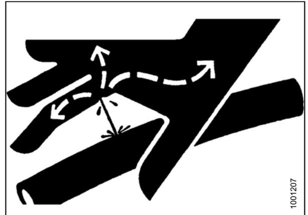
Figura 1.12: Peligro de presión hidráulica
