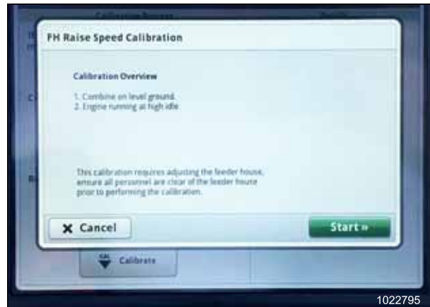
Figura 3.406: Pantalla de John Deere S7: Calibración del embocador
