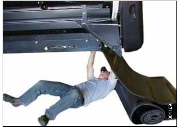
Figura 5.183: Instalación de la lona
