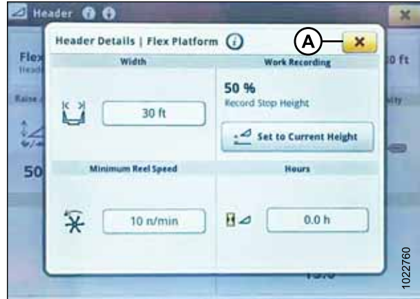
Figura 3.390: Pantalla de John Deere S7: Ventana de detalles del cabezal
