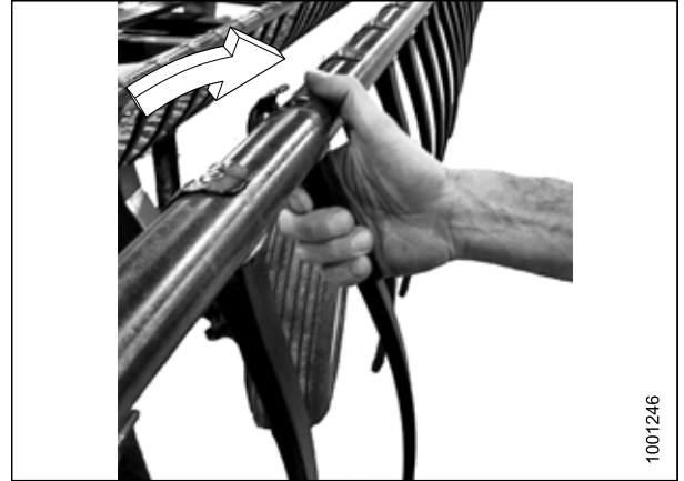
Figura 5.234: Instalación de dientes de plástico
