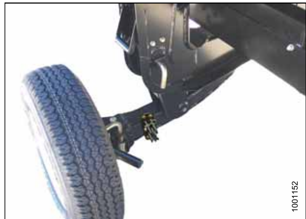
Figura 3.534: Rueda izquierda en posición de transporte
