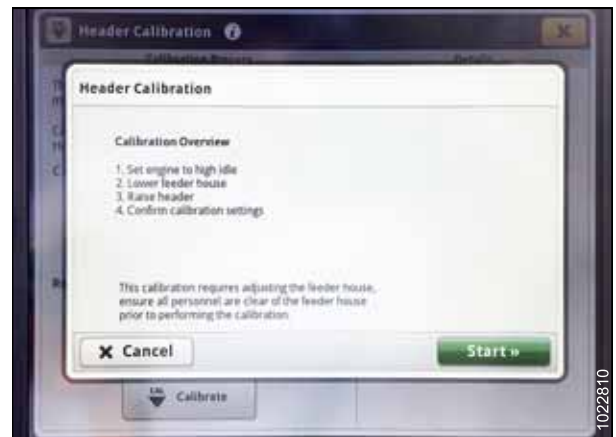
Figura 3.414: Pantalla de John Deere S7: Calibración del cabezal
