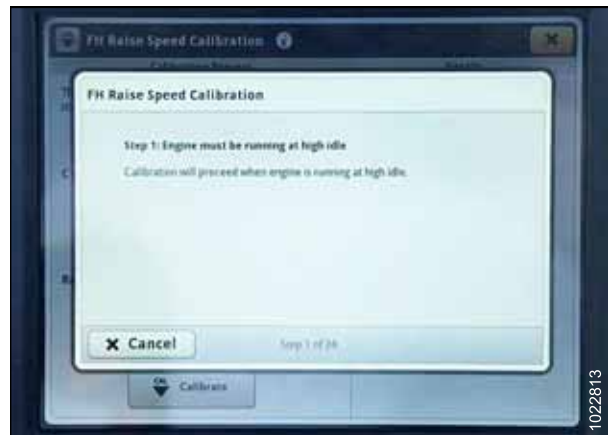
Figura 3.407: Pantalla de John Deere S7: Calibración del embocador
