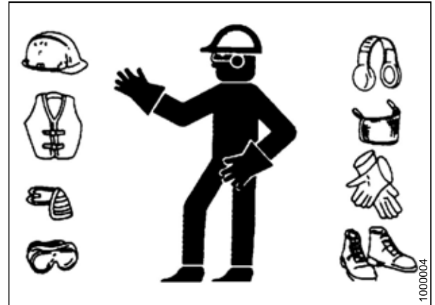
Figura 1.2: Equipamiento de seguridad
