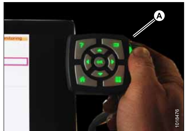
Figura 3.311: La rueda de ajuste (A) en el lado derecho del terminal Tyton.
