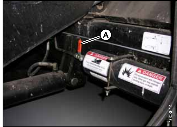
Figura 3.272: Interruptor de ENCENDIDO/APAGADO del acumulador de la cosechadora
