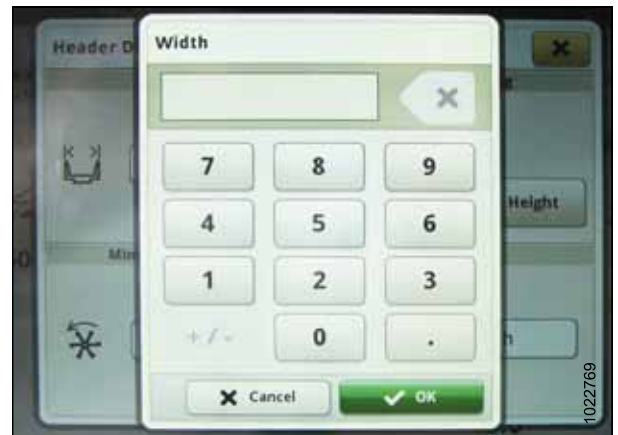
Figura 3.389: Pantalla de John Deere S7: Configuración del ancho del cabezal
