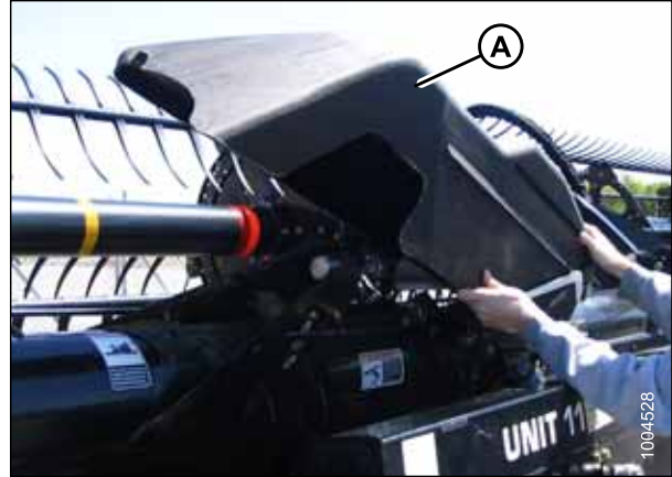
Figura 3.19: Cubierta de conexión
