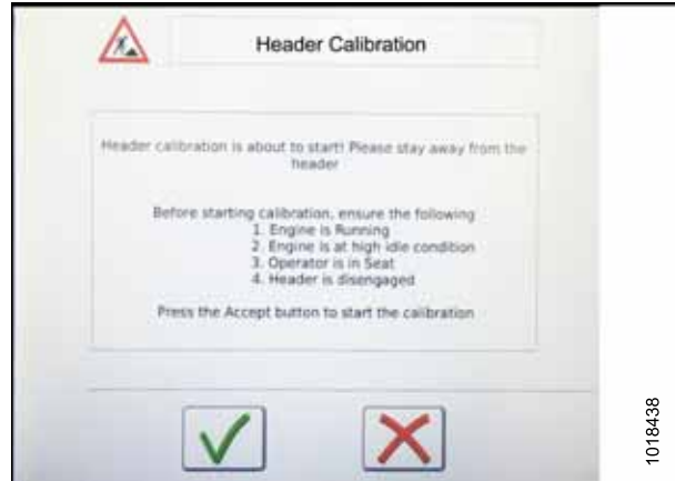
Figura 3.302: Advertencia de calibración de la plataforma
