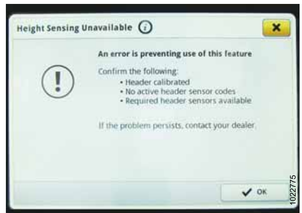
Figura 3.395: Pantalla de John Deere S7: Mensaje de error de detección de altura
