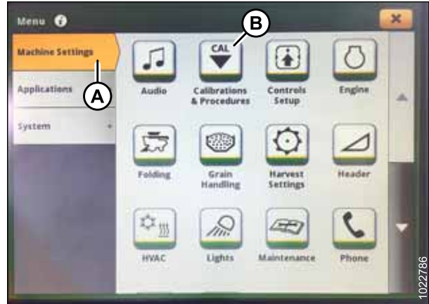
Figura 3.410: Pantalla de John Deere S7: Configuración de la máquina
