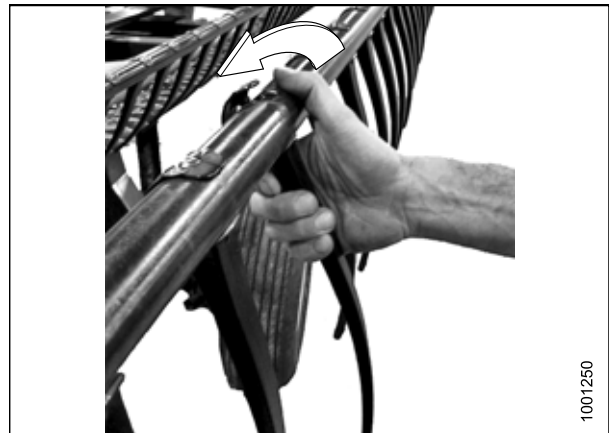
Figura 5.233: Extracción del diente de plástico
