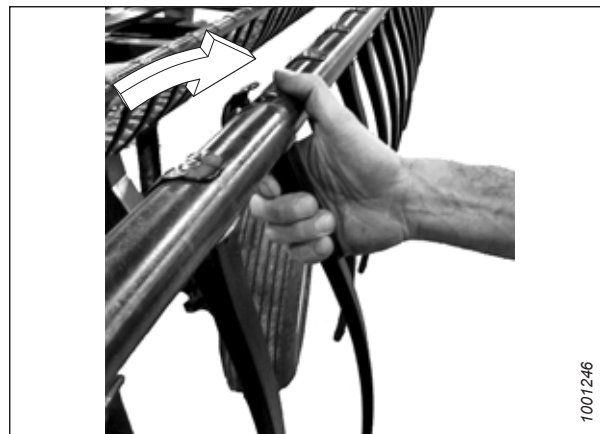
Figure 4.290: Installation des doigts en plastique
