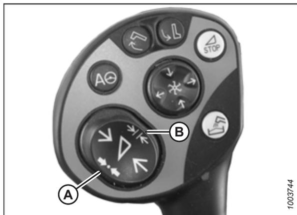
Figure 3.424: Boutons de la Poignée de commande CLAAS
