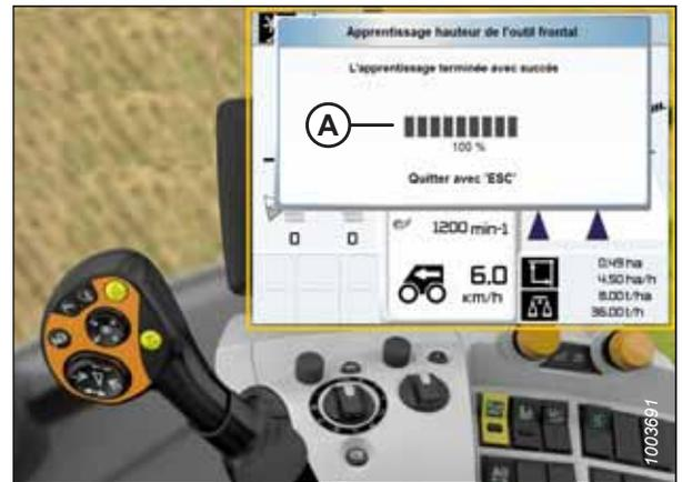
Figure 3.449: Écran, console et levier de commande de la moissonneuse-batteuse CLAAS
