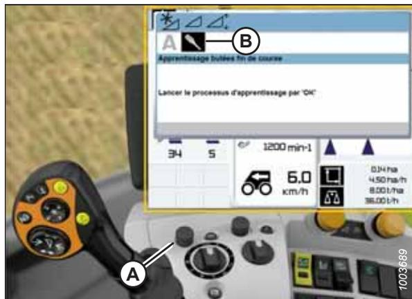
Figure 3.432: Écran, console et levier de commande de la moissonneuse-batteuse CLAAS
