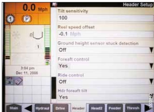
Figure 3.369: Afficheur de la moissonneuse-batteuse Case IH
