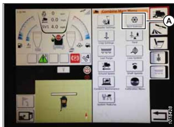
Figure 3.502: Paramètres du rabatteur dans le menu principal de la moissonneuse-batteuse
