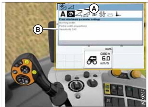
Figure 3.438: Écran, console et levier de commande de la moissonneuse-batteuse CLAAS
