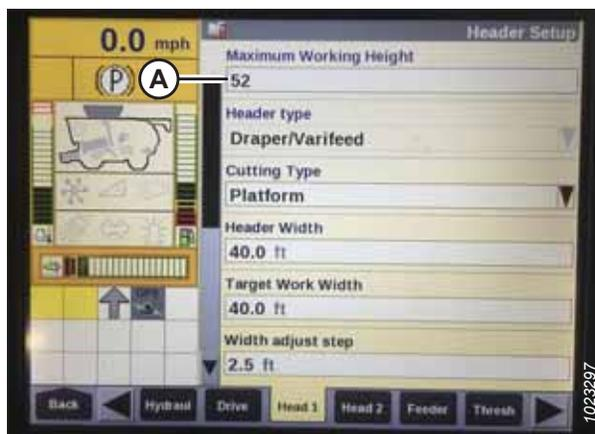
Figure 3.356: Écran de la moissonneuse-batteuse Case – page de configuration de la plateforme
