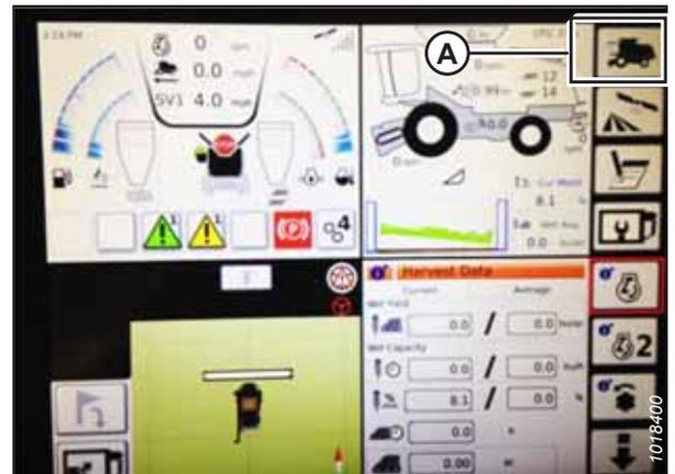
Figure 3.493: Icône moissonneuse-batteuse sur la page d'accueil
