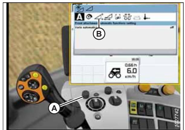
Figure 3.431: Écran, console et levier de commande de la moissonneuse-batteuse CLAAS
