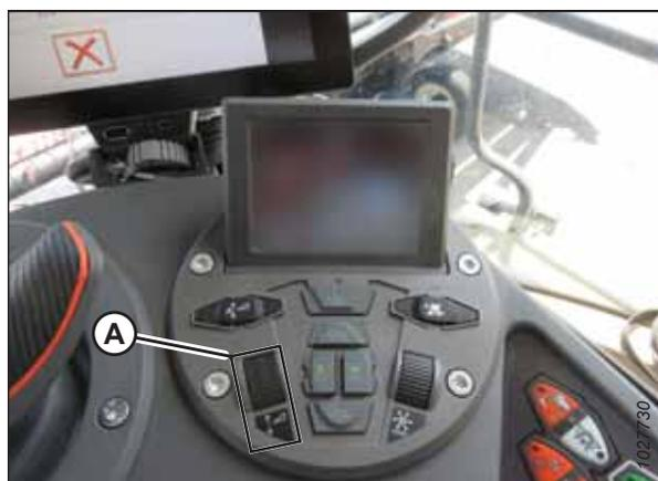
Figure 3.552: Groupe de commande de la plateforme
