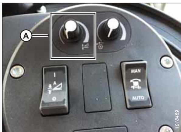
Figure 3.522: Groupe de commande de la plateforme
