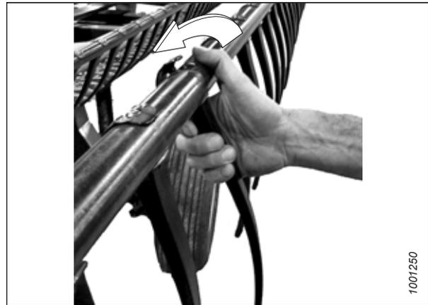
Figure 4.289: Retrait des doigts en plastique
