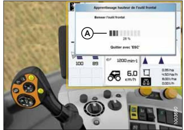
Figure 3.448: Écran, console et levier de commande de la moissonneuse-batteuse CLAAS
