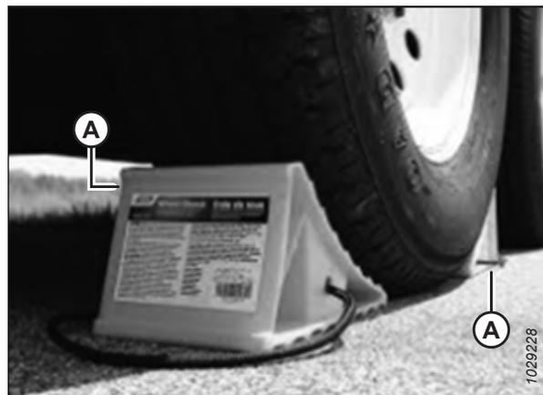
Figure 3.805: Blocage des pneus
