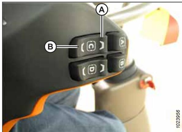
Figure 3.248: Commandes d'inclinaison avant-arrière du convoyeur John Deere 700
