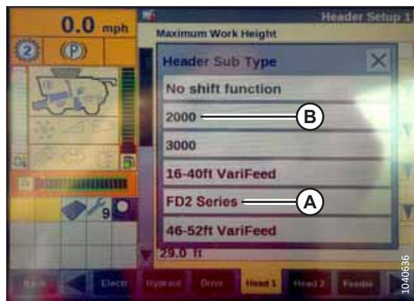
Figure 3.376: Afficheur de la moissonneuse-batteuse Case IH
