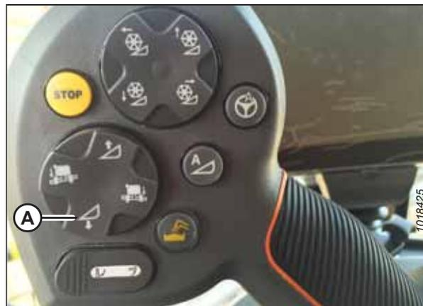
Figure 3.513: Commutateur d'abaissement de la plateforme
