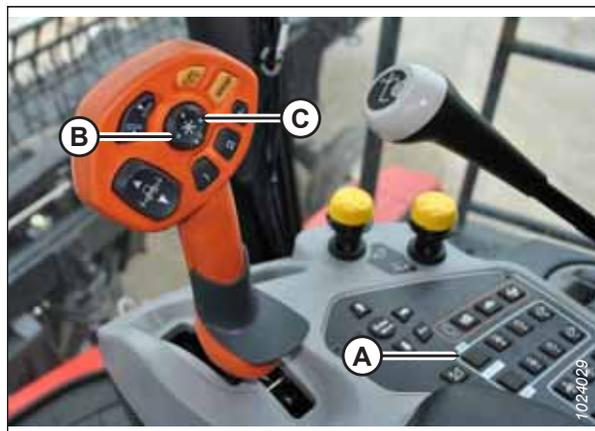
Figure 3.253: Poignée de commande et console Rostselmash
