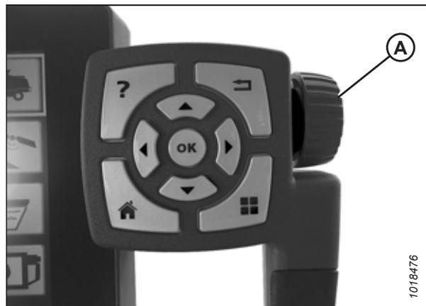
Figure 3.524: Roue de réglage sur le côté droit du terminal de Tyton
