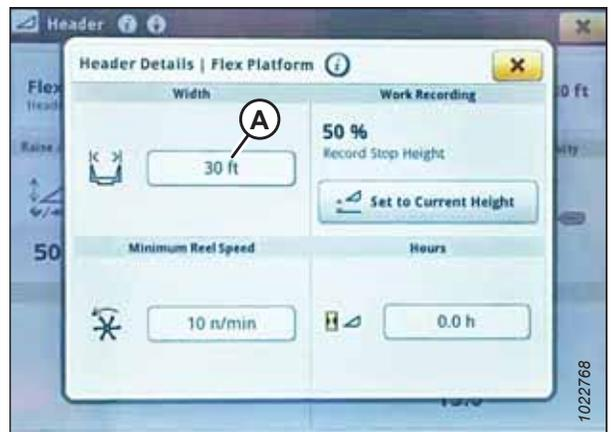
Figure 3.620: Écran John Deere S7 – fenêtre Header Details (détails de la plateforme)
