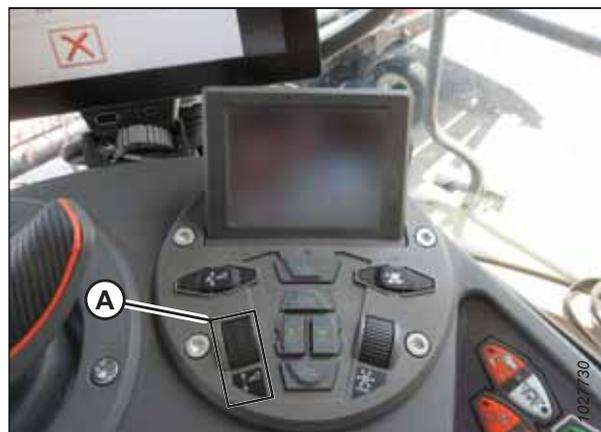
Figure 3.555: Groupe de commande de la plateforme
