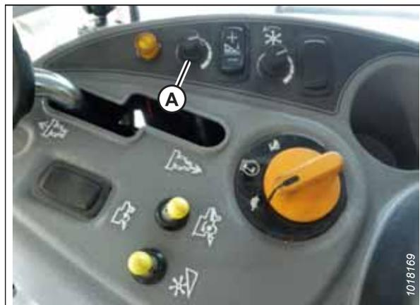
**Figure 3.402: Bouton de réglage de la hauteur sur la console de commande de la moissonneuse-batteuse**
