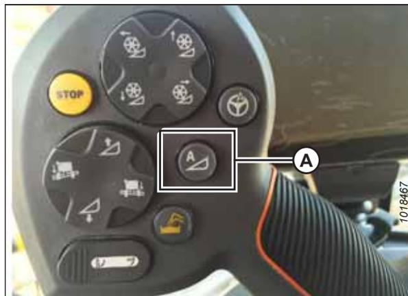
Figure 3.521: CHAP sur la poignée de commande
