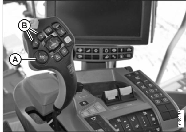
Figure 3.674: John Deere X9 – Levier multifonction
