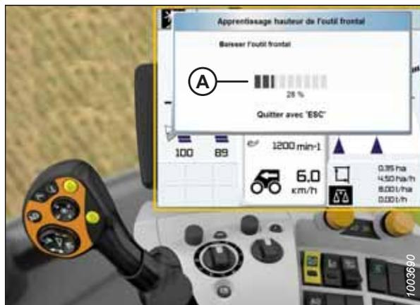
Figure 3.433: Écran, console et levier de commande de la moissonneuse-batteuse CLAAS
