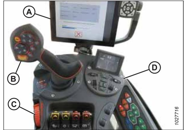
Figure 3.526: Poste de l'opérateur de la série IDEAL<sup>MC</sup>
