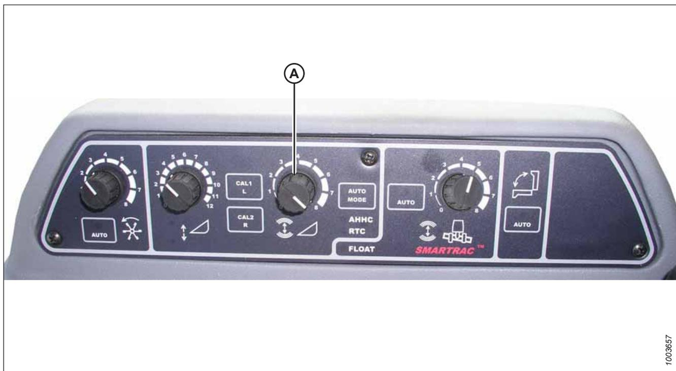
Figure 3.489: Console de contrôle de la hauteur automatique de la plateforme
