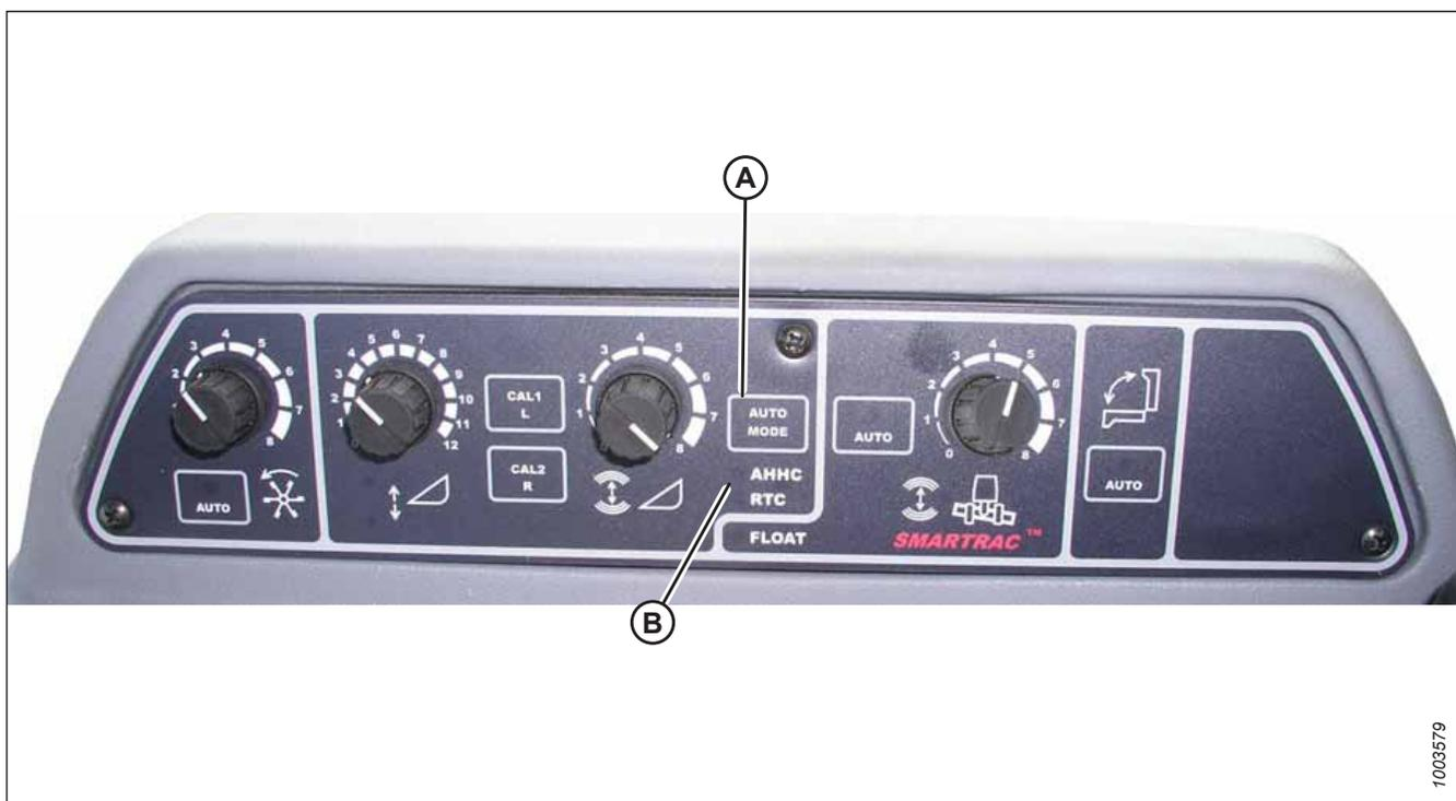
Figure 3.482: Commandes du système de réglage automatique de la hauteur de la plateforme de la moissonneuse-batteuse
