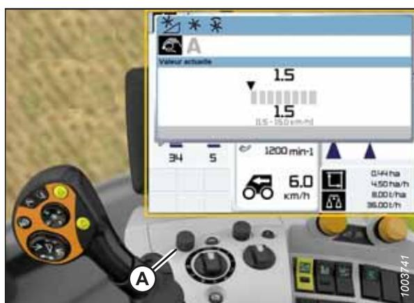
Figure 3.443: Écran, console et levier de commande de la moissonneuse-batteuse CLAAS
