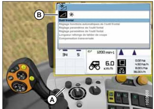
Figure 3.430: Écran, console et levier de commande de la moissonneuse-batteuse CLAAS
