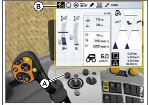
Figure 3.429: Écran, console et levier de commande de la moissonneuse-batteuse CLAAS
