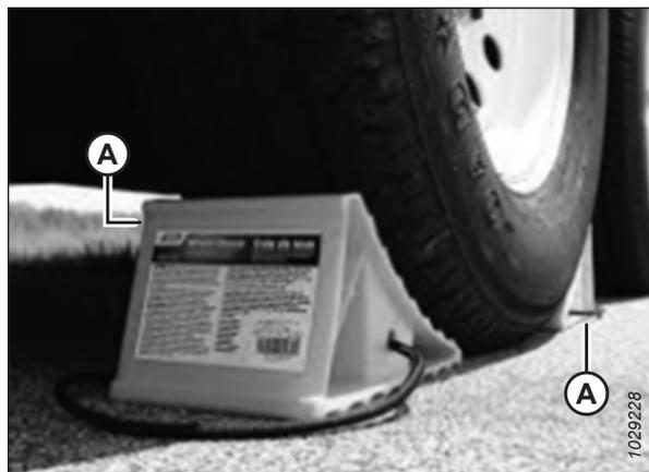
Figure 3.770: Blocage des pneus
