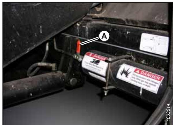
Figure 3.485: Commutateur ON/OFF (marche/arrêt) de l'accumulateur de la moissonneuse-batteuse
