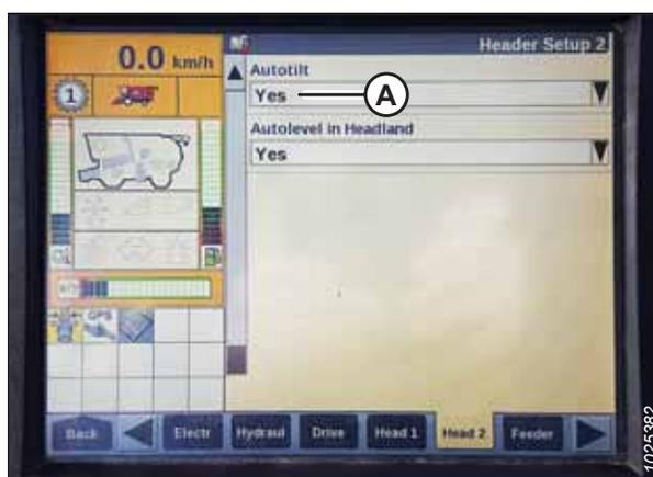
Figure 3.349: Afficheur de la moissonneuse-batteuse Case IH
