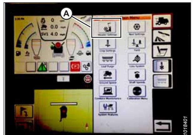
Figure 3.494: Paramètres de la plateforme dans le menu principal de la moissonneuse-batteuse
