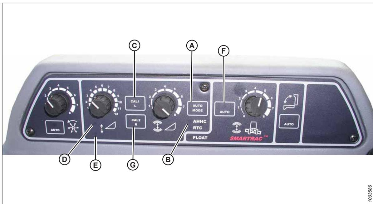
Figure 3.484: Commandes du système de réglage automatique de la hauteur de la plateforme de la moissonneuse-batteuse
