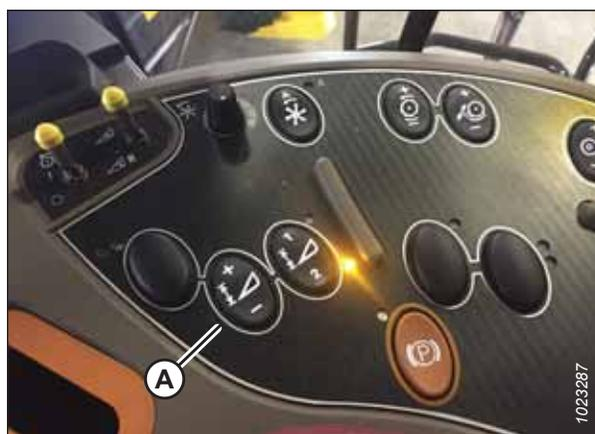
Figure 3.357: Console de la moissonneuse-batteuse Case
