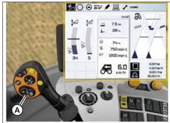
Figure 3.436: Écran, console et levier de commande de la moissonneuse-batteuse CLAAS
