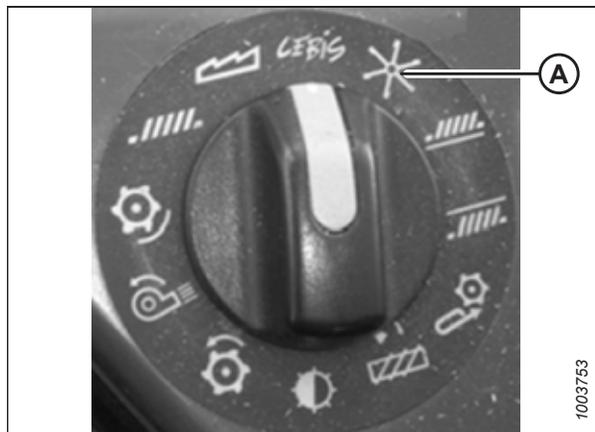
Figure 3.423: Sélecteur rotatif de la moissonneuse-batteuse CLAAS
