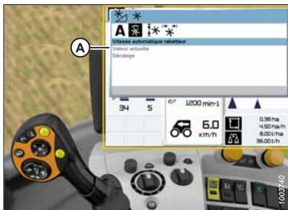
Figure 3.442: Écran, console et levier de commande de la moissonneuse-batteuse CLAAS
