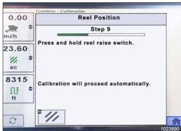
Figure 3.616: Affichage des moissonneuses-batteuses John Deere
