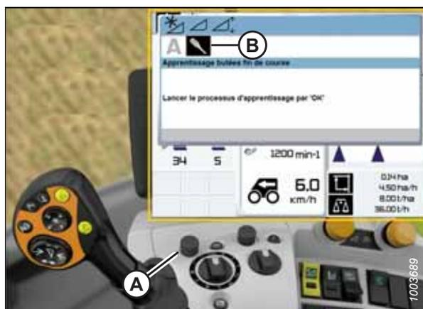
Figure 3.447: Écran, console et levier de commande de la moissonneuse-batteuse CLAAS
