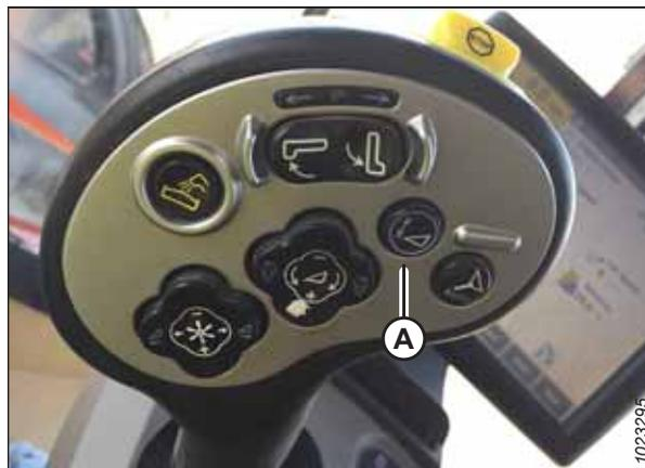
Figure 3.355: Poignée de commande de la moissonneuse-batteuse Case
