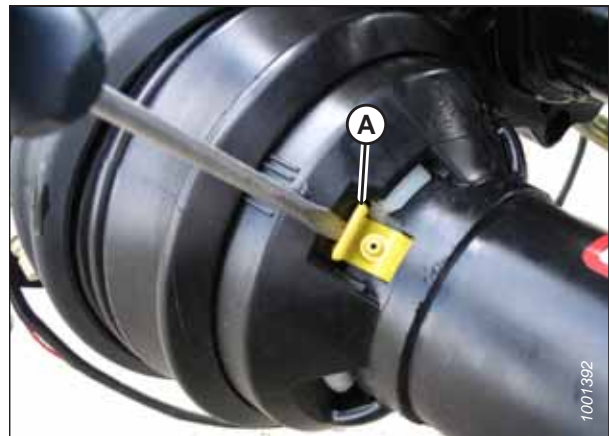
Figura 4.52: Proteção do eixo de transmissão
