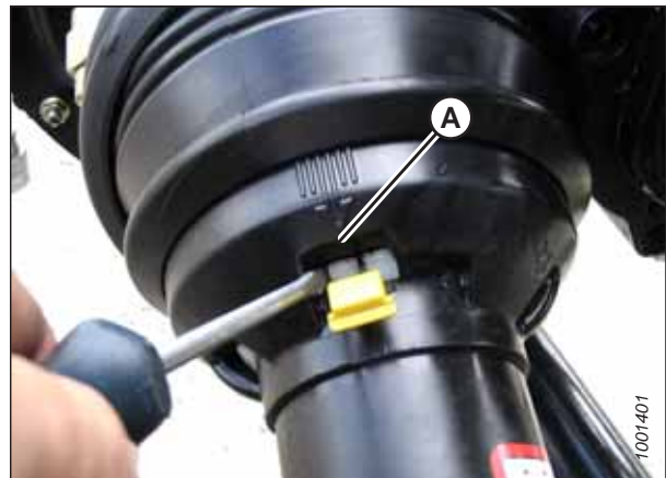
Figura 4.56: Proteção do eixo de transmissão
