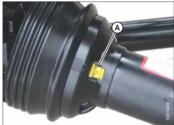
Figura 4.57: Proteção do eixo de transmissão
