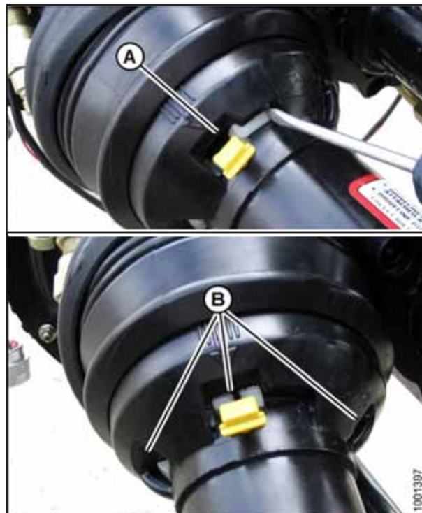
Figura 4.53: Proteção do eixo de transmissão
