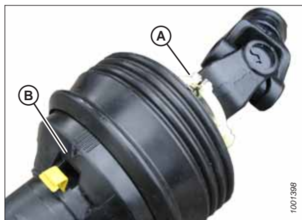
Figura 4.54: Proteção do eixo de transmissão
