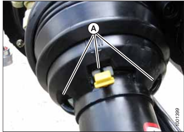
Figura 4.55: Proteção do eixo de transmissão
