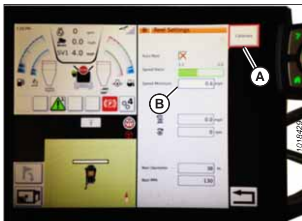
Figura 3.580: Calibração das configurações do molinete
