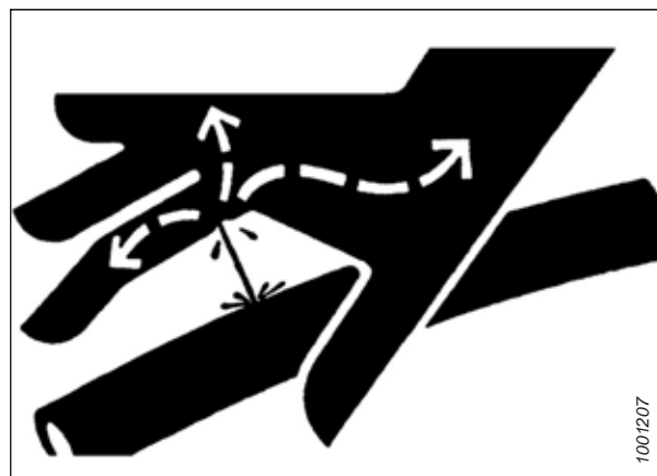
Figura 4.1: Perigo da pressão hidráulica
