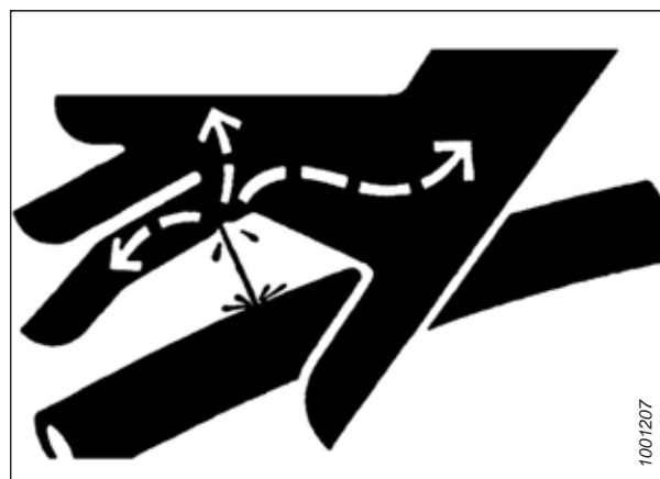
Figura 1.12: Perigo da pressão hidráulica
