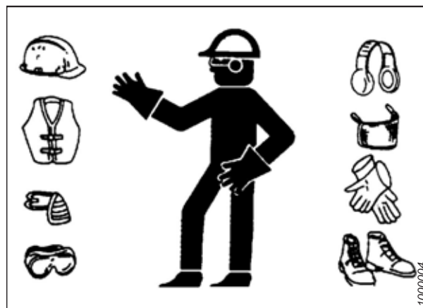
Figura 1.2: Equipamento de segurança
