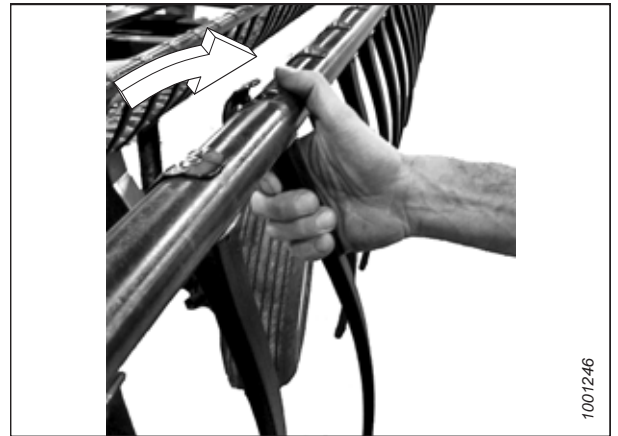
Figura 4.296: Instalação do dedo de plástico
