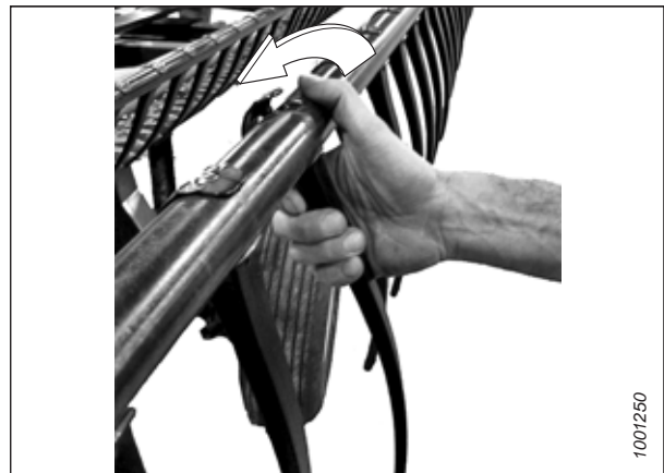
Figura 4.295: Remoção do dedo de plástico
