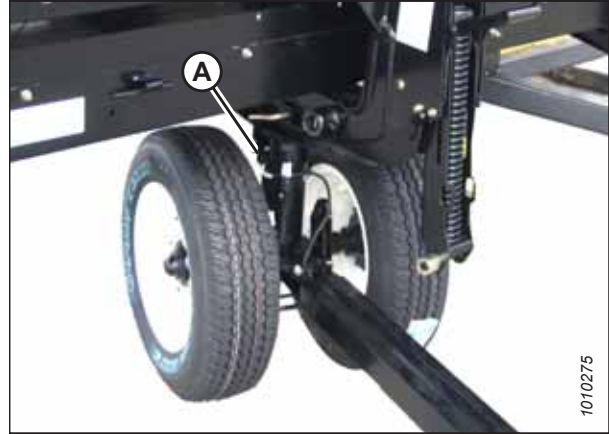
Рисунок 3.114: Соединение жгута проводов
