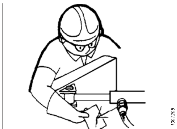
Рисунок 5.4: Проверка наличия гидравлических течей
