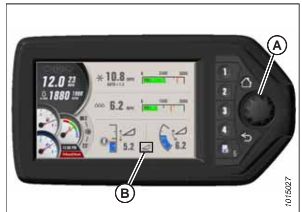
Figur 4.163: Kørselsskærm på HPT
