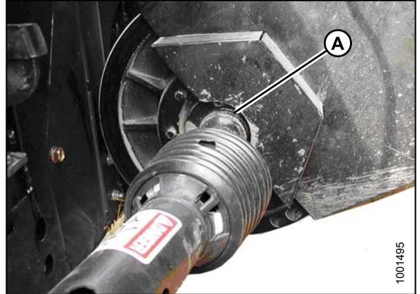
Figure 5.94: Détachez la transmission d'entrée
