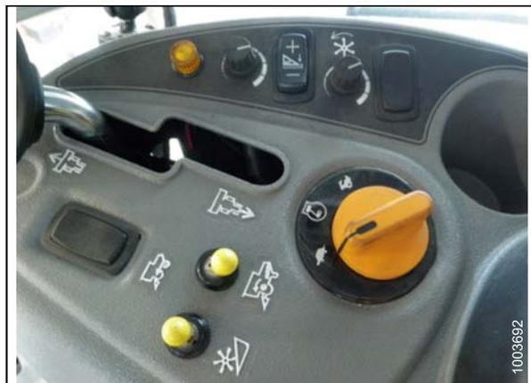
**Figure 4.51: Bouton de réglage de la hauteur sur la console de commande de la moissonneuse-batteuse**
