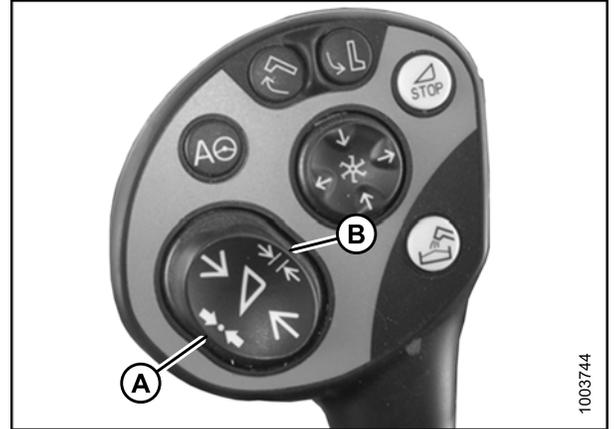
Figure 4.152: Activer le système de contour automatique et les réglages de la hauteur de coupe prédéfinie
