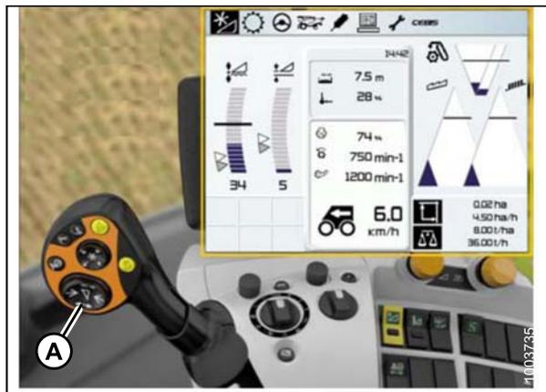
Figure 4.173: Écran de la moissonneuse-batteuse, console et levier de propulsion
