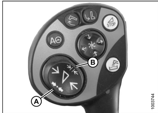
Figure 4.162: Appuyez sur le bouton A ou B pour enregistrer les réglages
