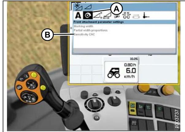
Figure 4.175: Écran de la moissonneuse-batteuse, console et levier de propulsion
