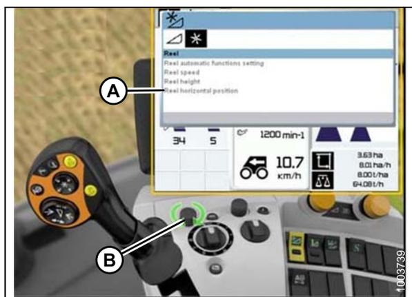
Figure 4.178: Écran de la moissonneuse-batteuse, console et levier de propulsion
