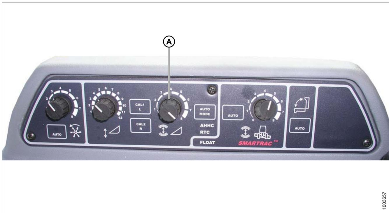
Figure 4.94: Console de contrôle de la hauteur automatique de la plateforme
