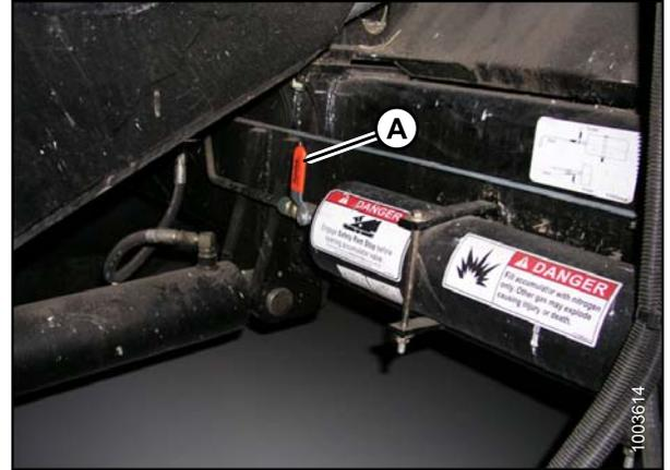
**Figure 4.90: Interrupteur marche/arrêt de l'accumulateur de la moissonneuse-batteuse**
