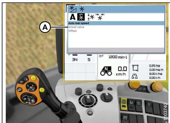
Figure 4.179: Écran de la moissonneuse-batteuse, console et levier de propulsion
