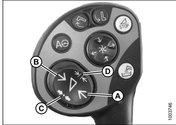
Figure 4.155: Régler manuellement la hauteur de coupe
