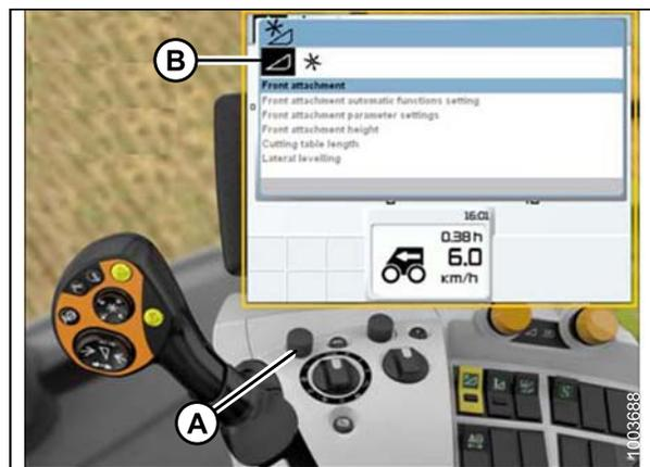
Figure 4.168: Écran de la moissonneuse-batteuse, console et levier de propulsion
