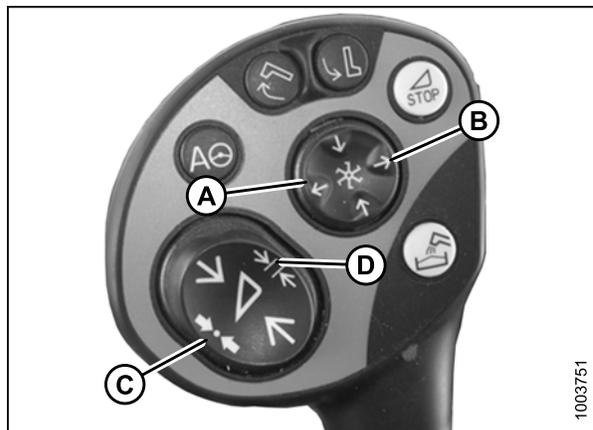
Figure 4.166: Réglez et enregistrez la position avant-arrière du rabatteur
