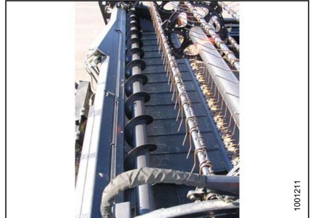
Figure 4.254: Vis transversale supérieure
