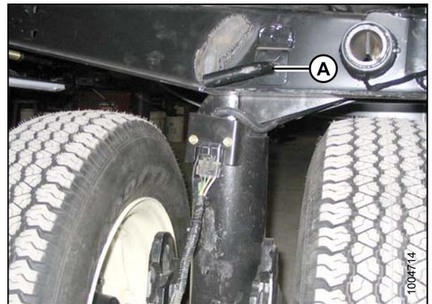
Figure 4.274: Verrouillage des roues
