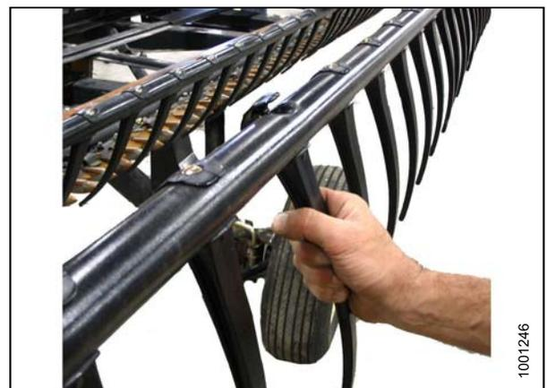
Figure 6.260: Installation des doigts
