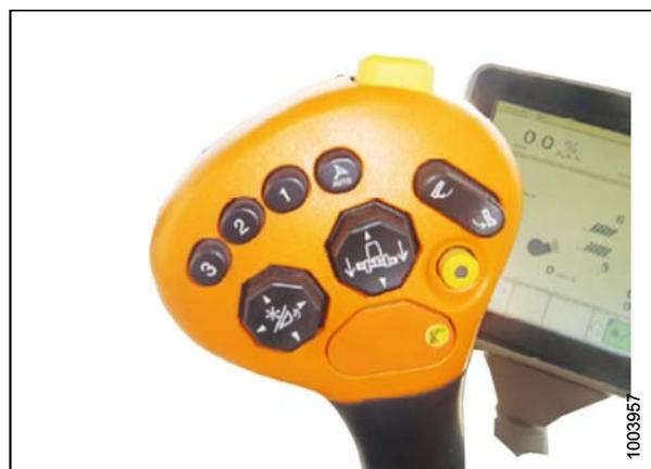
Figure 4.145: Utilisez le levier de commande pour définir les pré-réglages de la pression au sol.
