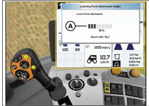
Figure 4.171: Écran de la moissonneuse-batteuse, console et levier de propulsion
