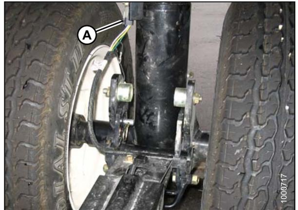
**Figure 4.287: Connexion du faisceau**
