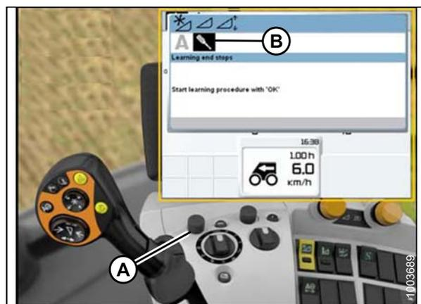
Figure 4.170: Écran de la moissonneuse-batteuse, console et levier de propulsion
