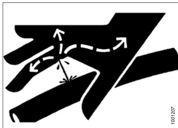
Figure 6.2: Risque lié à la pression hydraulique
