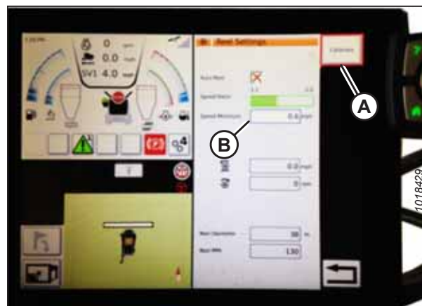
Figure 4.153: Étalonnage des réglages du rabatteur
