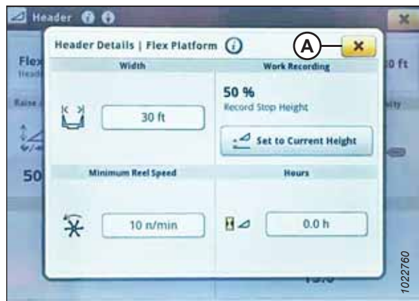
Figure 4.282: Écran John Deere S7 – Boîte de dialogue Header Details (détails de la plateforme)
