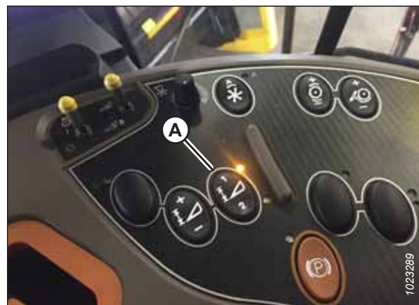
Figure 4.33: Console de la moissonneuse-batteuse Case IH
