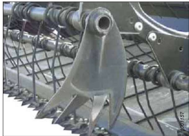
Figure 7.3: Griffes de rabatteur pour récolte couchée
