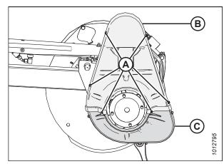
Figure 5.228: Capot d'entraînement – Rabatteur double
