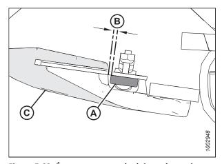
Figure 5.69: Écartement entre le doigt et la partie avant de la barre de couteau
