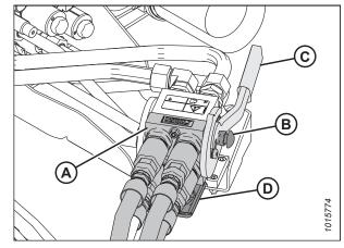
Figure 4.10: Multicoupleur d'entraînement des couteaux/du rabatteur
