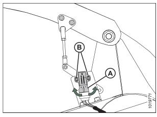
Figure 5.22: Capteur de hauteur du rabatteur – bras droit du rabatteur avec rabatteur en haut
