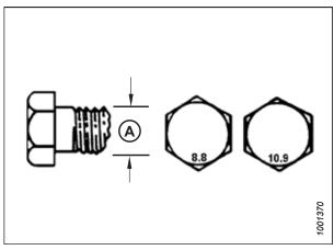
Figure 8.7: Grades des boulons
