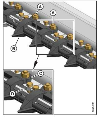
Figure 5.41: Doigt de lamier d'embout
