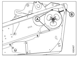
Figure 5.81: Entraînement de couteau double non synchronisé
