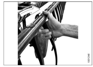
Figure 5.179: Installation des doigts en plastique
