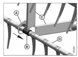
Figure 5.208: Support opposé du kit de renforcement des tubes à doigts en option
