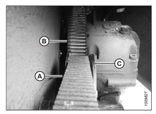
Figure 5.111: Courroie d'entraînement du couteau
