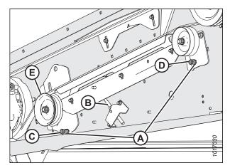
Figure 5.113: Entraînement de couteau – côté gauche
