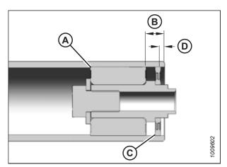
Figure 5.154: Roulement de rouleau d'entraînement
