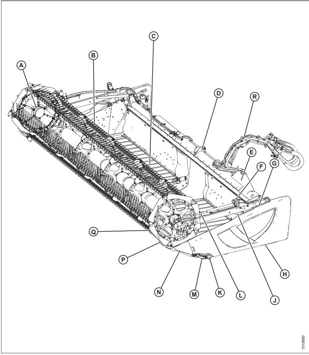
Figure 2.1: Composants de la plateforme d'andaineuse
