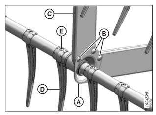
Figure 5.212: Support opposé du kit de renforcement des tubes à doigts en option
