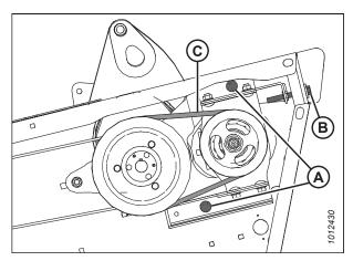
Figure 5.95: Courroies trapézoïdales de couteau
