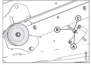
Figure 5.67: Entraînement synchronisé du couteau double
