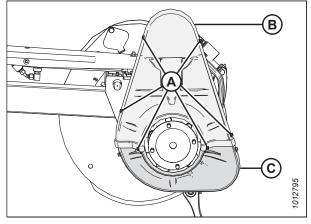
Figure 5.224: Capot d'entraînement – Rabatteur double
