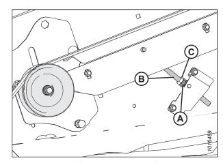
Figure 5.91: Entraînement synchronisé du couteau double
