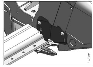
Figure 6.8: Couvercle de découpe des couteaux
