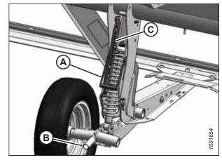
Figure 3.23: Roue stabilisatrice
