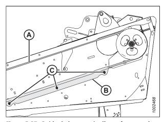
Figure 5.87: Guide de la courroie d'entraînement de couteau
