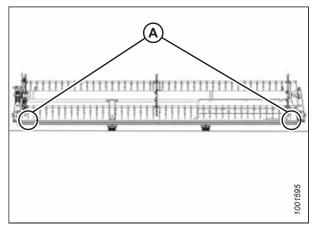
Figure 5.166: Emplacements des mesures du dégagement du rabatteur – Plateforme à rabatteur unique
