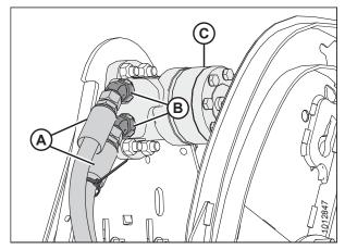
Figure 5.247: Moteur et flexibles du rabatteur
