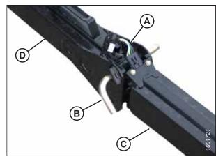
Figure 3.58: Assemblage de la barre de remorquage
