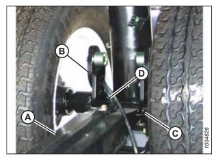
Figure 3.88: Fixation de la barre de remorquage
