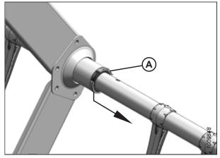
Figure 5.192: Colliers des bagues du kit de renforcement des tubes à doigts – en option
