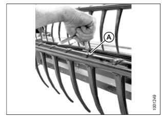
Figure 5.180: Installation des doigts en plastique
