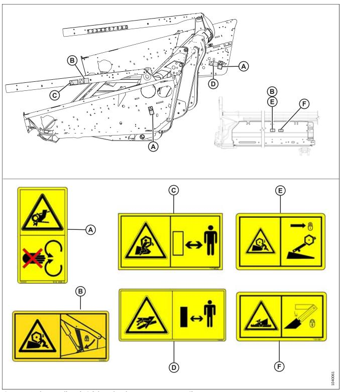
Figure 1.18: Plateaux d'extrémité, bras de rabatteur et panneau arrière
