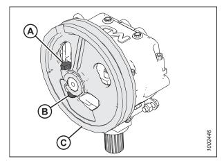
Figure 5.59: Boîtier d'entraînement du couteau et poulie
