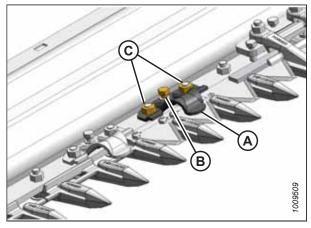
Figure 5.42: Mécanisme de retenue du doigt standard
