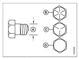
Figure 8.1: Grades des boulons
