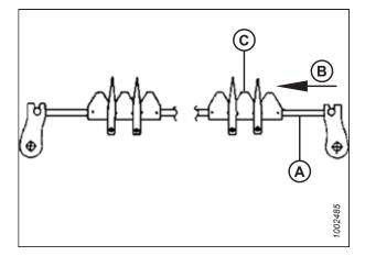
Figure 5.105: Réglage de la synchronisation – côté droit
