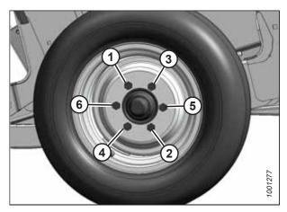
Figure 5.256: Séquence de serrage des boulons
