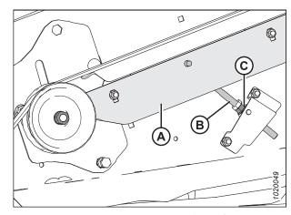
Figure 5.100: Guide de la courroie d'entraînement de couteau gauche
