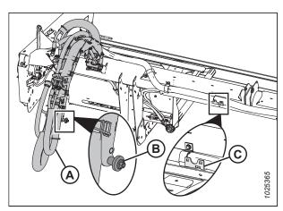
Figure 4.14: Système de gestion des flexibles hydrauliques – Plateforme D115X
