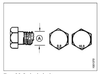
Figure 8.9: Grades des boulons
