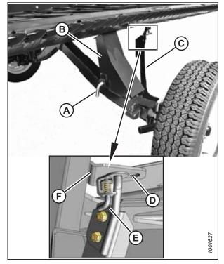
Figure 3.82: Position de la roue arrière droite
