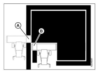
Figure 3.55: Distribution de la récolte à l'extrémité gauche et droite
