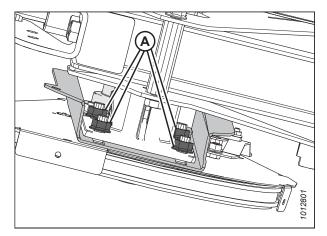
Figure 5.230: Entraînement de rabatteur simple – Vue du dessous du rabatteur
