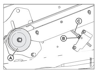
Figure 5.108: Entraînement du couteau – Côté gauche, opposé au côté droit
