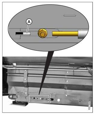
Figure 5.122: Réglage de la tension du tapis gauche
