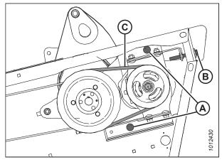
Figure 5.92: Courroies trapézoïdales de couteau
