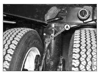
Figure 3.59: Connecteur de câblage
