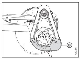
Figure 5.225: Capot d'entraînement inférieur
