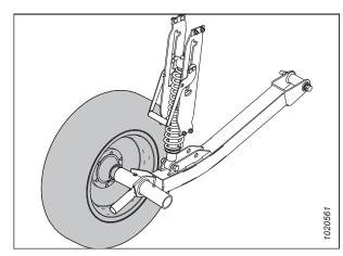
Figure 6.14: Roue stabilisatrice secondaire
