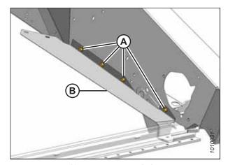
Figure 5.160: Déflecteur avant - côté gauche
