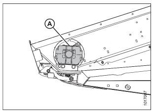
Figure 5.48: Illustration du boîtier d'entraînement de couteaux côté gauche – similaire du côté droit
