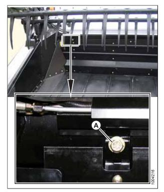
Figure 3.52: Décalage manuel du tablier
