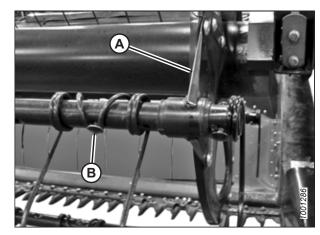
Figure 5.176: Tube à doigts
