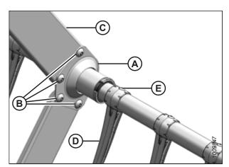
Figure 5.211: Support du kit de renforcement des tubes à doigts en option
