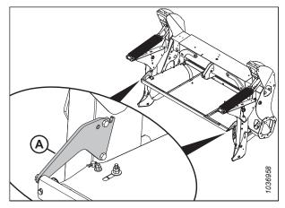
Figure 4.1: Plaques de montage du blindage sur le blindage de formage
