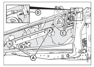
Figure 5.114: Entraînement de couteau - côté gauche
