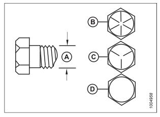
Figure 8.4: Grades des boulons
