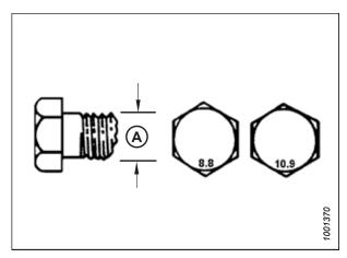
Figure 8.5: Grades des boulons
