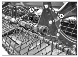
Figure 5.175: Bras du tube à doigts
