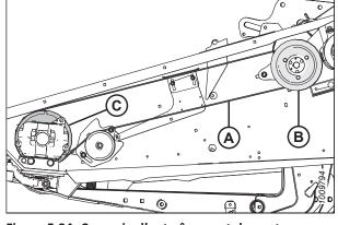
Figure 5.94: Courroie d'entraînement de couteau synchronisé Plateforme D1X – Illustrée à gauche
