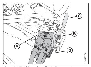
Figure 4.7: Multicoupleur d'entraînement des couteaux/du rabatteur
