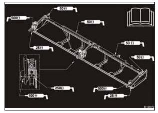
Figure 5.6: Autocollant de l'emplacement du point de graissage
