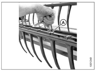
Figure 5.177: Retrait des doigts en plastique
