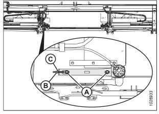
Figure 5.127: Rouleau d'entraînement du tablier gauche – côté droit opposé
