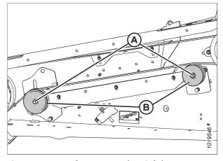
Figure 5.66: Entraînement synchronisé du couteau double
