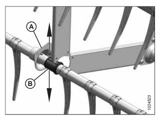
Figure 5.194: Support opposé du kit de renforcement des tubes à doigts – en option
