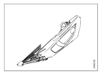
Figure 6.12: Diviseur de récolte flottant – Attaché à la tôle d'extrémité de la plateforme avec le châssis retiré pour plus de clarté
