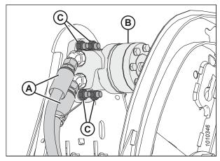
Figure 5.244: Moteur et flexibles du rabatteur
