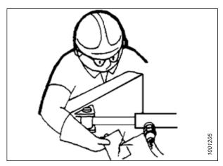
Figure 5.4: Test de fuites hydrauliques
