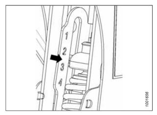
Figure 3.24: Indicateur de charge
