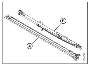
Figure 3.85: Assemblage de la barre de remorquage
