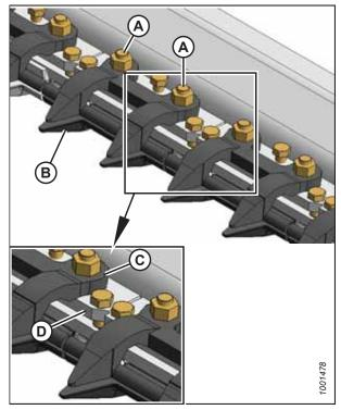
Figure 5.39: Doigt de lamier d'embout
