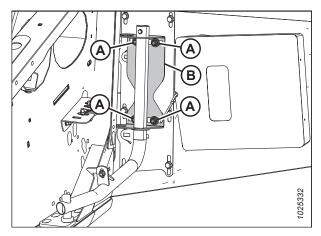
Figure 3.17: Tuyau de support du capot du diviseur gauche sur la plateforme série D1X
