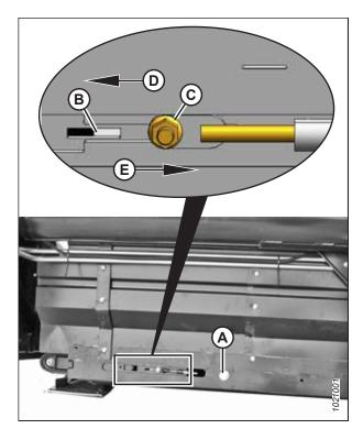
Figure 5.125: Dispositif de réglage de la tension à gauche
