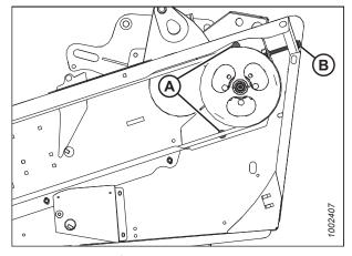
Figure 5.52: Entraînement de couteau double non synchronisé
