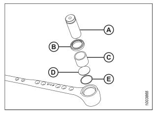
Figure 5.27: Assemblage du roulement de la tête de couteau
