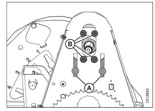
Figure 5.245: Trous de fixation du moteur d'entraînement du rabatteur
