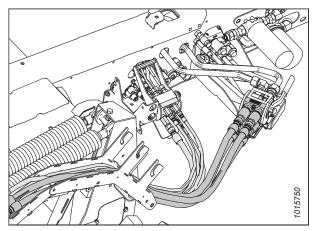
Figure 4.9: Multicoupleurs hydrauliques et déplacement des flexibles
