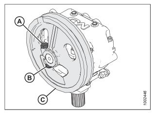
Figure 5.57: Boîtier d'entraînement du couteau et poulie
