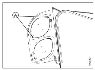
Figure 5.19: Option de transport à vitesse lente – Feux rouge et orange
