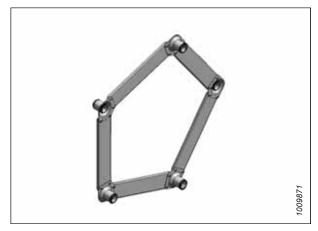
Figure 6.5: Kit de renforcement des rabatteurs à cinq lames représenté – similaire au kit renforcement des rabatteurs à six lames
