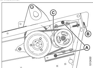
Figure 5.89: Courroies trapézoïdales de couteau
