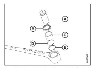
Figure 5.28: Assemblage du roulement de la tête de couteau
