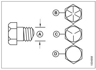
Figure 8.2: Grades des boulons
