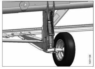
Figure 6.13: Roue stabilisatrice
