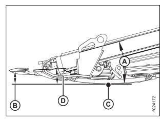
Figure 3.28: Angle de la plateforme
