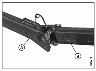
Figure 3.86: Assemblage de la barre de remorquage
