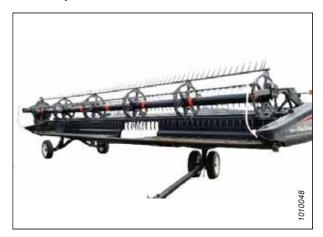
Figure 6.15: Roues stabilisatrices et transport
