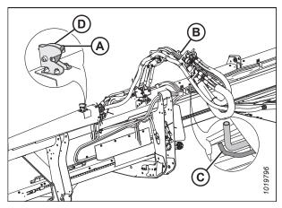
Figure 4.13: Système de gestion des flexibles hydrauliques – Toutes les plateformes sauf D115X
