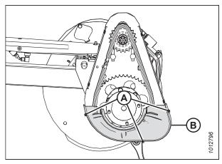
Figure 5.227: Capot d'entraînement inférieur – Rabatteur double
