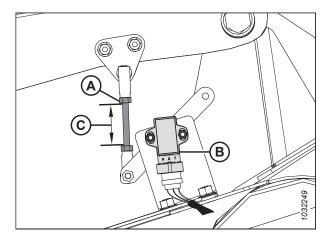
Figure 5.21: Capteur de hauteur du rabatteur – bras droit du rabatteur avec rabatteur en bas
