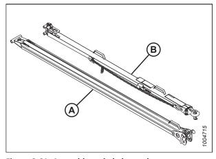
Figure 3.61: Assemblage de la barre de remorquage
