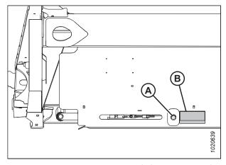
Figure 5.158: Tension du tapis - Côté gauche illustré
