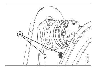
Figure 5.232: Entraînement de rabatteur simple – similaire au rabatteur double
