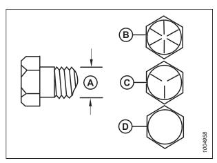
Figure 8.3: Grades des boulons
