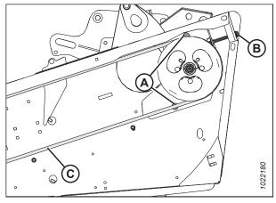
Figure 5.86: Moteur d'entraînement des couteaux et dispositif de réglage
