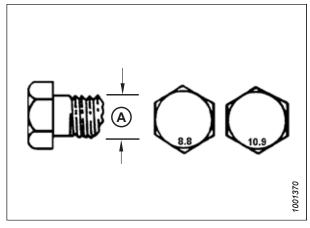
Figure 8.8: Grades des boulons
