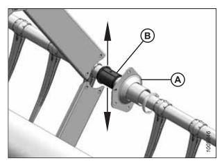
Figure 5.193: Support du kit de renforcement des tubes à doigts – en option
