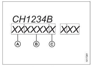
Figure 5.16: Identification des fils – Emplacement, numéro d'identification, emplacement du branchement
