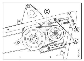
Figure 5.88: Courroies trapézoïdales de couteau
