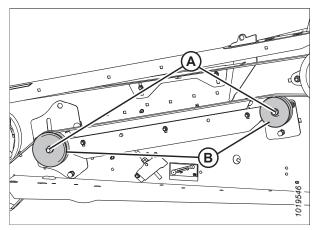
Figure 5.50: Entraînement synchronisé du couteau double
