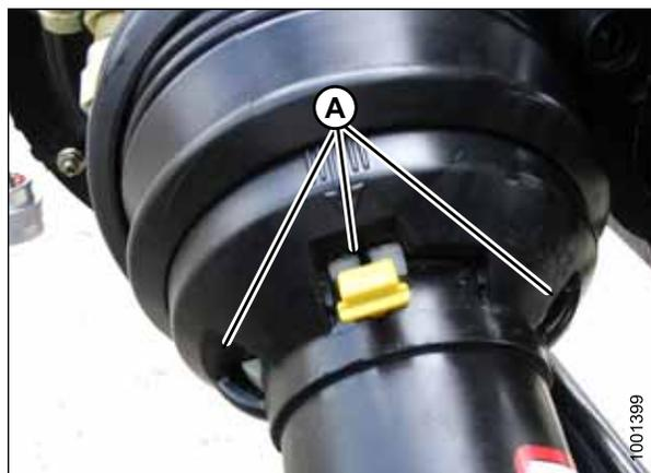
Рисунок 5.44: Защитный кожух кардана привода жатки
