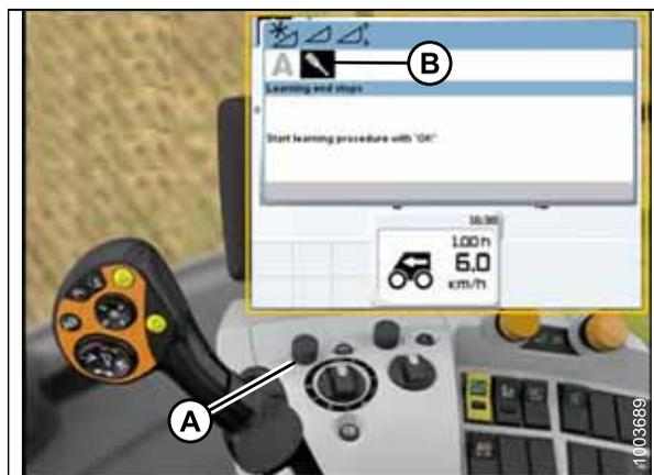
Рисунок 3.326: Приборная панель, консоль и рычаг управления комбайна
