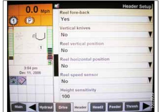
Рисунок 3.171: Приборная панель комбайна Case IH
