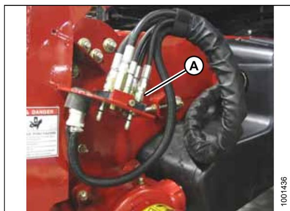
Рисунок 4.52: Разъемы комбайна
