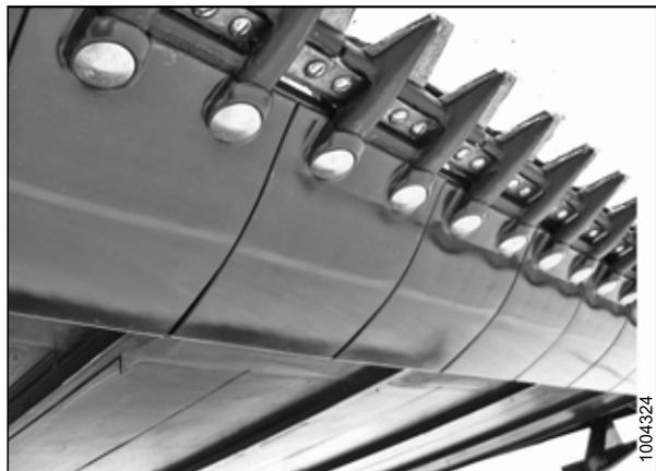
Рисунок 6.7: Износные пластины ножевого бруса
