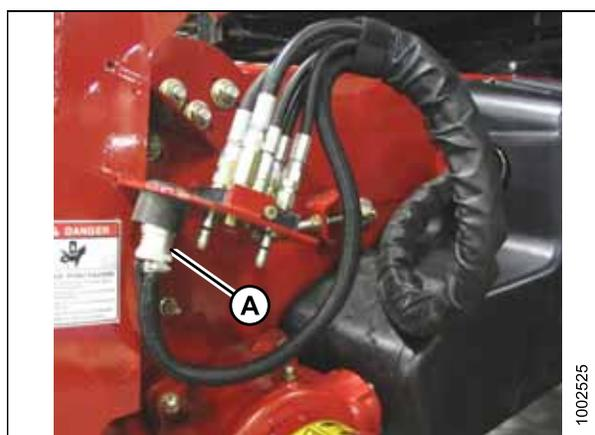
Рисунок 4.55: Разъемы комбайна
