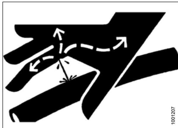
Рисунок 5.2: Опасное давление гидравлической жидкости
