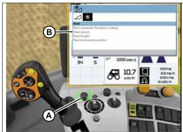
Рисунок 3.334: Приборная панель, консоль и рычаг управления комбайна
