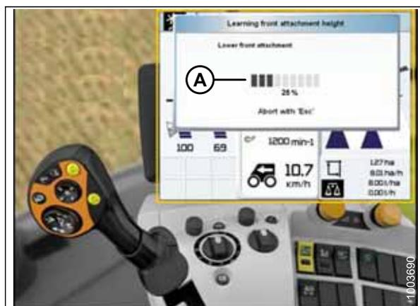
Рисунок 3.327: Приборная панель, консоль и рычаг управления комбайна
