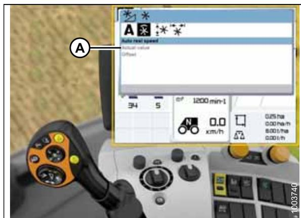
Рисунок 3.335: Приборная панель, консоль и рычаг управления комбайна
