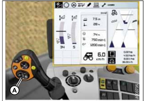
Рисунок 3.329: Приборная панель, консоль и рычаг управления комбайна
