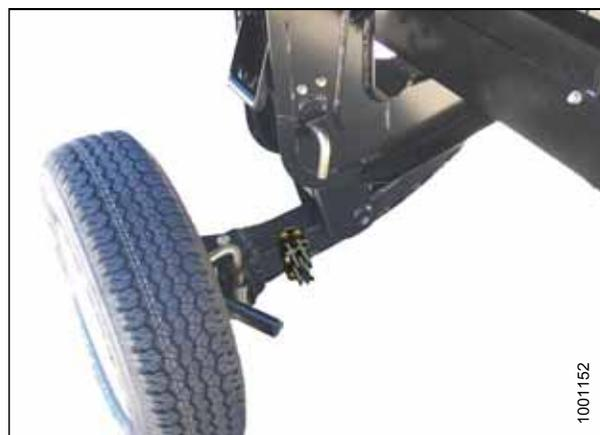
Рисунок 3.410: Левое колесо в транспортном положении
