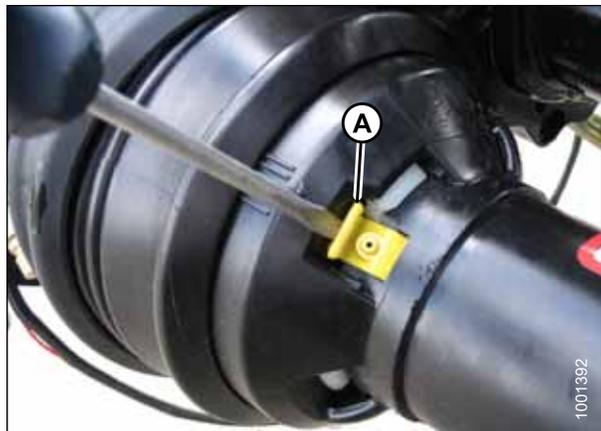
Рисунок 5.41: Защитный кожух кардана привода жатки
