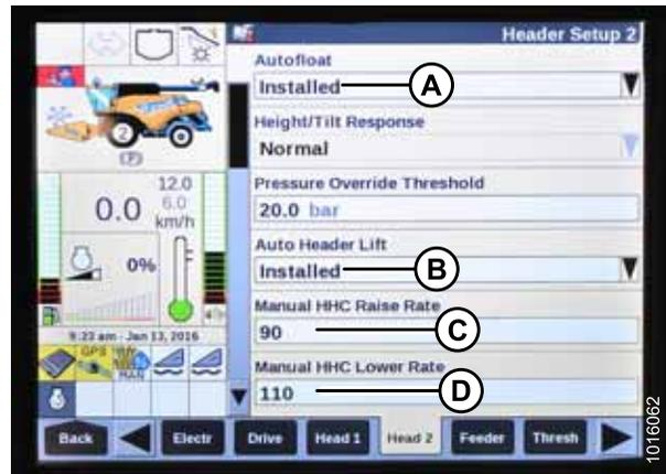
Рисунок 3.366: Приборная панель комбайнов New Holland
