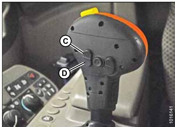
Рисунок 3.296: Ручка гидравлического управления John Deere
