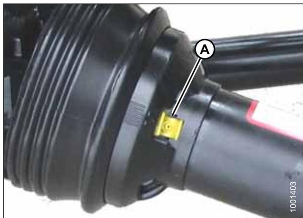
Рисунок 5.46: Защитный кожух кардана привода жатки
