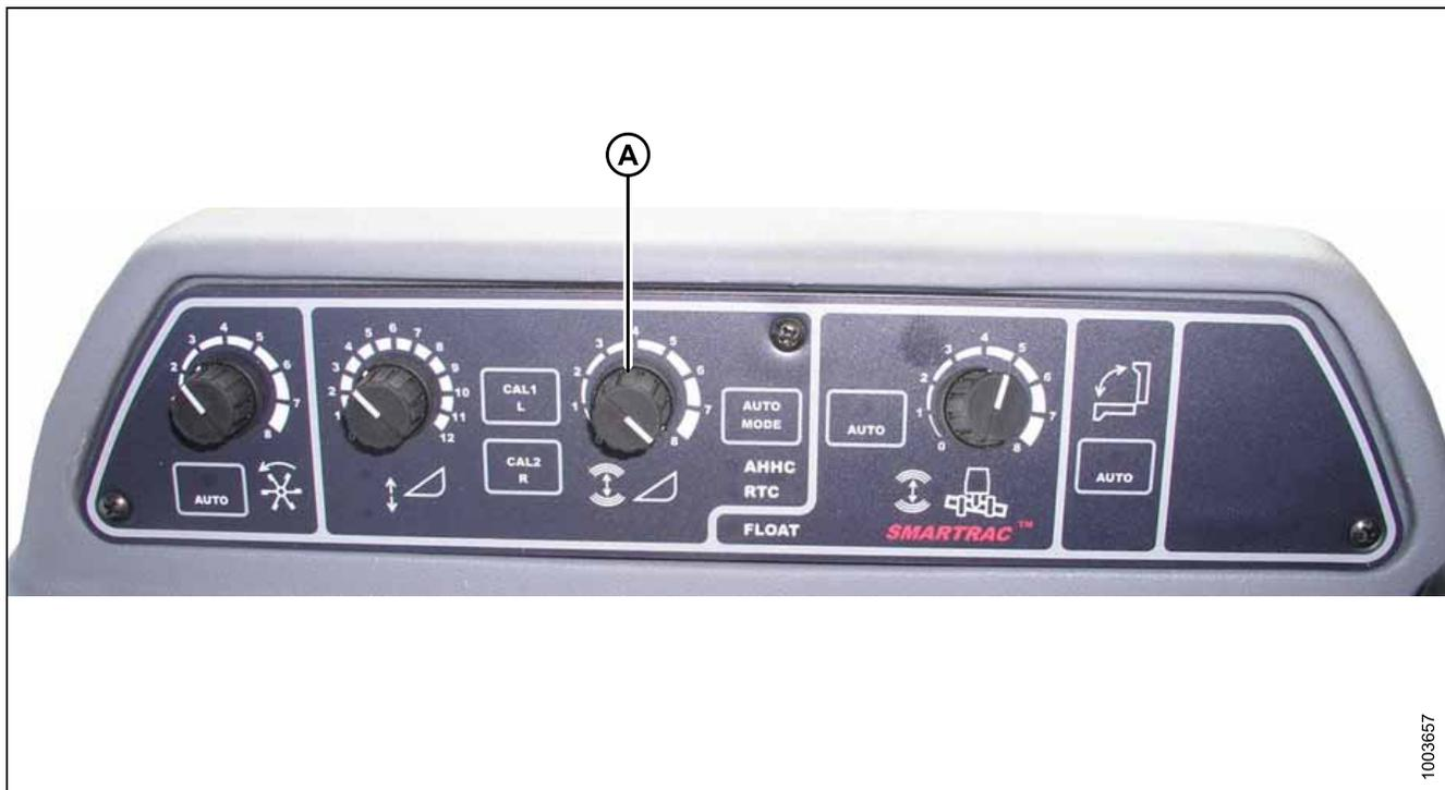
Шкала РЕГУЛИРОВКИ ЧУВСТВИТЕЛЬНОСТИ (А) определяет, какое расстояние должен пройти ножевой брус жатки вверх или вниз до срабатывания системы автоматического контроля высоты жатки (АННС) и подъема или опускания наклонной камеры.
