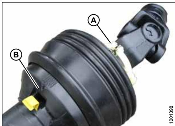
Рисунок 5.43: Защитный кожух кардана привода жатки
