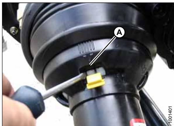
Рисунок 5.45: Защитный кожух кардана привода жатки
