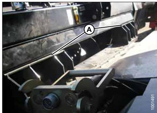
Рисунок 4.70: Наклонная камера и модуль флотации
