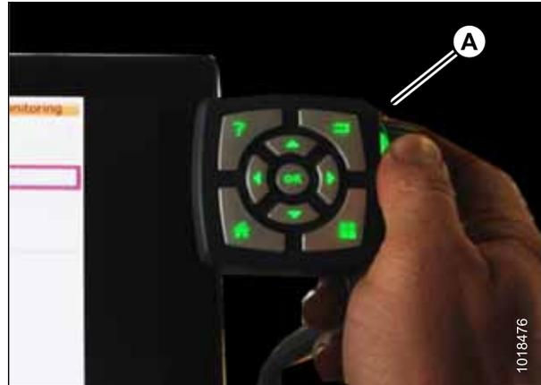
Рисунок 3.244: Колесо прокрутки для регулировок
