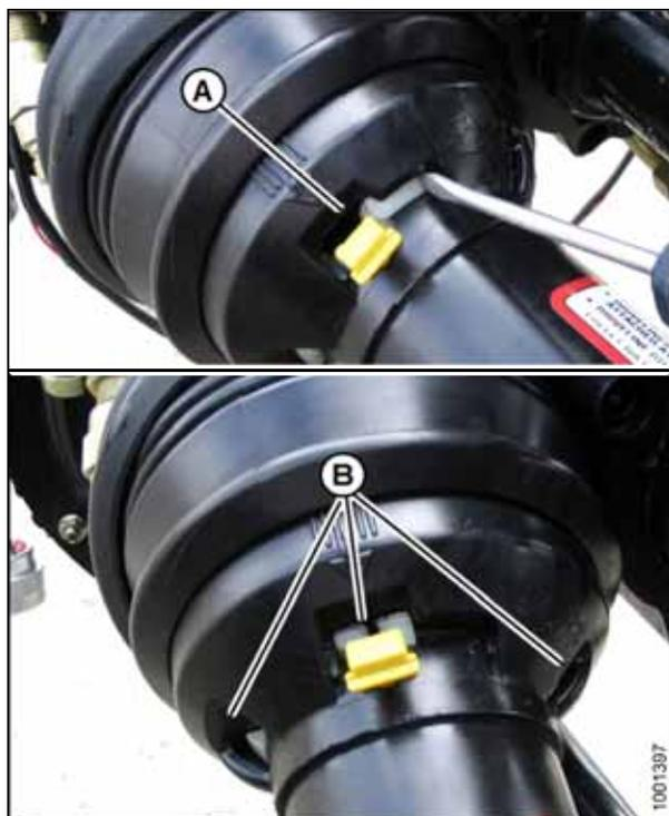
Рисунок 5.42: Защитный кожух кардана привода жатки
