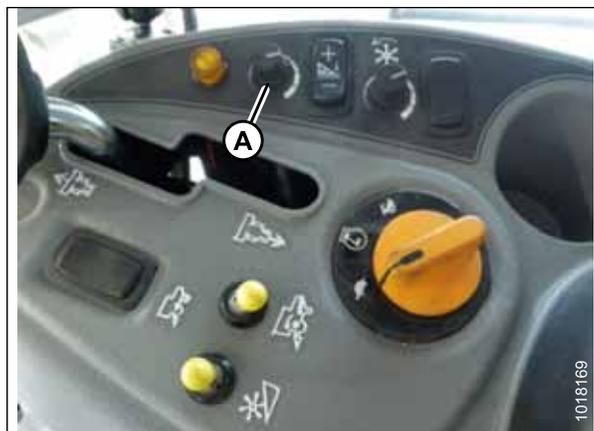
Рисунок 3.193: Ручка регулировки высоты на консоли управления комбайна
