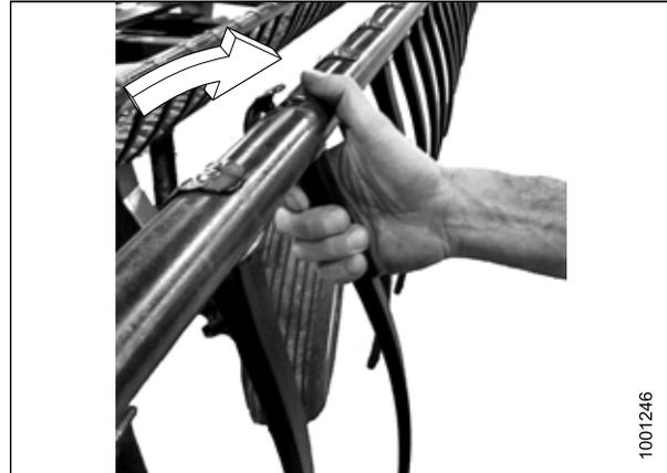
Рисунок 5.229: Установка пластмассового пальца
