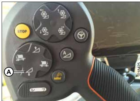
Рисунок 3.233: Кнопка опускания жатки
