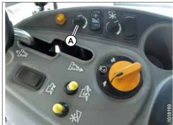
Rysunek 3.290: Pokrętło regulacji wysokości na konsoli sterowania kombajnu
