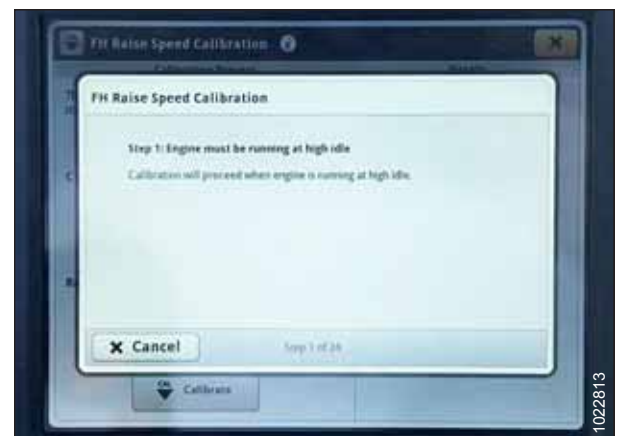
Rysunek 3.508: Wyświetlacz kombajnu John Deere S7 — kalibracja przenośnika pochyłego
