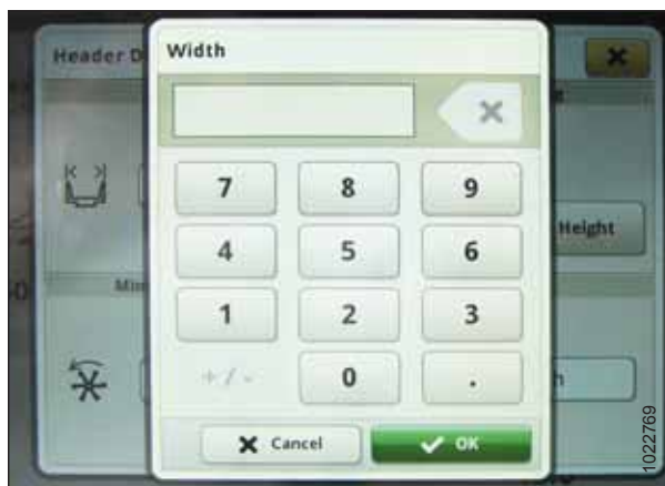
Rysunek 3.490: Wyświetlacz kombajnu John Deere S7 — ustawianie szerokości hedera
