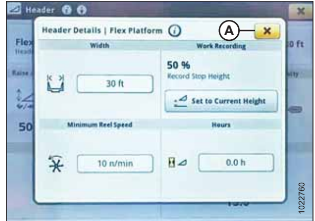
Rysunek 3.491: Wyświetlacz kombajnu John Deere S7 — okno dialogowe Header Details (Szczegóły hedera)
