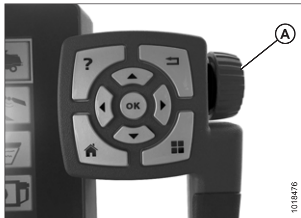
Rysunek 3.411: Pokrętko regulacyjne po prawej stronie terminala Tyton
