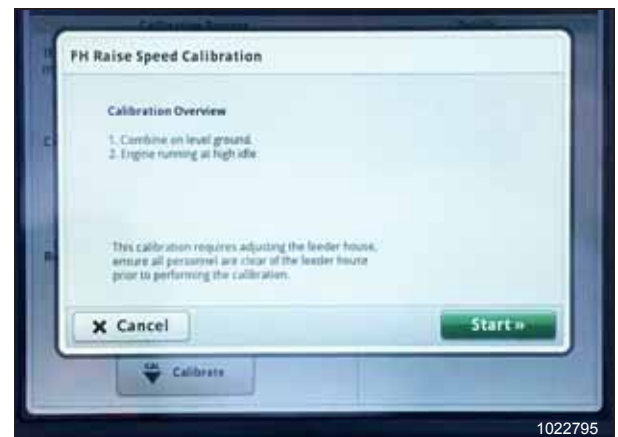
Rysunek 3.507: Wyświetlacz kombajnu John Deere S7 — kalibracja przenośnika pochyłego
