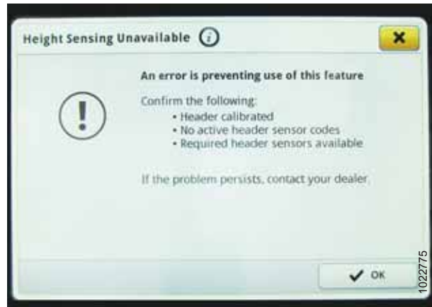
Rysunek 3.496: Wyświetlacz kombajnu John Deere S7 — komunikat o błędzie wykrywania wysokości
