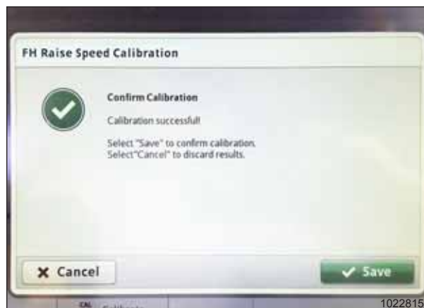
Rysunek 3.509: Wyświetlacz kombajnu John Deere S7 — kalibracja przenośnika pochyłego
