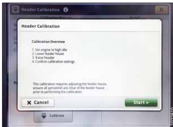
Rysunek 3.515: Wyświetlacz kombajnu John Deere S7 — kalibracja hedera
