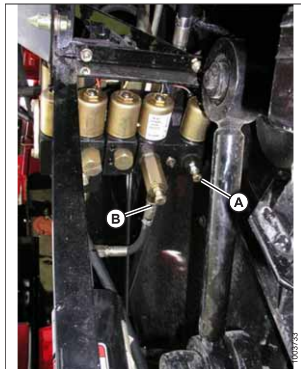
Rysunek 3.373: Regulowane ograniczniki podnoszenia i opuszczania hedera
