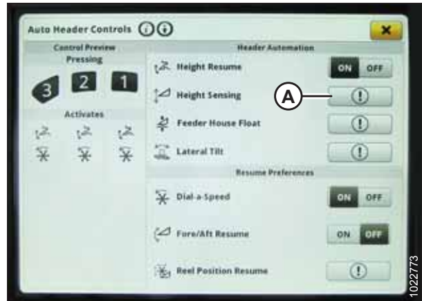
Rysunek 3.495: Wyświetlacz kombajnu John Deere S7 — elementy automatycznego sterowania hederem
