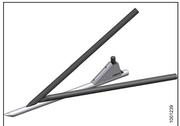
Рисунок 6.22: Делитель для скашивания риса
