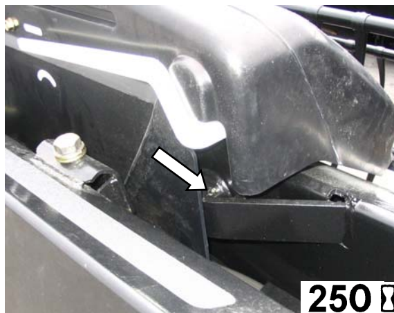
Гибкая сцепка (Только Гибкая жатка) Обе стороны
