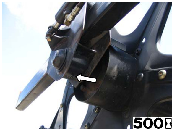
Левый подшипник (1 Место) Вала мотовила
