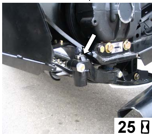
Головка ножа (Одинарный нож 1 место. 2 места двойной нож)
