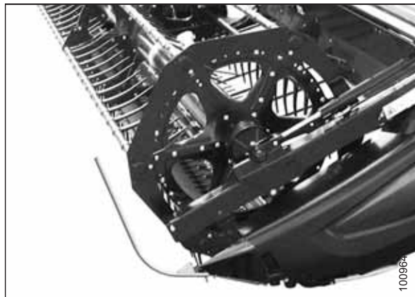
Рисунок 6.4: Боковые щитки мотовила
