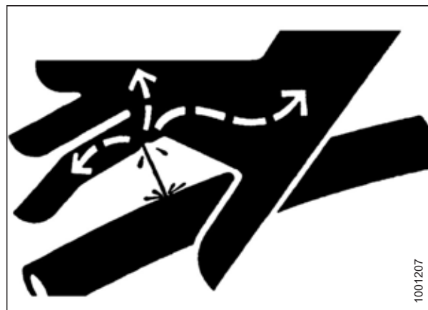
Рисунок 5.1: Опасное давление гидравлической жидкости
