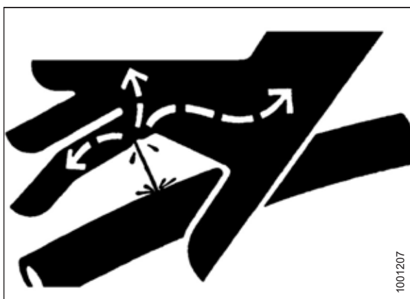
Рисунок 1.12: Опасное давление гидравлической жидкости
