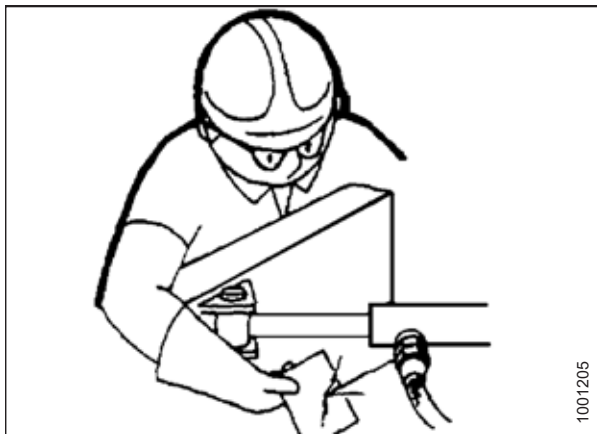
Рисунок 1.11: Проверка наличия гидравлических течей
