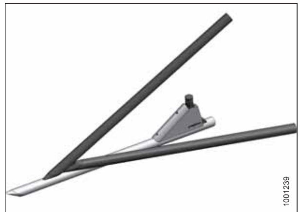
Рисунок 6.20: Делитель для скашивания риса
