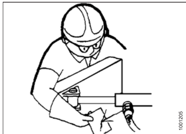
Рисунок 5.4: Проверка наличия гидравлических течей
