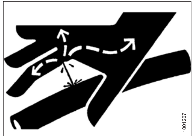
Рисунок 1.12: Опасное давление гидравлической жидкости
