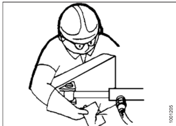
Рисунок 5.4: Проверка наличия гидравлических течей
