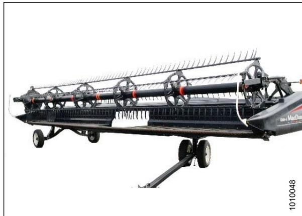
Рисунок 6.13: Опорно-транспортные колеса
