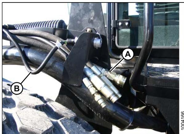
Рисунок 4.1: Шланги привода жатки
