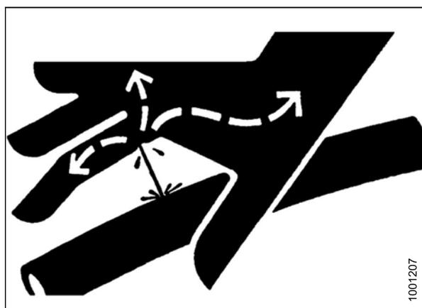
Рисунок 5.3: Опасное давление гидравлической жидкости
