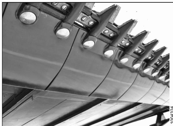
Рисунок 6.5: Противоизносные пластины ножевого бруса
