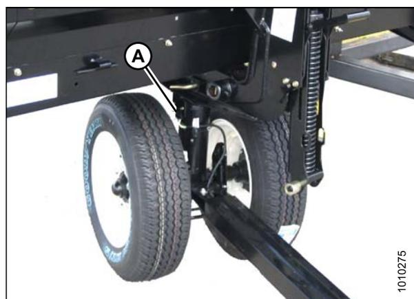
Рисунок 3.118: Соединение жгута проводов
