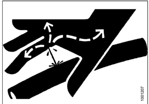
Рисунок 1.12: Опасное давление гидравлической жидкости
