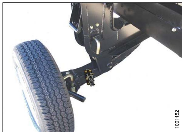
Рисунок 3.108: Левое колесо в транспортировочном положении
