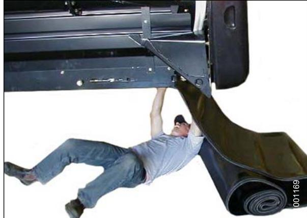
Рисунок 5.102: Установка полотна
