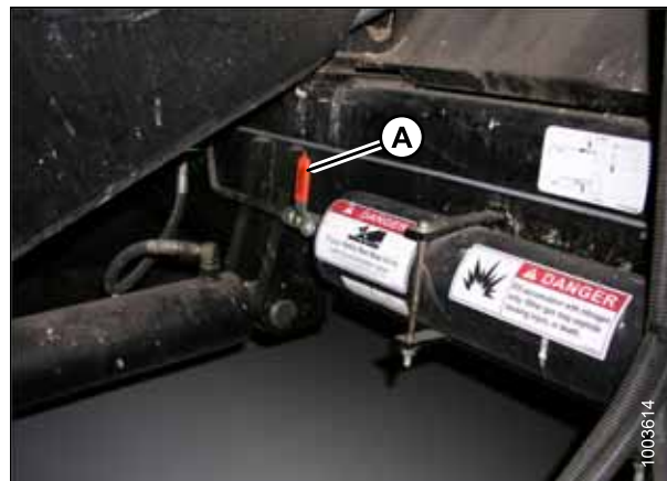
Рисунок 3.224: Выключатель гидроаккумулятора комбайна А — рычаг гидроаккумулятора (положение выключения)
