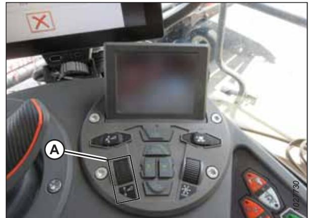
Figure 4.143: Groupe de commande de la plateforme
