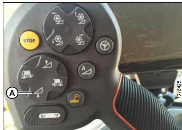
Figure 4.105: Commutateur d'abaissement de la plateforme
