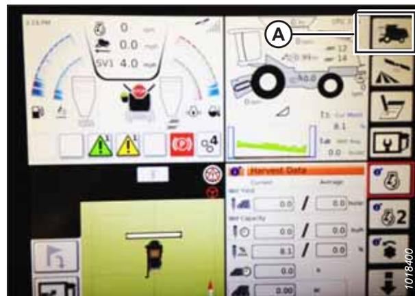
Figure 4.89: Icône moissonneuse-batteuse sur la page d'accueil
