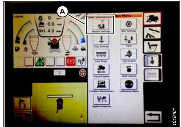
Figure 4.90: Paramètres de la plateforme dans le menu principal de la moissonneuse-batteuse
