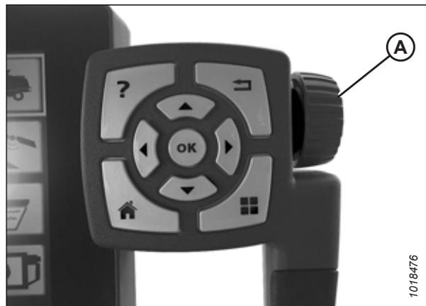
Figure 4.116: Molette de défilement pour les réglages
