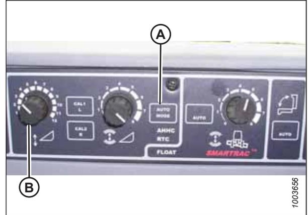
Figure 4.84: Console de contrôle de la hauteur automatique de la plateforme
