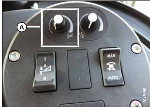
Figure 4.114: Groupe de commande de la plateforme
