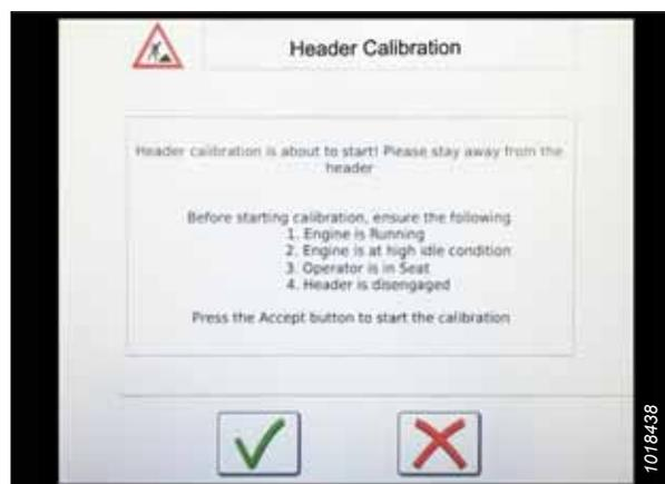
Figure 4.133: Avertissement d'étalonnage de la plateforme
