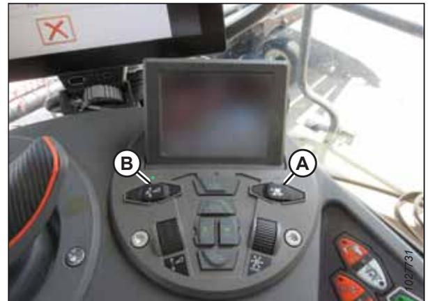
Figure 4.138: Groupe de commande de la plateforme
