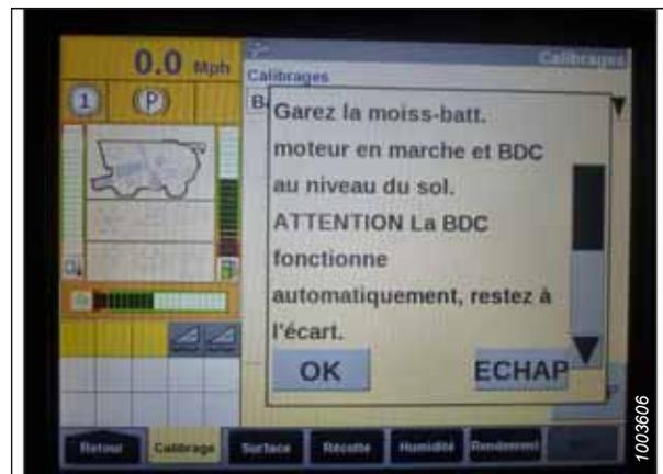
Figure 4.59: Afficheur de la moissonneuse-batteuse Case IH
