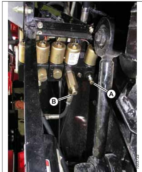
Figure 4.83: Limiteurs réglables d'élévation et d'abaissement de la plateforme
