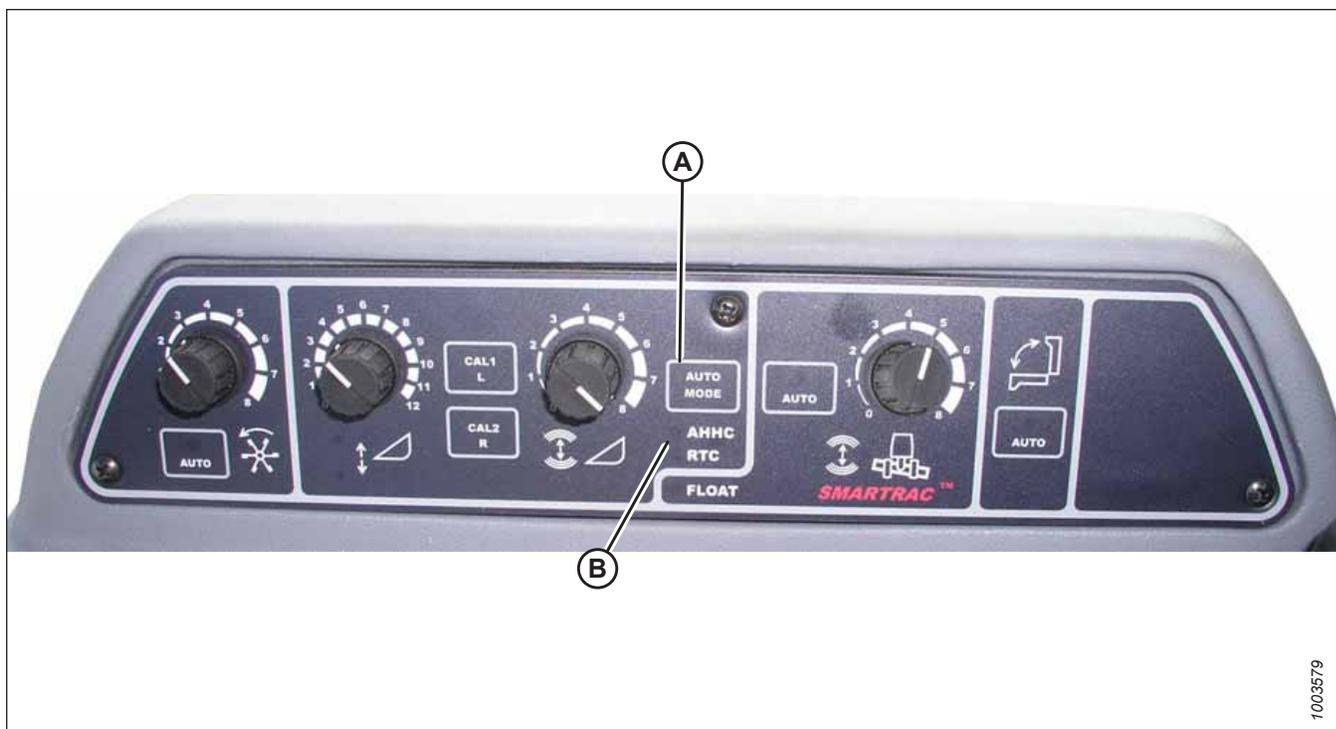
Figure 4.79: Commandes du système de réglage automatique de la hauteur de la plateforme de la moissonneuse-batteuse
