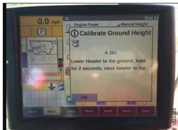
Figure 4.34: Étalonnage de la hauteur automatique de la plateforme
