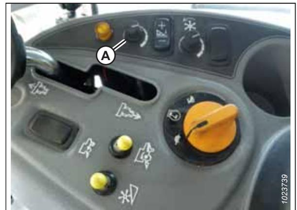
Figure 4.71: Bouton de réglage de la hauteur sur la console de commande de la moissonneuse-batteuse
