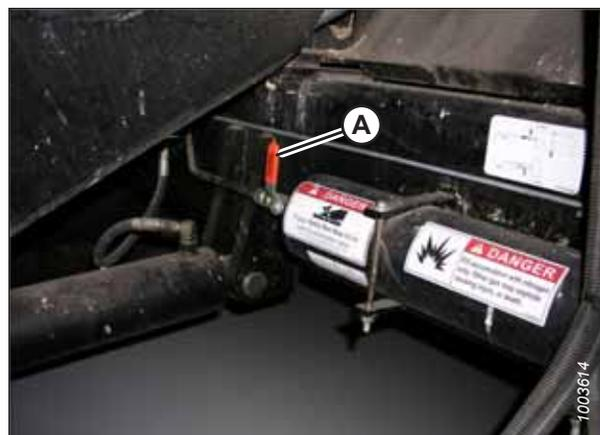
Figure 4.82: Commutateur ON/OFF (marche/arrêt) de l'accumulateur de la moissonneuse-batteuse
