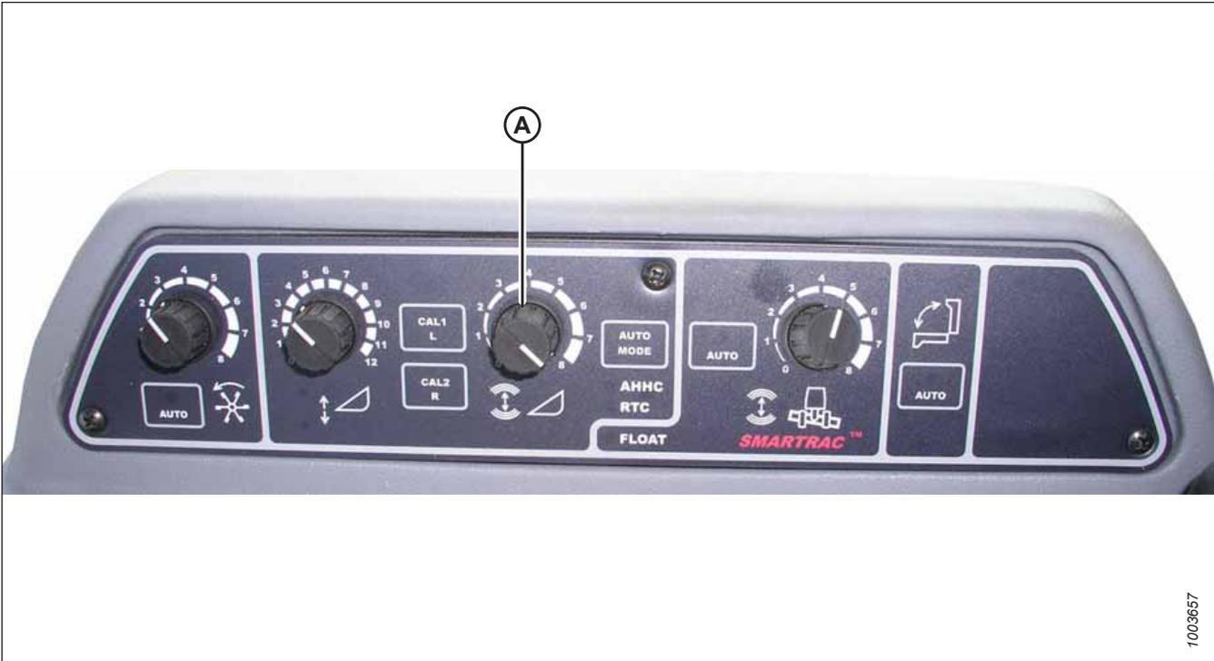
Figure 4.85: Console de contrôle de la hauteur automatique de la plateforme
