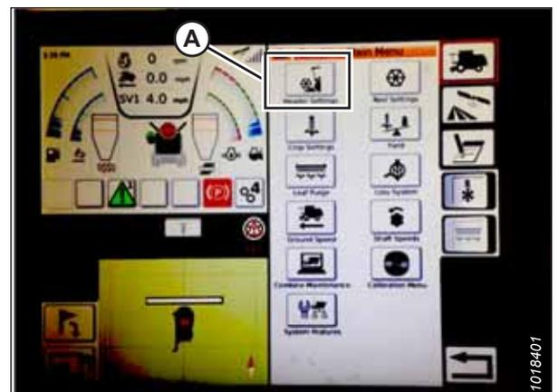
Figure 4.102: Menu principal de la moissonneuse-batteuse
