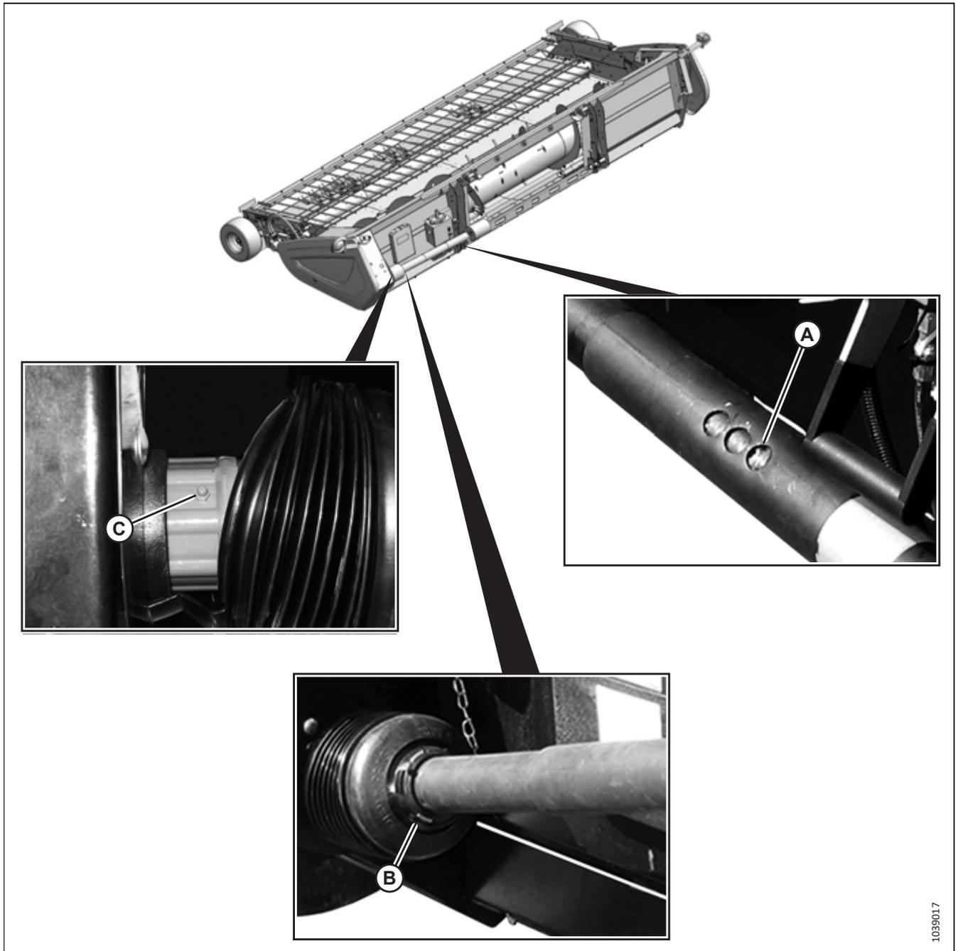
Figure 5.5: Points de graissage
