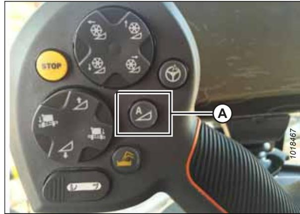
Figure 4.139: CHAP sur la poignée de commande
