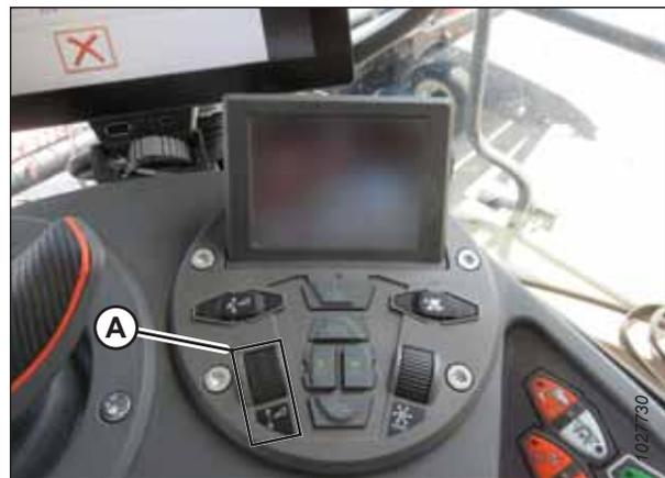
Figure 4.140: Groupe de commande de la plateforme
