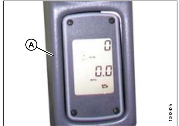
Figure 3.165: Tachymètre
