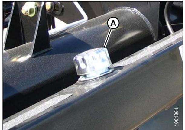
Figure 5.26: Réservoir d'huile
