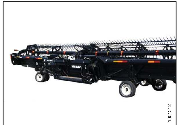
Figure 6.12: Roues stabilisatrices/de transport
