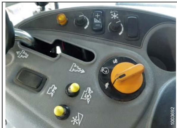
**Figure 3.112: Bouton de réglage de la hauteur sur la console de commande de la moissonneuse-batteuse**
