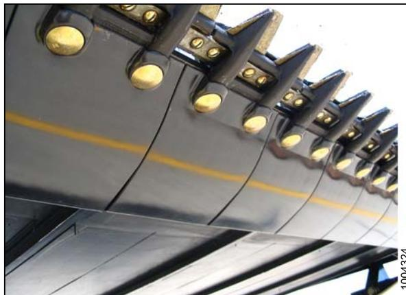
Figure 6.5: Plaque d'usure de la barre de coupe
