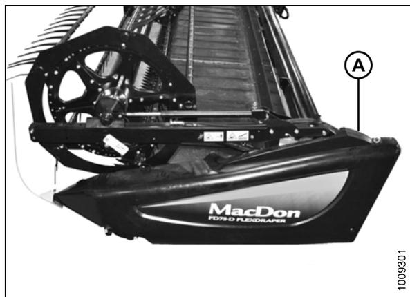
Figure 3.61: Capot d'extrémité de gauche
