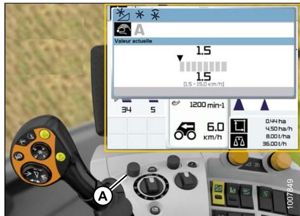
Figure 3.229: Écran de la moissonneuse-batteuse, console et levier de commande
