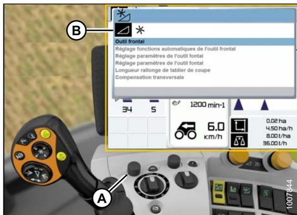
Figure 3.231: Écran, console et manche à balai de la moissonneuse-batteuse.
