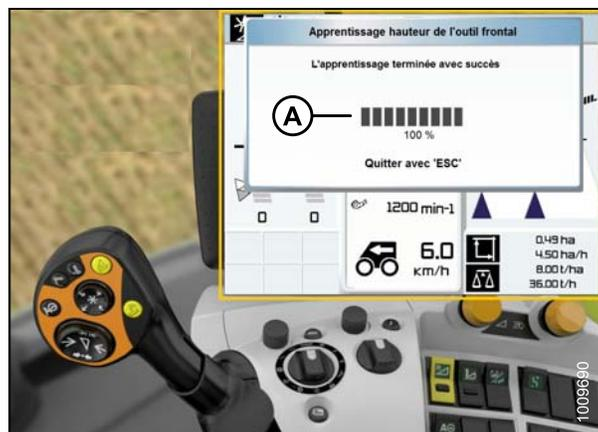
Figure 3.235: Écran, console et manche à balai de la moissonneuse-batteuse.
