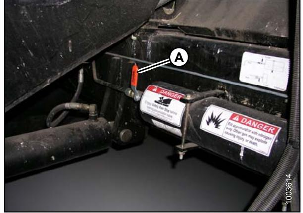
**Figure 3.160: Interrupteur marche/arrêt de l'accumulateur de la moissonneuse-batteuse**
