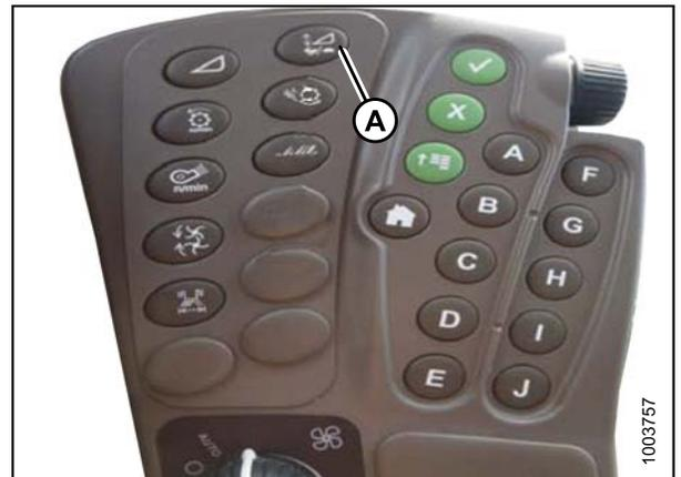
**Figure 3.212: Centre de commande de la moissonneuse-batteuse**
