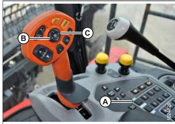
Рисунок 3.94: Ручка и консоль управления комбайна Versatile
