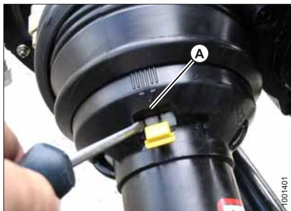
Рисунок 5.47: Кожух кардана привода жатки
