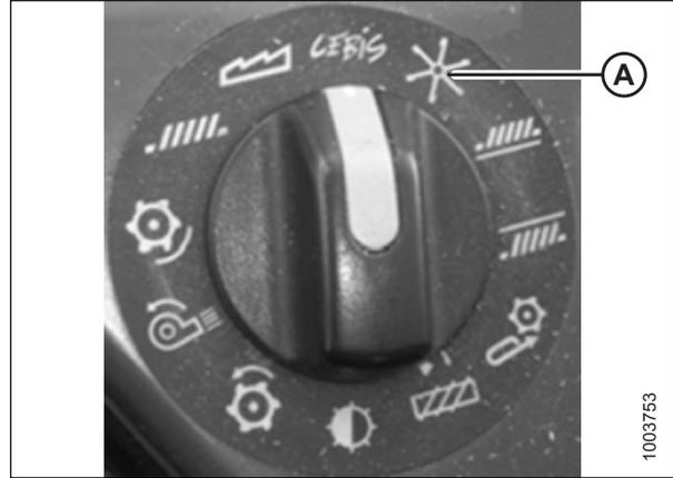
Рисунок 3.310: Поворотный выключатель комбайна CLAAS
