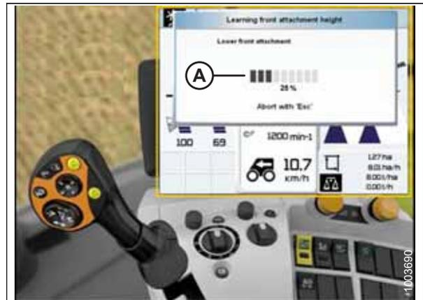
Рисунок 3.334: Дисплей, консоль и ручка управления комбайна CLAAS
