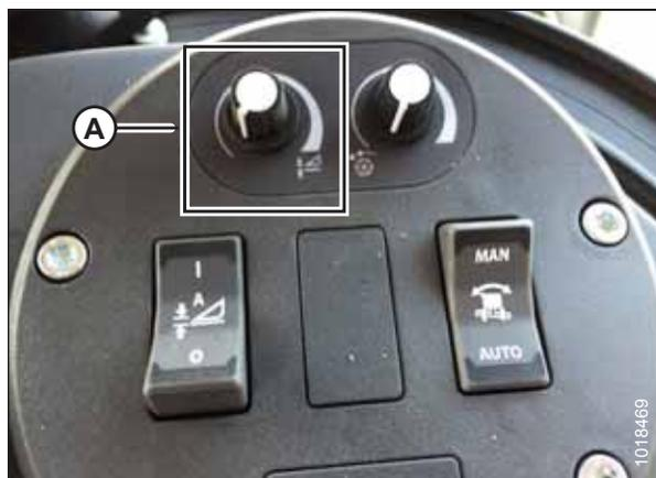
Рисунок 3.412: Блок управления жатки
