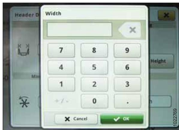
Рисунок 3.490: Дисплей John Deere S7 — настройка ширины жатки
