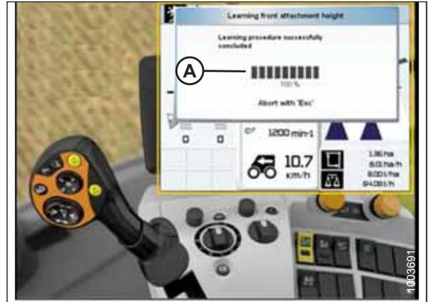
Рисунок 3.335: Дисплей, консоль и ручка управления комбайна CLAAS
