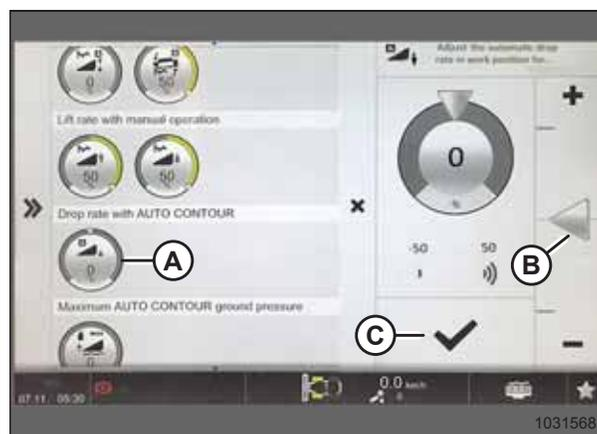
Рисунок 3.358: Страница скорости опускания с автоконтуром
