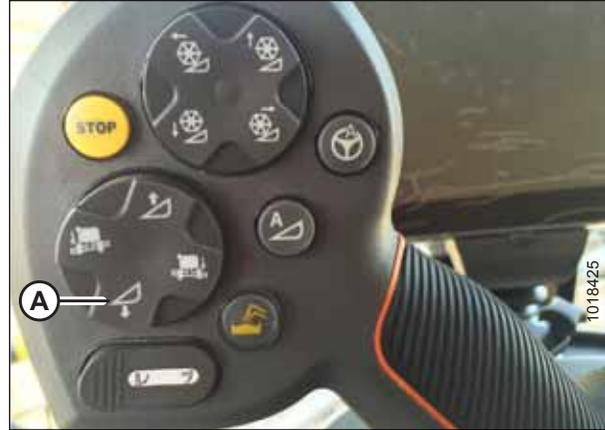
Рисунок 3.400: Кнопка опускания жатки
