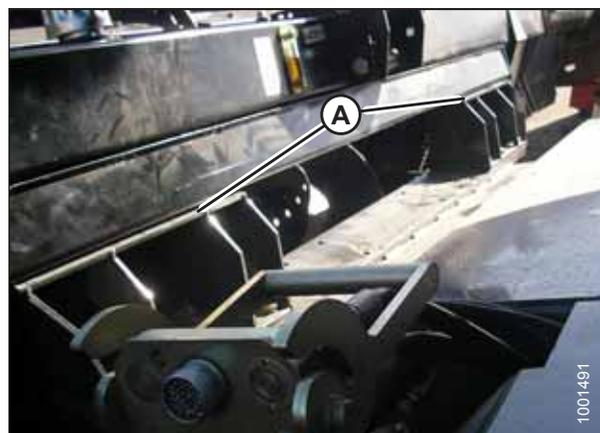
Рисунок 4.54: Наклонная камера и копирующий модуль
