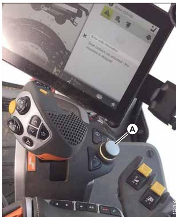
Рисунок 3.365: Элементы управления для оператора
