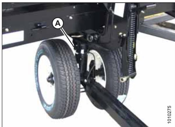
Рисунок 3.603: Соединение жгута проводов
