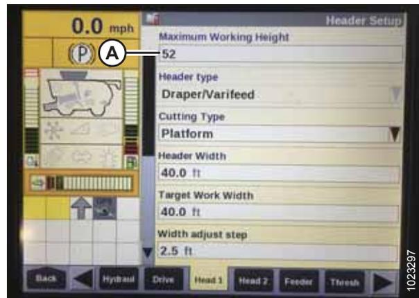
Рисунок 3.237: Дисплей комбайна Case: экран настройки жатки
