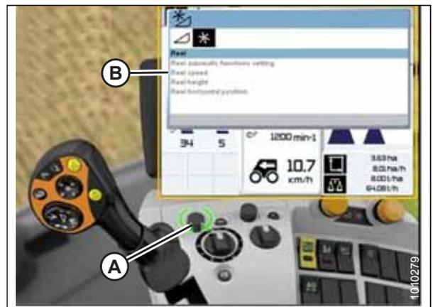
Рисунок 3.327: Дисплей, консоль и ручка управления комбайна CLAAS
