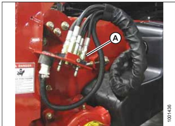
Рисунок 4.88: Разъемы комбайна
