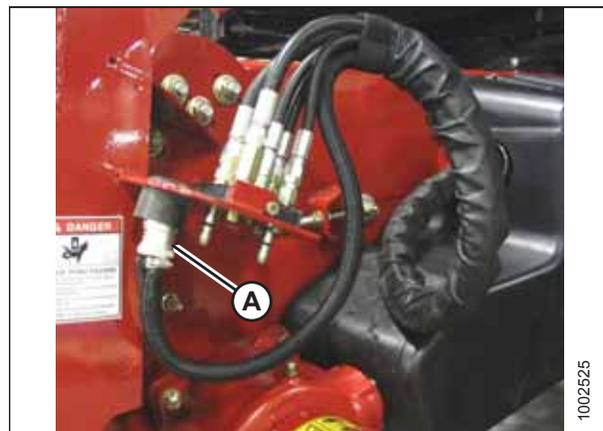
Рисунок 4.91: Разъемы комбайна
