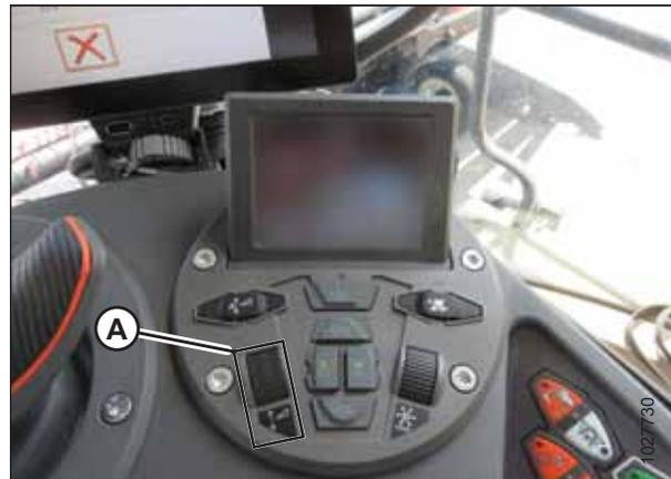
Рисунок 3.209: Блок управления жатки
