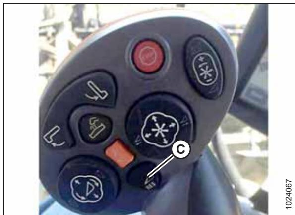
Рисунок 3.560: Многофункциональная ручка комбайна New Holland
