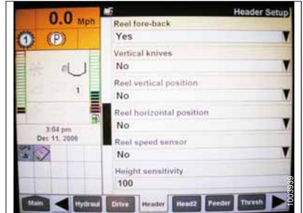
Рисунок 3.257: Приборная панель комбайна Case IH
