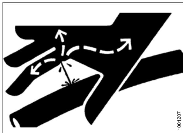
Рисунок 5.2: Опасное давление гидравлической жидкости
