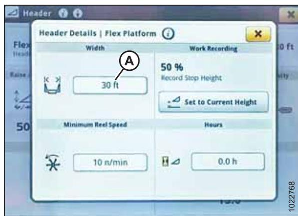
Рисунок 3.489: Дисплей комбайна John Deere серии S7: окно подробной информации о жатке
