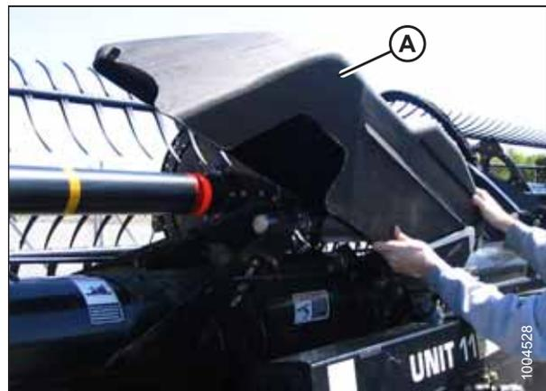
Рисунок 3.19: Крышка соединительного механизма
