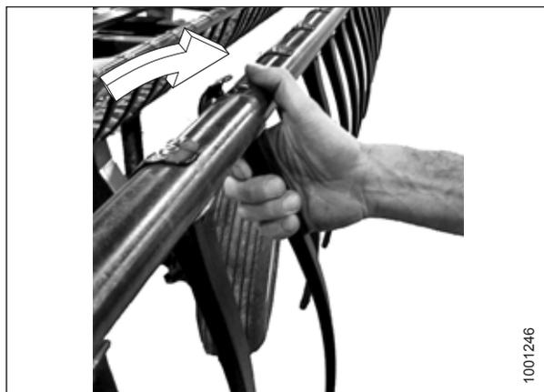
Рисунок 5.256: Установка пластмассового пальца
