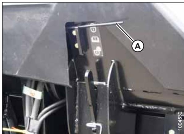
Рисунок 4.159: Замок крыла
