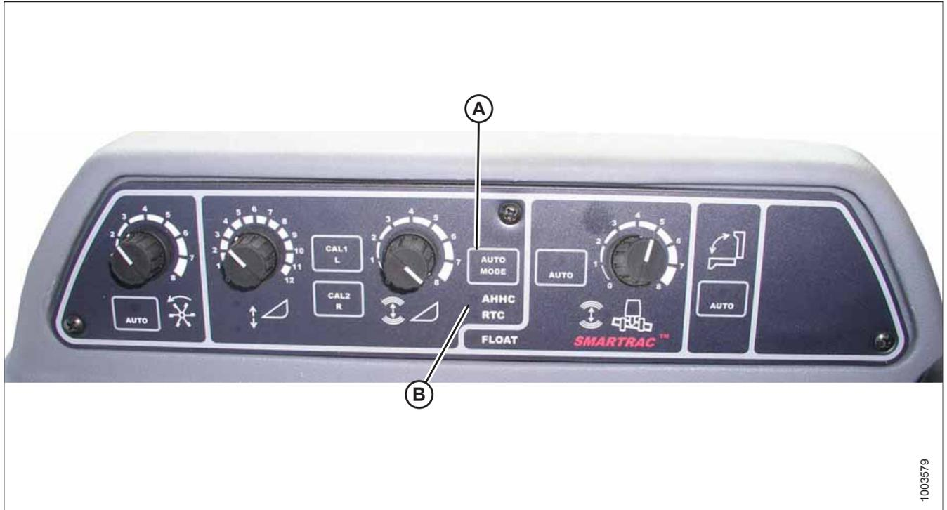
Рисунок 3.369: Органы управления автоматического контроля высоты жатки комбайна
