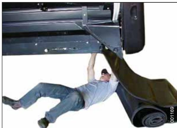
Рисунок 5.199: Установка полотна
