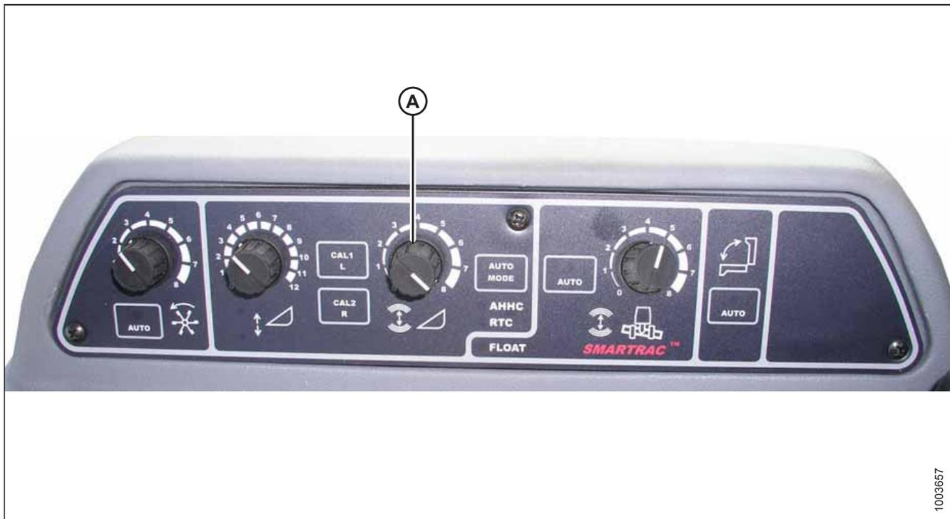
Рисунок 3.376: Консоль автоматического контроля высоты жатки
