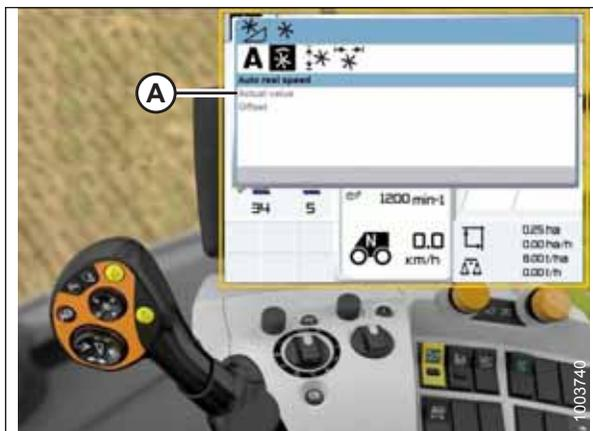
Рисунок 3.328: Дисплей, консоль и ручка управления комбайна CLAAS
