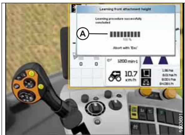
Рисунок 3.321: Дисплей, консоль и ручка управления комбайна CLAAS
