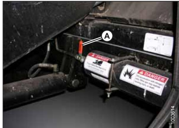
**Рисунок 3.372: Выключатель гидроаккумулятора комбайна**
