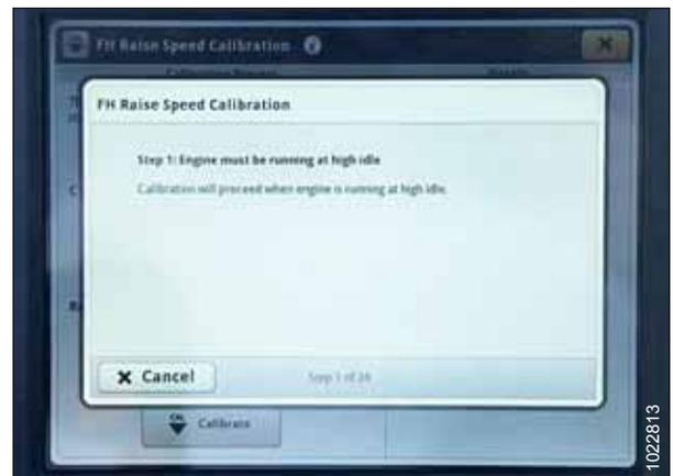
Рисунок 3.508: Дисплей John Deere S7 — калибровка наклонной камеры
