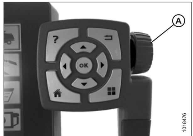
Рисунок 3.211: Колесо регулировки на правой стороне терминала Tyton
