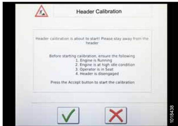
Рисунок 3.402: Предупреждение о калибровке жатки
