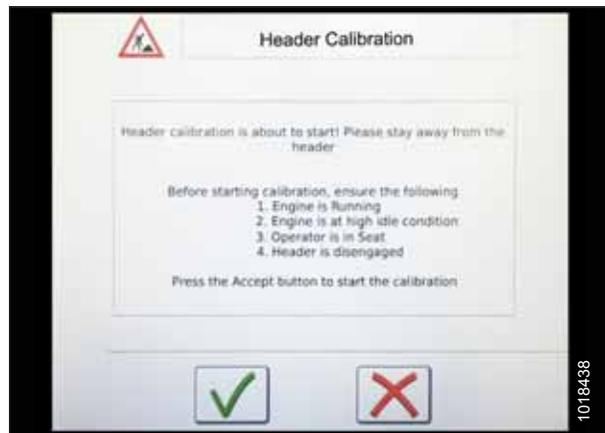
Рисунок 3.202: Предупреждение о калибровке жатки
