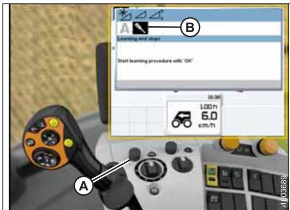
Рисунок 3.319: Дисплей, консоль и ручка управления комбайна CLAAS
