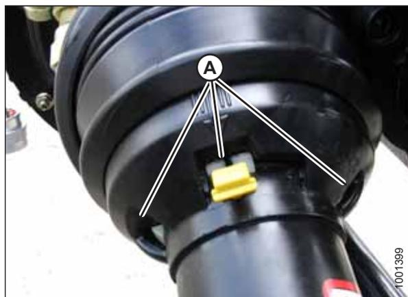
Рисунок 5.46: Кожух кардана привода жатки
