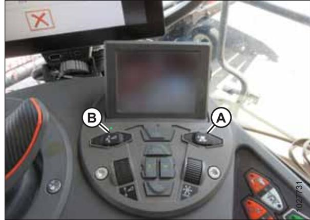
Рисунок 3.207: Блок управления жатки
