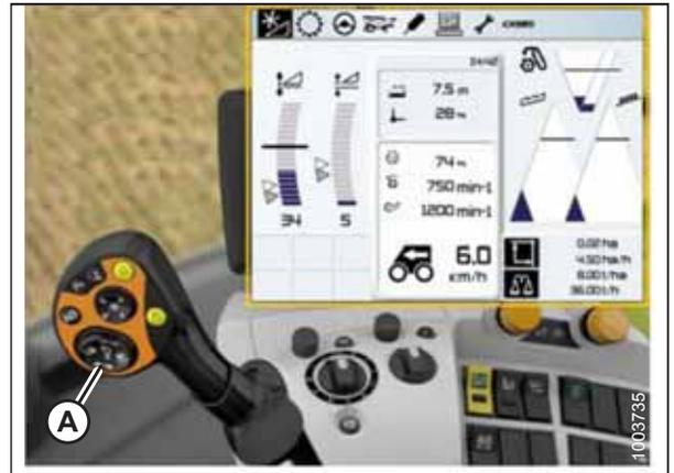
**Рисунок 3.322: Дисплей, консоль и ручка управления комбайна CLAAS**
