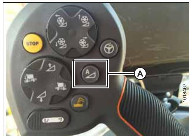
Рисунок 3.408: Автоматический контроль высоты жатки (АННС) на ручке управления
