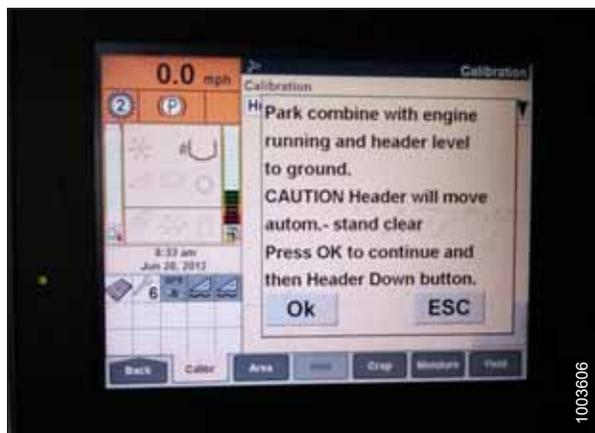
Рисунок 3.526: Дисплей комбайна New Holland
