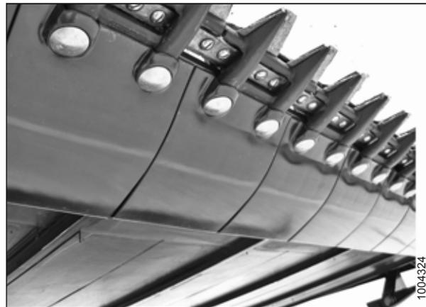
Рисунок 6.8: Противоизносные пластины ножевого бруса
