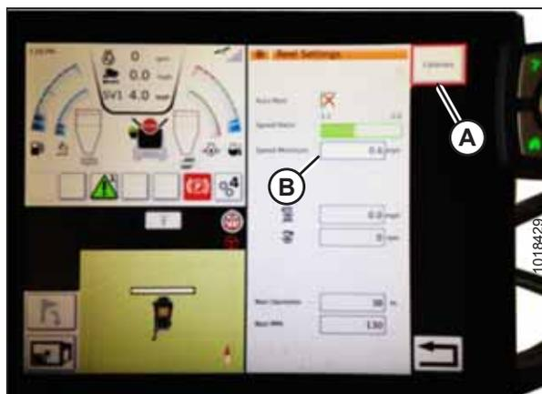
Рисунок 3.194: Калибровка параметров подбирающего мотвила
