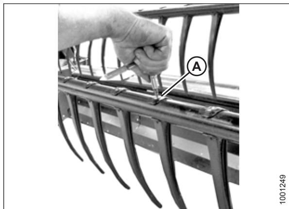
Рисунок 5.254: Снятие пластмассового пальца
