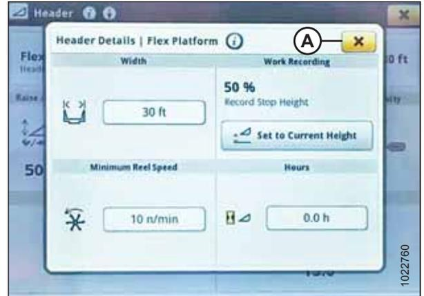
Рисунок 3.491: Дисплей комбайна John Deere серии S7: диалоговое окно подробной информации о жатке
