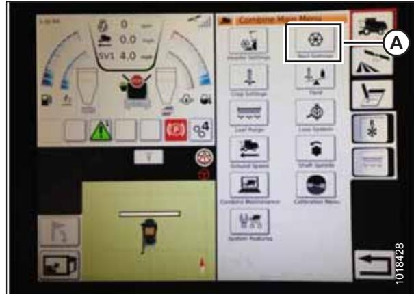
Рисунок 3.389: Настройки подбирающего мотвила в главном меню комбайна
