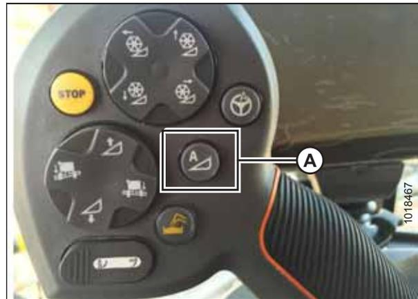
Рисунок 3.208: Автоматический контроль высоты жатки (АННС) на ручке управления
