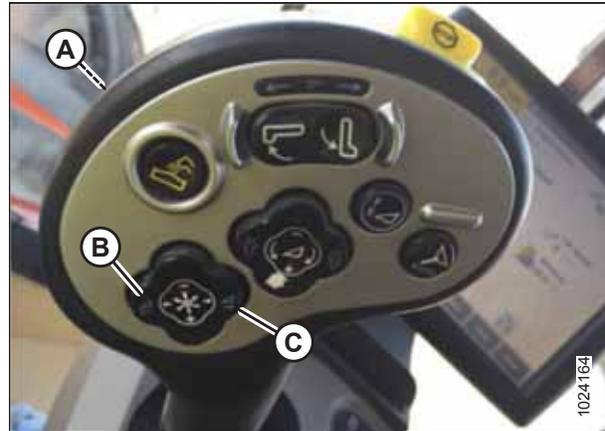
Рисунок 3.80: Органы управления комбайна Case
