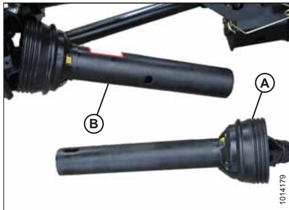
Рисунок 5.42: Раздельный кардан привода жатки
