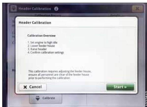
Рисунок 3.515: Дисплей John Deere S7 — калибровка жатки
