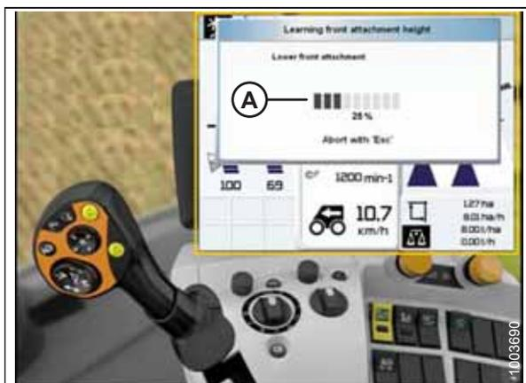
Рисунок 3.320: Дисплей, консоль и ручка управления комбайна CLAAS
