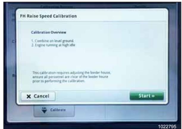
Рисунок 3.507: Дисплей John Deere S7 — калибровка наклонной камеры
