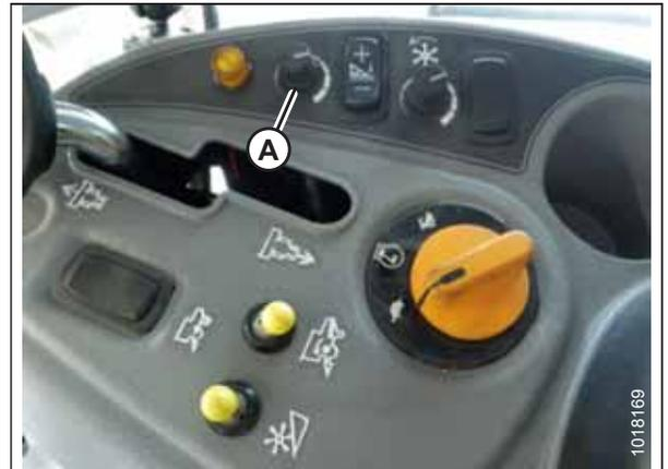
Рисунок 3.290: Ручка регулировки высоты на консоли управления комбайна
