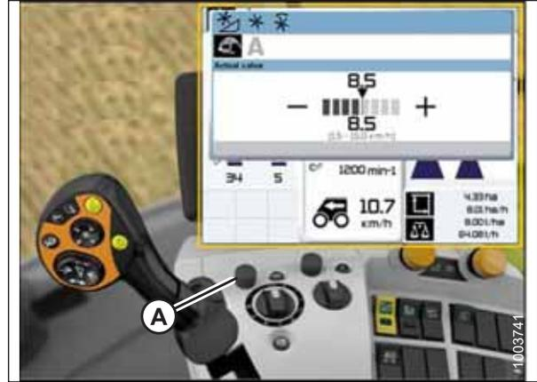
Figura 3.334: Monitor da colheitadeira CLAAS, console e alavanca de controle
