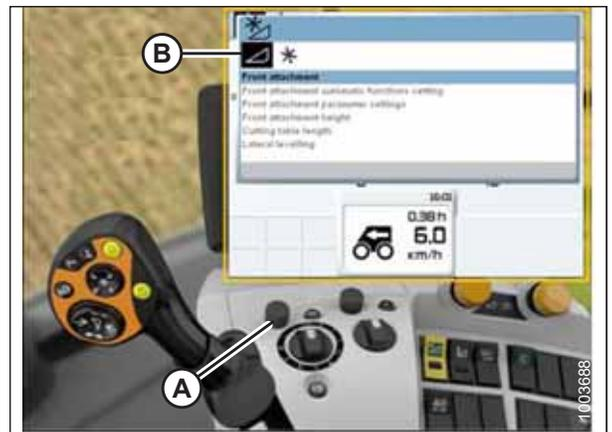
Figura 3.322: Monitor da colheitadeira CLAAS, console e alavanca de controle
