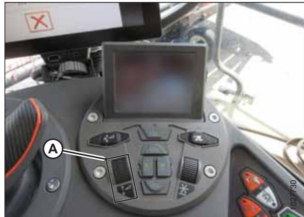
Figura 3.214: Conjunto de controles da plataforma
