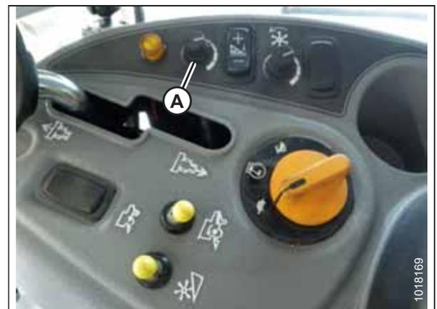
Figura 3.295: Botão de ajuste de altura no console de controle da colheitadeira
