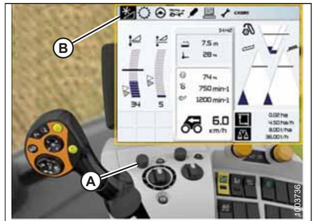
Figura 3.328: Monitor da colheitadeira CLAAS, console e alavanca de controle
