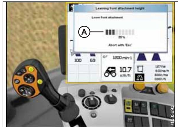
Figura 3.325: Monitor da colheitadeira CLAAS, console e alavanca de controle
