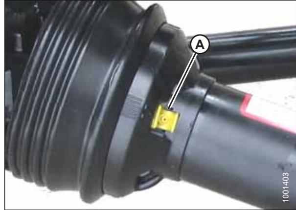
Figura 5.45: Proteção do eixo de transmissão
