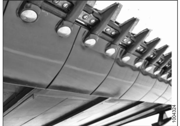
Figura 6.8: Placas de desgaste da barra de corte
