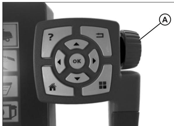
Figura 3.390: Roda de ajuste no lado direito do terminal Tyton
