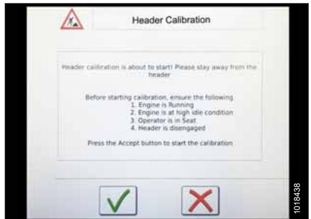
Figura 3.381: Advertência de calibração da plataforma
