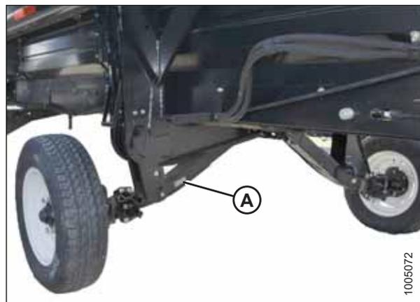
**Figura 3: Sistema de transporte lento/rodas estabilizadoras**
