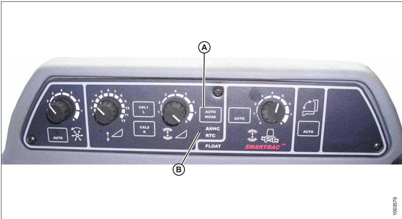
1. Pressione o botão AUTO MODE (MODO AUTOMÁTICO) (A) até que a lâmpada de LED do AHHC (B) comece a piscar. Se a lâmpada do RTC estiver piscando, pressione o botão AUTO MODE (MODO AUTOMÁTICO) (A) novamente até que mude para o AHHC.
