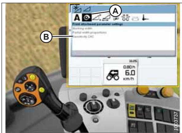
Figura 3.329: Monitor da colheitadeira CLAAS, console e alavanca de controle
