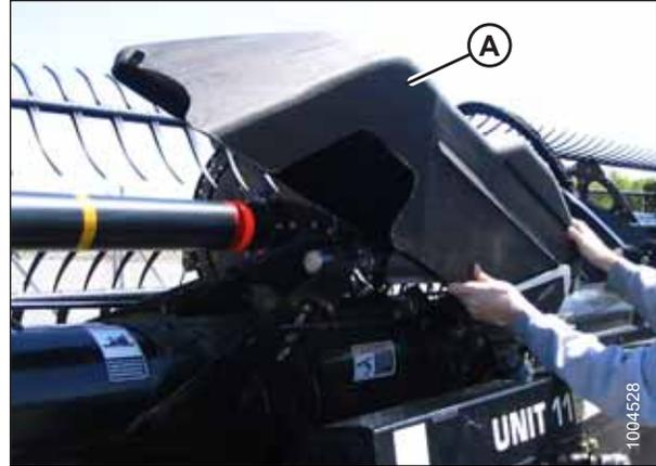
Figura 3.19: Tampa de acoplamento
