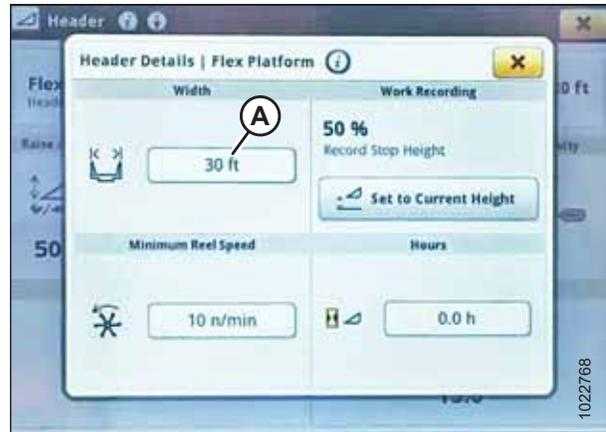
Figura 3.468: Monitor John Deere S7 – Janela de detalhes da plataforma
