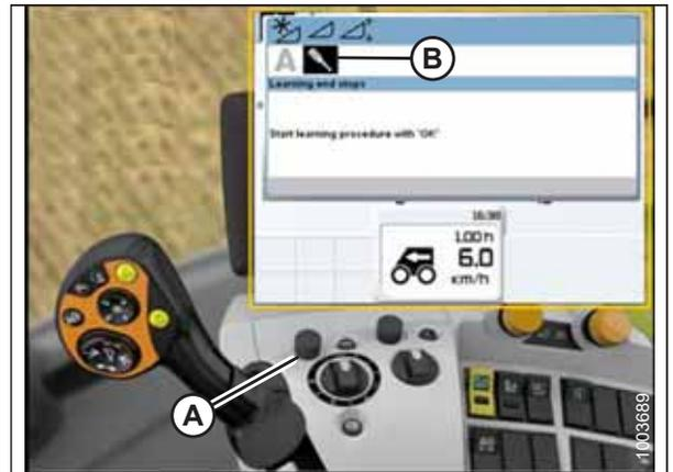
Figura 3.338: Monitor da colheitadeira CLAAS, console e alavanca de controle
