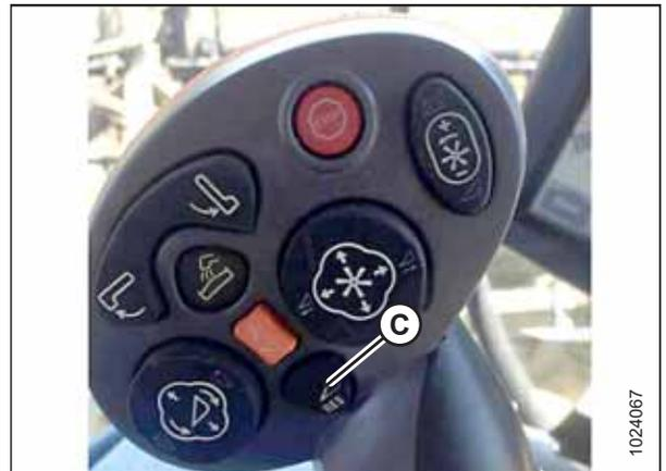
Figura 3.539: Alavanca multifunção da colheitadeira New Holland
