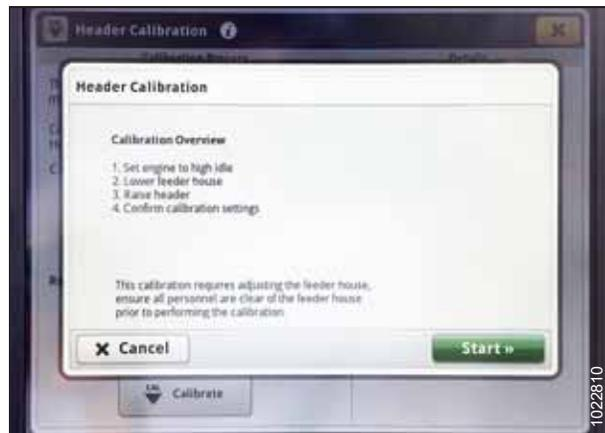
Figura 3.494: Monitor John Deere S7 – Calibração da plataforma
