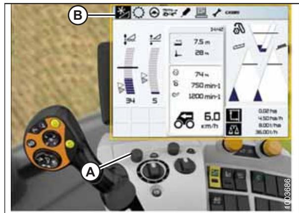
Figura 3.335: Monitor da colheitadeira CLAAS, console e alavanca de controle
