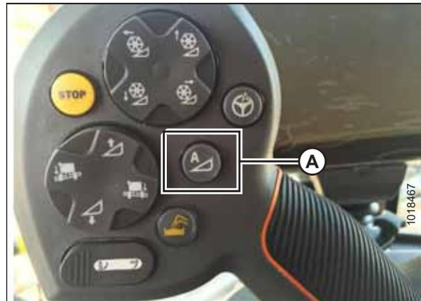
Figura 3.213: AHHC (Controle Automático de Altura da Plataforma) na alavanca de controle
