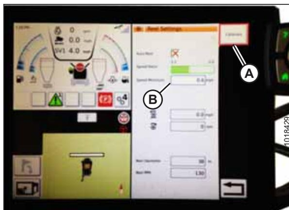
Figura 3.368: Calibração das configurações do molinete
