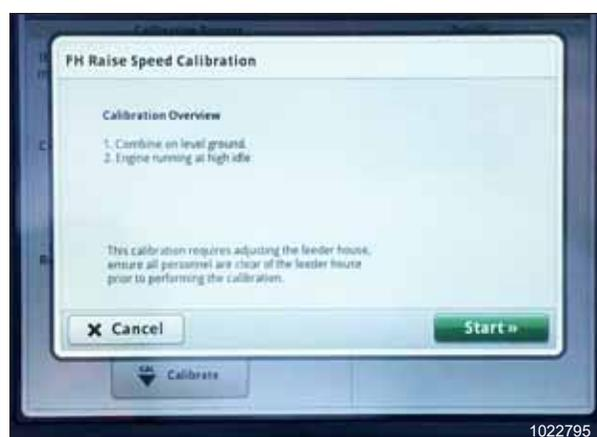
Figura 3.486: Monitor John Deere S7 – Calibração do alimentador
