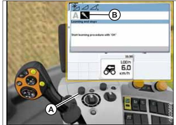
Figura 3.324: Monitor da colheitadeira CLAAS, console e alavanca de controle
