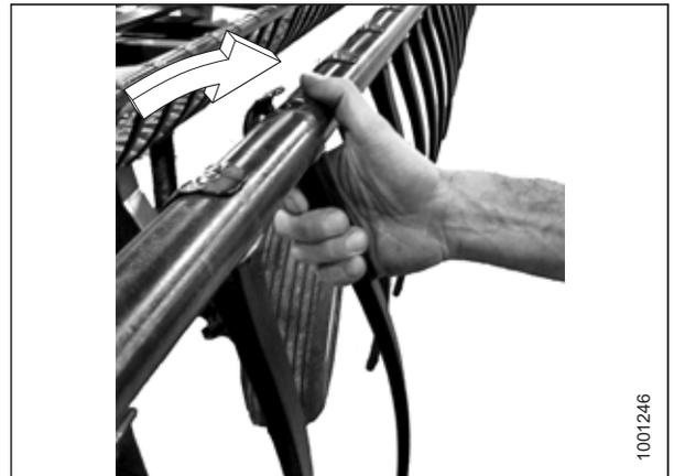
Figura 5.246: Instalação do dedo de plástico
