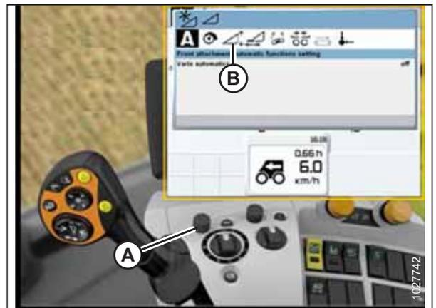
Figura 3.323: Monitor da colheitadeira CLAAS, console e alavanca de controle
