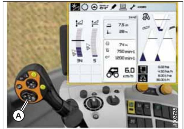
Figura 3.327: Monitor da colheitadeira CLAAS, console e alavanca de controle
