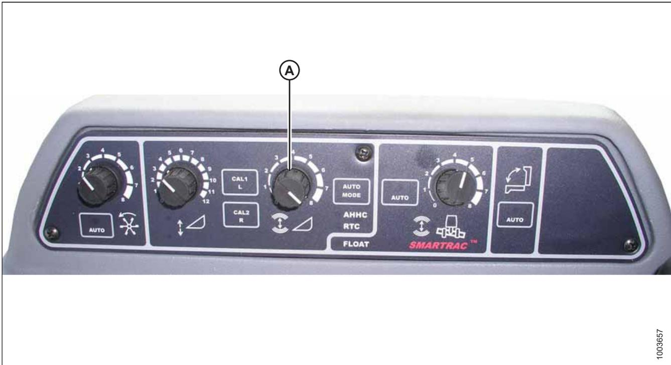
O botão SENSITIVITY ADJUSTMENT (AJUSTE DE SENSIBILIDADE) (A) controla a distância que a barra de corte deve percorrer para cima ou para baixo antes que o controle automático de altura da plataforma (AHHC) reaja e levante ou abaixe o alimentador.
