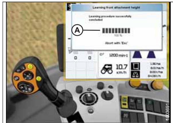
Figura 3.326: Monitor da colheitadeira CLAAS, console e alavanca de controle
