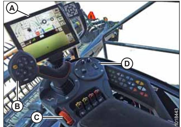
Figura 3.385: Controles do operador da Gleaner S9
