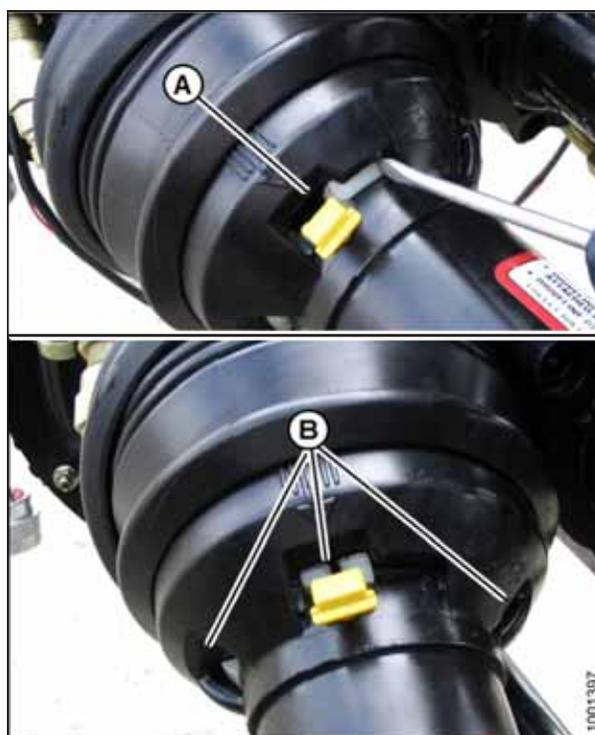
Figura 5.41: Proteção do eixo de transmissão
