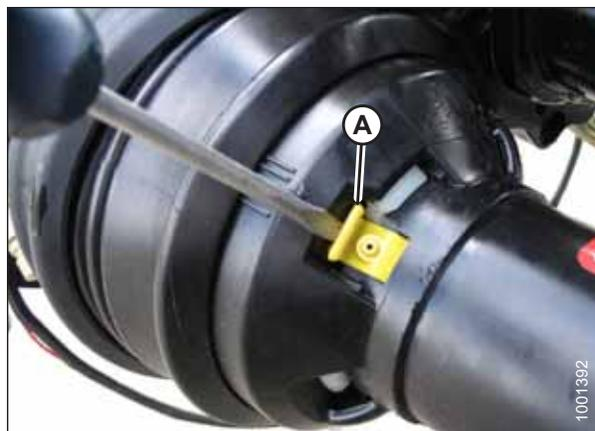
Figura 5.40: Proteção do eixo de transmissão
