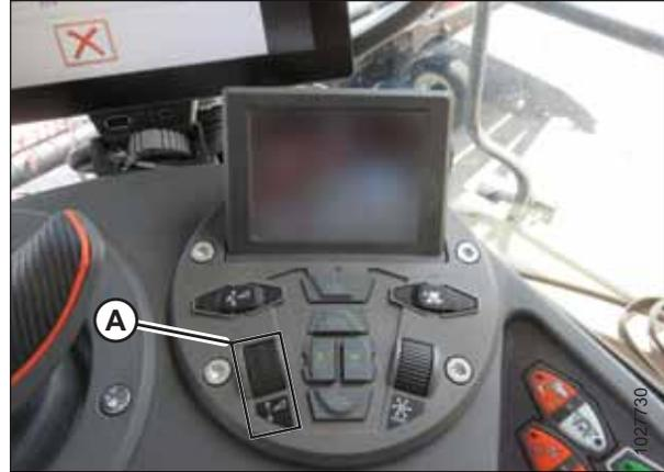
Figura 3.217: Conjunto de controles da plataforma
