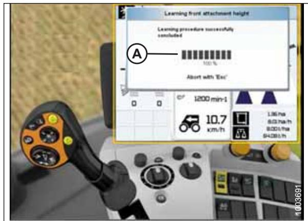
Figura 3.340: Monitor da colheitadeira CLAAS, console e alavanca de controle
