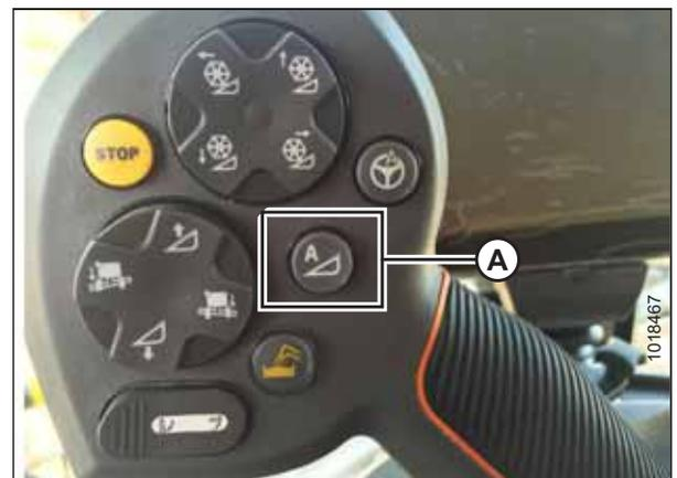
Figura 3.387: AHC (Controle Automático de Altura da Plataforma) na alavanca de controle
