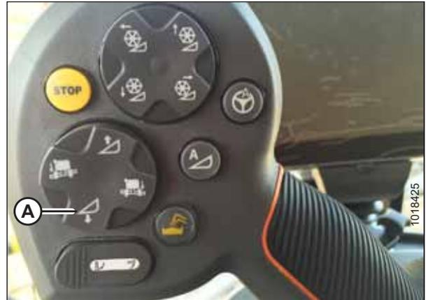
Figura 3.379: Interruptor de descida da plataforma
