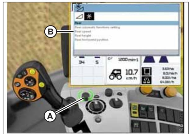
Figura 3.332: Monitor da colheitadeira CLAAS, console e alavanca de controle
