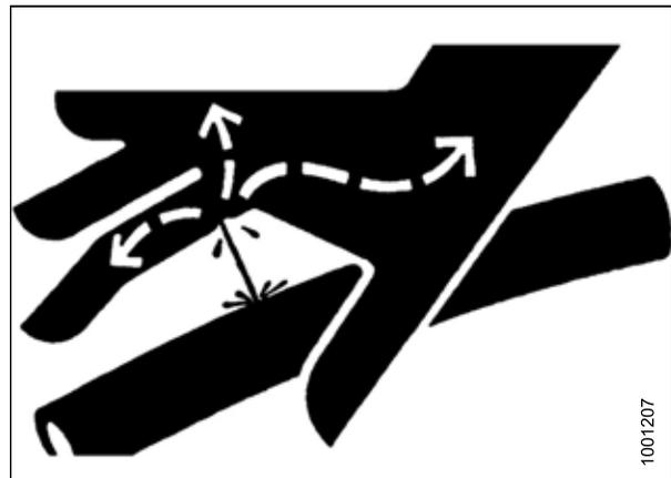
Figura 1.12: Perigo da pressão hidráulica
