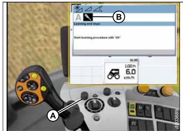
Figura 3.439: Monitor da colheitadeira CLAAS, console e alavanca de controle
