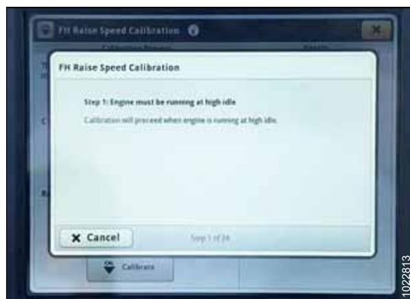
Figura 3.407: Monitor John Deere S7 – Calibração do alimentador
