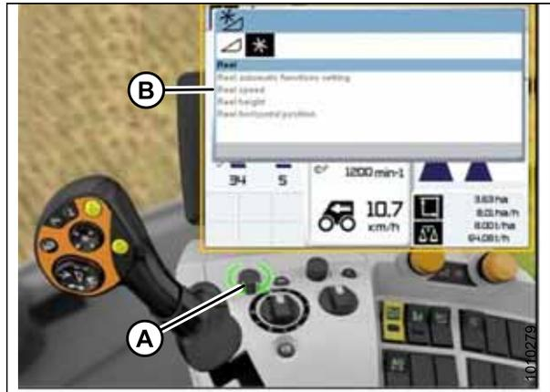
Figura 3.447: Monitor da colheitadeira CLAAS, console e alavanca de controle
