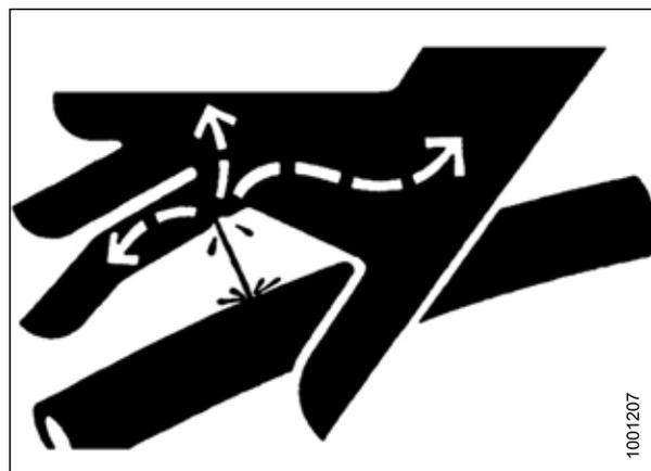
Figura 5.2: Perigo da pressão hidráulica
