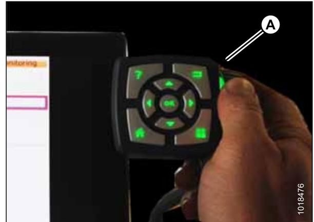
Figura 3.311: Roda de ajuste no lado direito do terminal Tyton
