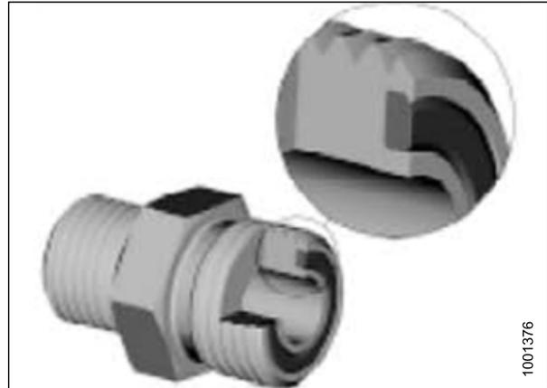
Figura 8.10: Encaixe hidráulico
