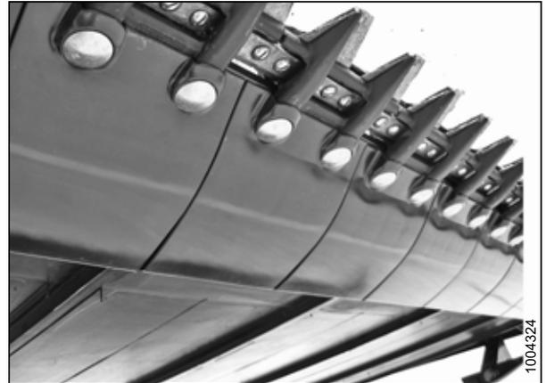
Figura 6.7: Placas de desgaste da barra de corte
