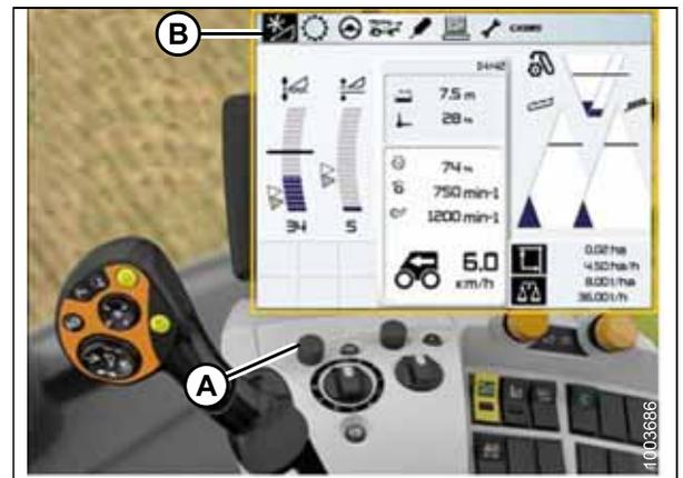
Figura 3.436: Monitor da colheitadeira CLAAS, console e alavanca de controle
