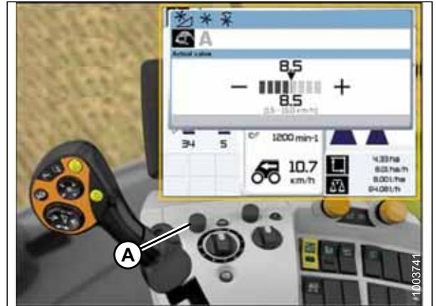
Figura 3.449: Monitor da colheitadeira CLAAS, console e alavanca de controle
