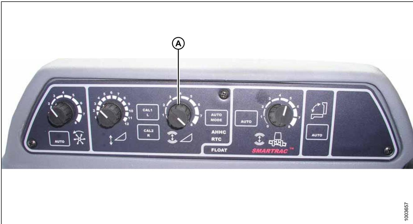
O seletor de AJUSTE DA SENSIBILIDADE (A) controla a distância que a barra de corte deve percorrer, para cima ou para baixo, antes que o AHHC reaja e levante ou abaixe o alimentador.
