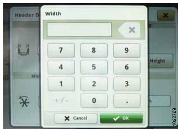
Figura 3.389: Monitor John Deere S7 – Ajuste de largura da plataforma
