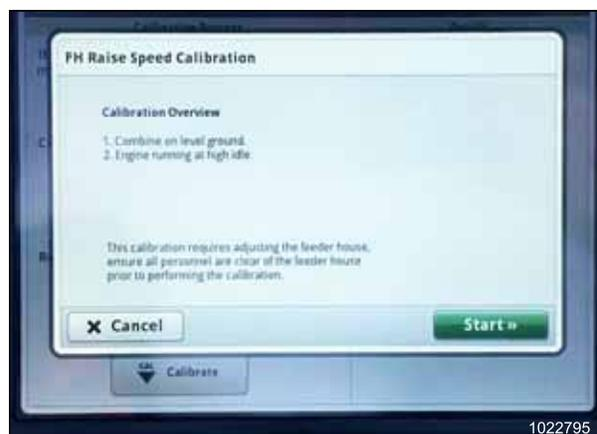
Figura 3.406: Monitor John Deere S7 – Calibração do alimentador
