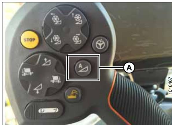
**Figura 3.308: AHHC (Controle Automático de Altura da Plataforma) na alavanca de controle**
