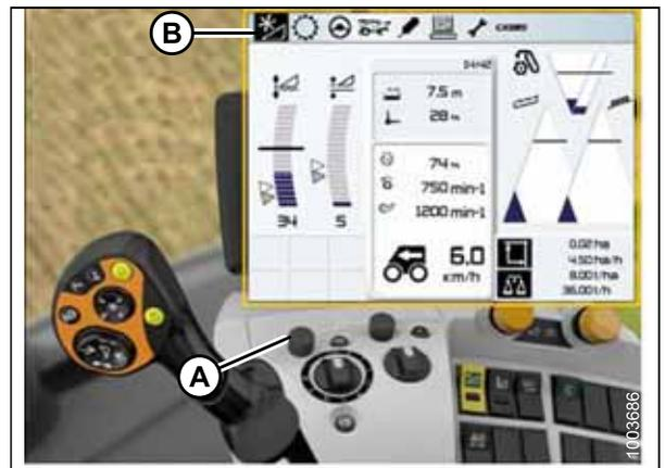
Figura 3.450: Monitor da colheitadeira CLAAS, console e alavanca de controle
