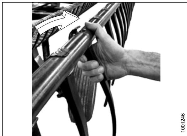
Figura 5.234: Instalação do dedo de plástico
