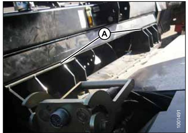
Figura 4.70: Módulo de flutuação e alimentador
