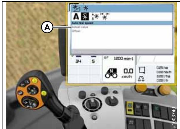
Figura 3.448: Monitor da colheitadeira CLAAS, console e alavanca de controle
