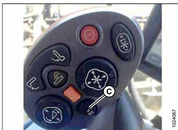
Figura 3.501: Alavanca multifunção da Colheitadeira New Holland
