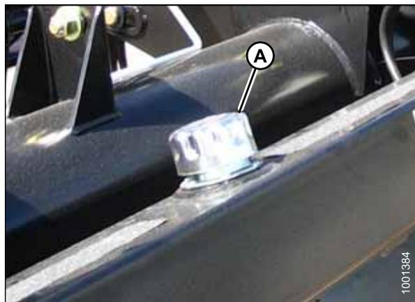
Figura 5.28: Tampa de enchimento do óleo do reservatório
