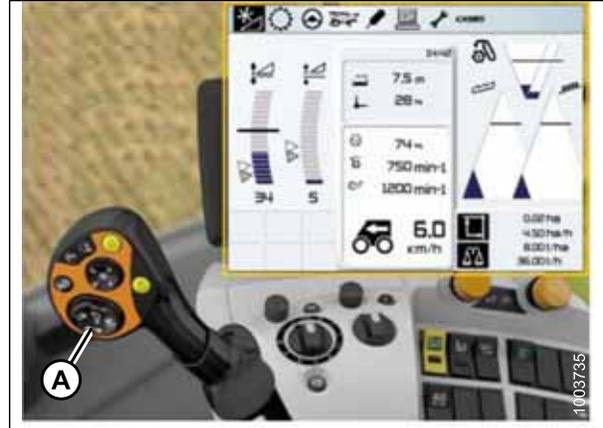
**Figura 3.442: Monitor da colheitadeira CLAAS, console e alavanca de controle**
