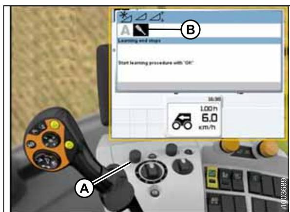
Figura 3.453: Monitor da colheitadeira CLAAS, console e alavanca de controle
