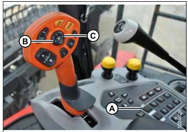
Figura 3.91: Console e alavanca de controle Versatile
