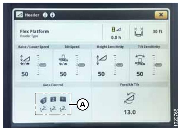
Figura 3.393: Monitor John Deere S7 – Tela da plataforma
