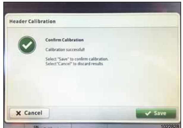
Figura 3.415: Monitor John Deere S7 – Calibração da plataforma
