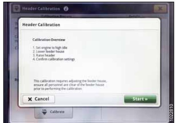
Figura 3.414: Monitor John Deere S7 – Calibração da plataforma
