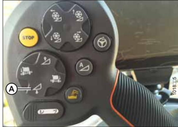
Abbildung 3.400: Taste „Schneidwerk absenken“
