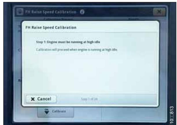
Abbildung 3.508: Display John Deere S7 – Kalibrierung Schrägförderer
