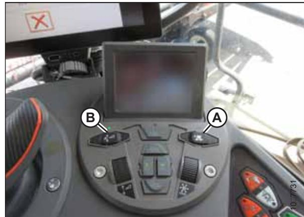
Abbildung 3.207: Schneidwerk-Bedientafel
