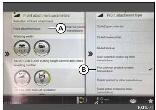
Abbildung 3.341: Seite „Parameter Vorsatzgerät“
