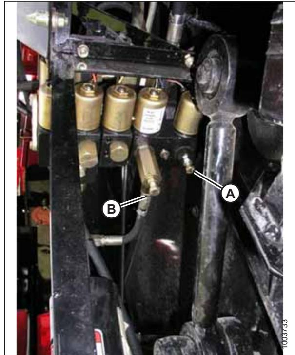
**Abbildung 3.373: Einstellbare Drosselventile für Anhub/Absenken des Schneidwerks**
