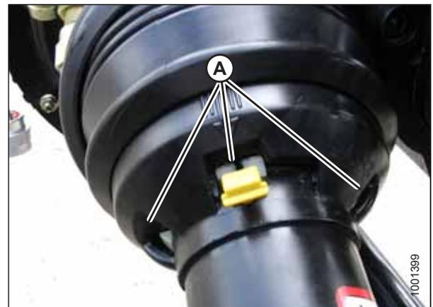
Abbildung 5.46: Antriebswellen-Schutztrichter
