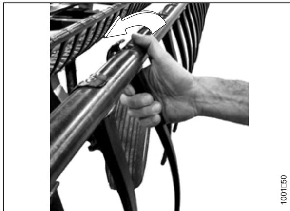
Abbildung 5.255: Ausbauen eines Kunststoffhaspelfingers
