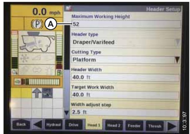
Abbildung 3.237: Display Case Mährescher – Seite „Header Setup“
