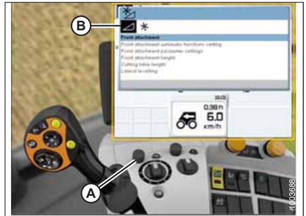
Abbildung 3.317: Display, Bedienkonsole und Multifunktionshebel des CLAAS Mähdreschers
