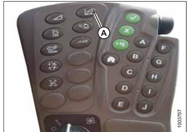
Abbildung 3.458: Bedienkonsole Command Center auf John Deere Mähdreschern
