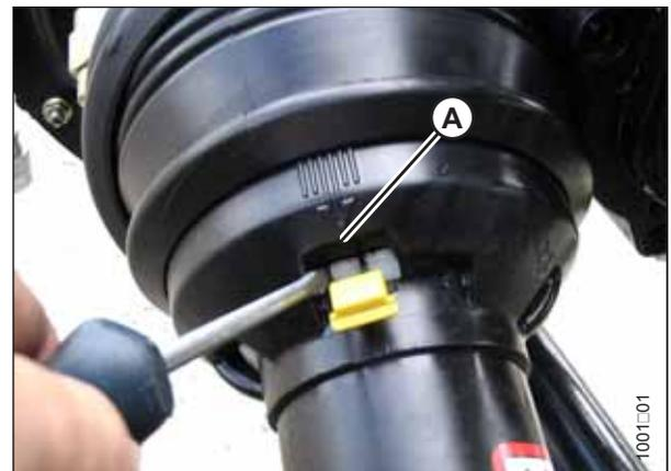
Abbildung 5.47: Antriebswellen-Schutztrichter
