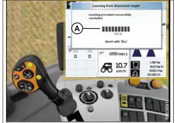
Abbildung 3.335: Display, Bedienkonsole und Multifunktionshebel des CLAAS Mähreschers
