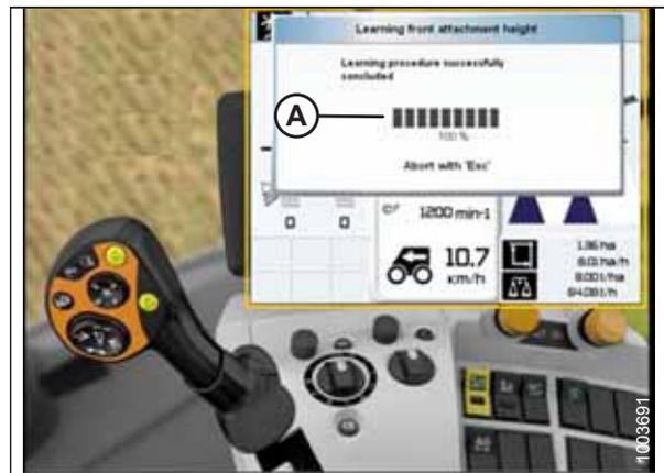
Abbildung 3.321: Display, Bedienkonsole und Multifunktionshebel des CLAAS Mähdreschers
