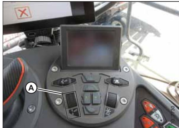
Abbildung 3.212: Schneidwerk-Bedientafel
