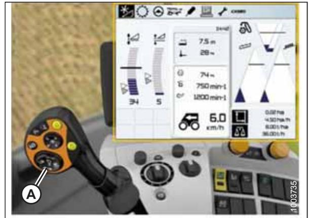
**Abbildung 3.322: Display, Bedienkonsole und Multifunktionshebel des CLAAS Mähreschers**
