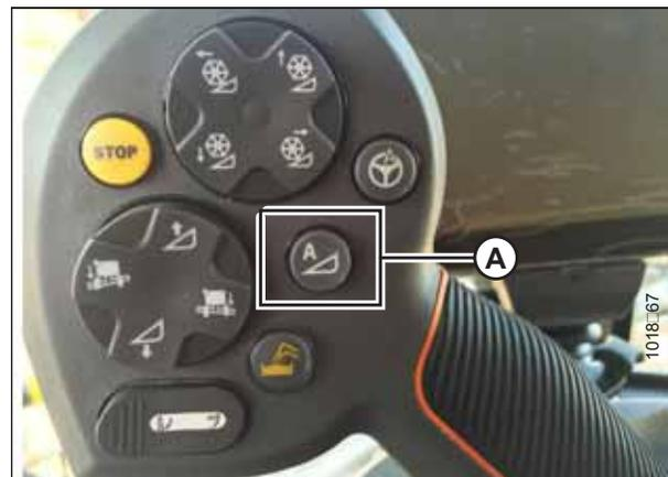
Abbildung 3.208: AHHC am Multifunktionshebel
