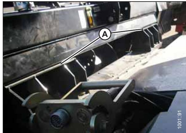
Abbildung 4.54: Schrägförderer und Floatmodul
