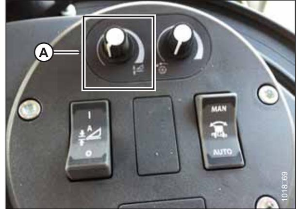
Abbildung 3.409: Schneidwerk-Bedientafel
