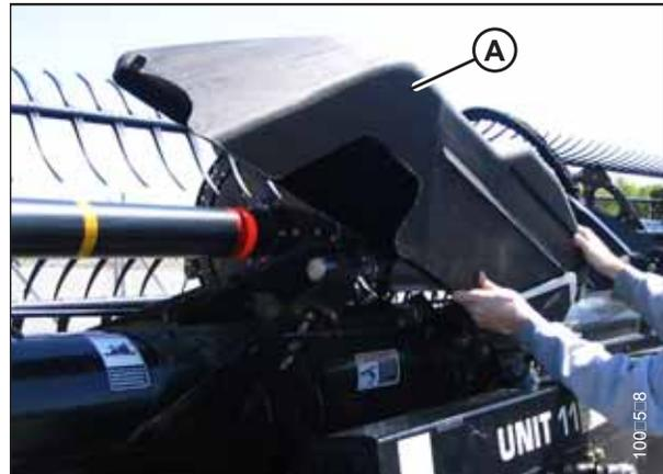
**Abbildung 3.19: Abdeckung der Schneidwerksmechanik**
