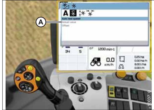
Abbildung 3.328: Display, Bedienkonsole und Multifunktionshebel des CLAAS Mähdreschers
