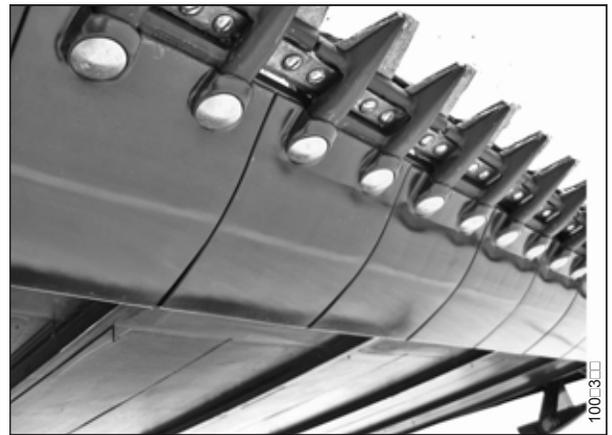
Abbildung 6.8: Messerbalken-Verschleißplatten
