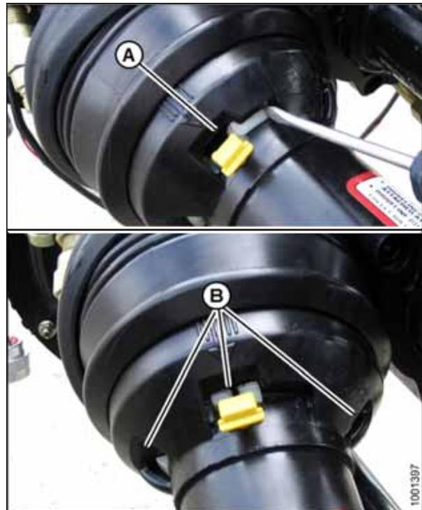
Abbildung 5.44: Antriebswellen-Schutztrichter
