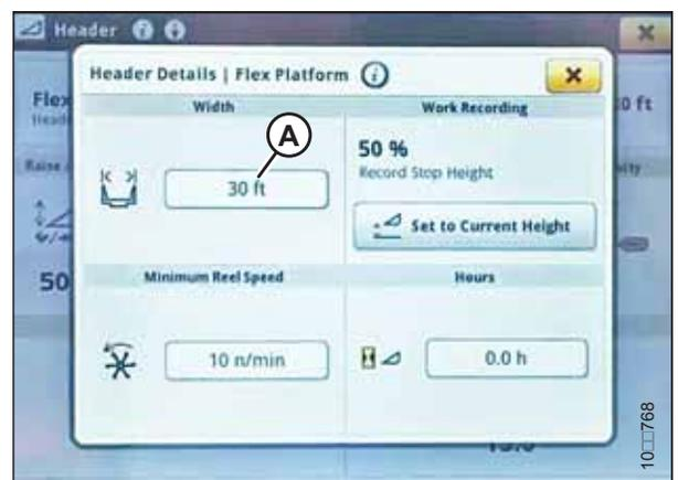
Abbildung 3.489: Display John Deere S7 – Bildschirm mit Schneidwerksangaben
