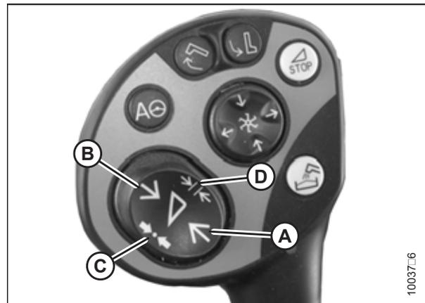
Abbildung 3.304: Tasten auf Multifunktionshebel
