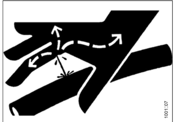
Abbildung 5.2: Gefährdung durch Hydraulikdruck
