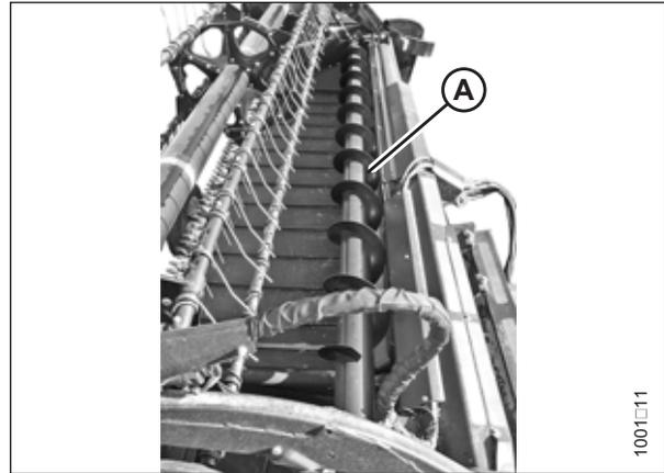
Abbildung 6.26: Obere Querförderschnecke
