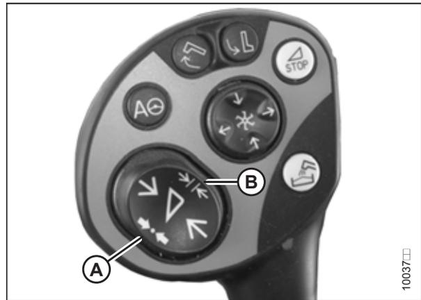
Abbildung 3.311: Tasten auf CLAAS Multifunktionshebel
