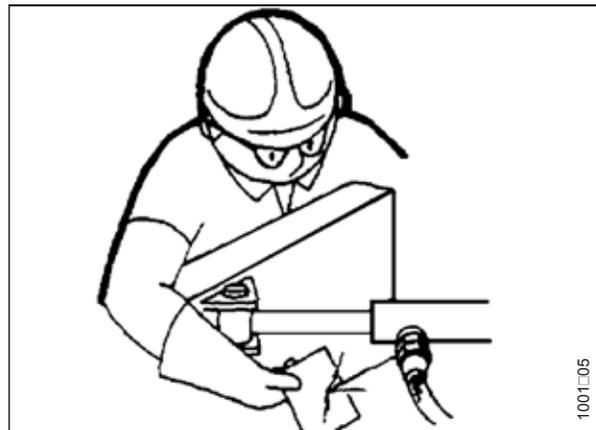
Abbildung 1.11: Suche nach undichten Hydraulikstellen
