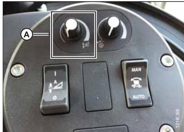
Abbildung 3.412: Schneidwerk-Bedientafel
