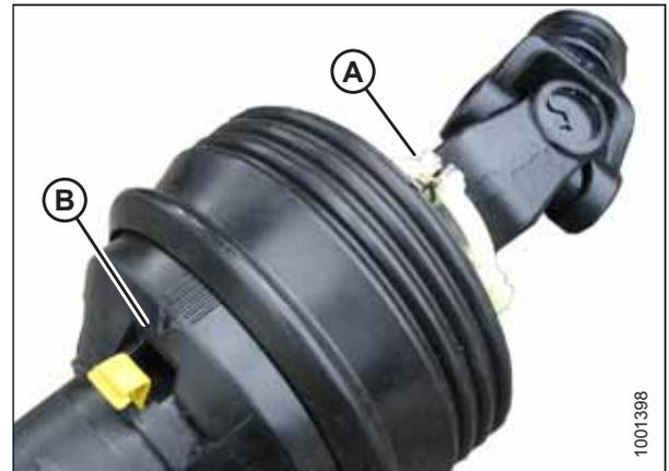
Abbildung 5.45: Antriebswellen-Schutztrichter
