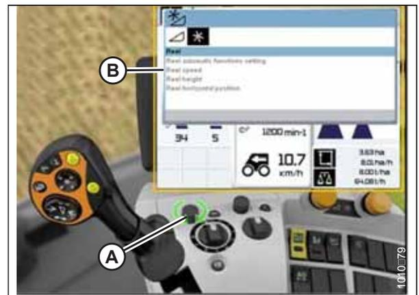
Abbildung 3.327: Display, Bedienkonsole und Multifunktionshebel des CLAAS Mähdeschers
