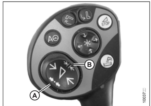
Abbildung 3.301: Tasten auf Multifunktionshebel
