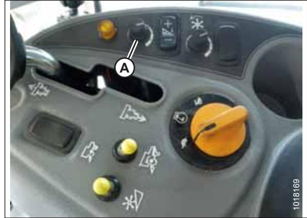
Abbildung 3.290: Schneidwerkshöhe-Drehknopf auf der Bedienkonsole
