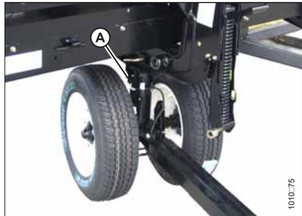
Abbildung 3.603: Elektroanschluss
