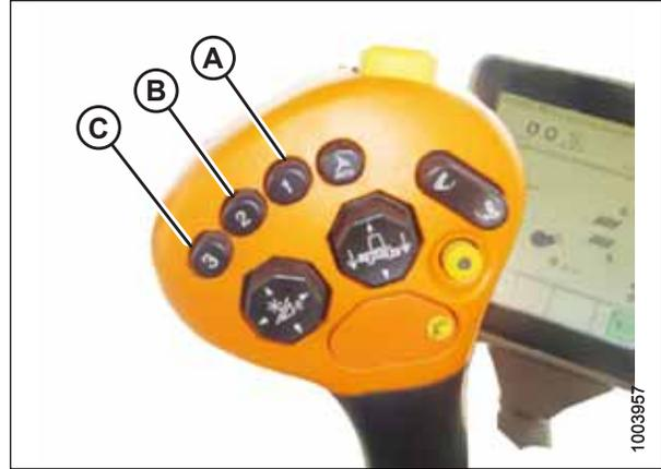
Abbildung 3.465: Tasten auf Multifunktionshebel
