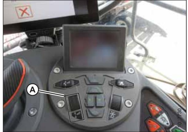
Abbildung 3.209: Schneidwerk-Bedientafel
