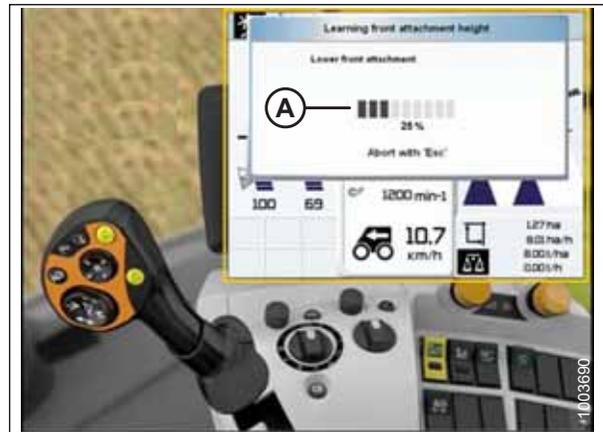
Abbildung 3.320: Display, Bedienkonsole und Multifunktionshebel des CLAAS Mähdreschers
