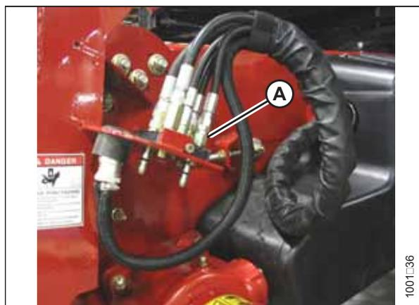
Abbildung 4.88: Multikuppler am Mährescher
