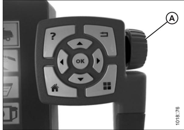
Abbildung 3.211: Scrollrad rechts am Tyton-Terminal
