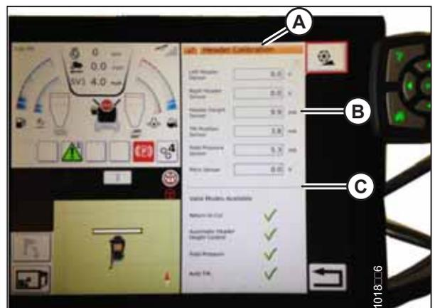
Abbildung 3.399: Bildschirm „Schneidwerkskalibrierung“
