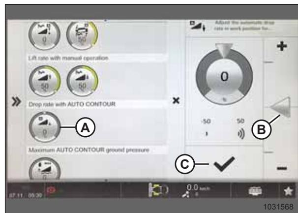
Abbildung 3.358: Auswahl „Absenkgeschwindigkeit bei automatischer Konturführung“
