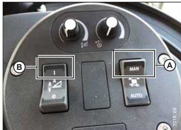
Abbildung 3.407: Schneidwerk-Bedientafel
