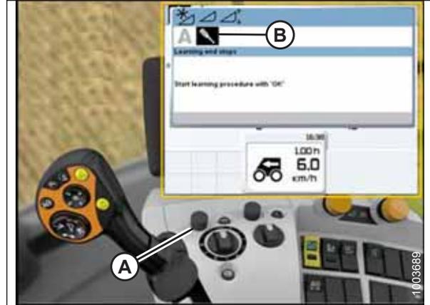
Abbildung 3.319: Display, Bedienkonsole und Multifunktionshebel des CLAAS Mähdreschers
