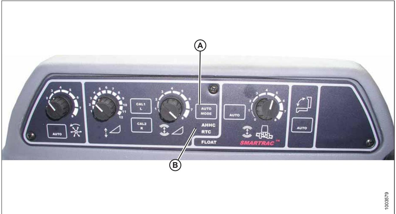
Abbildung 3.369: Bedienelemente für automatische Schneidwerkshöhenregulierung (AHC)
