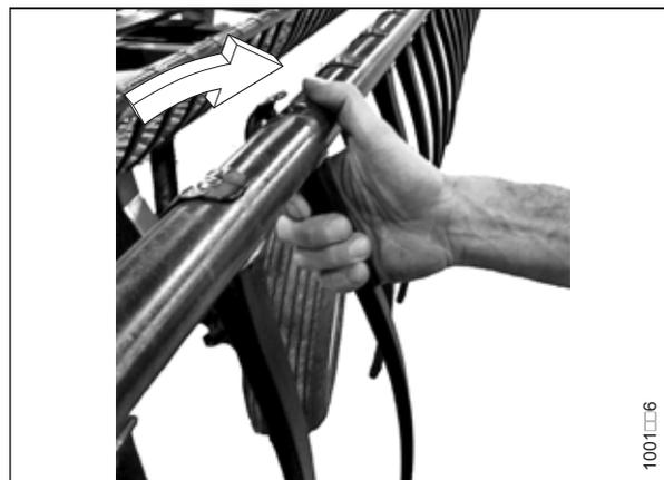
Abbildung 5.256: Einbauen eines Kunststoffhaspelfingers
