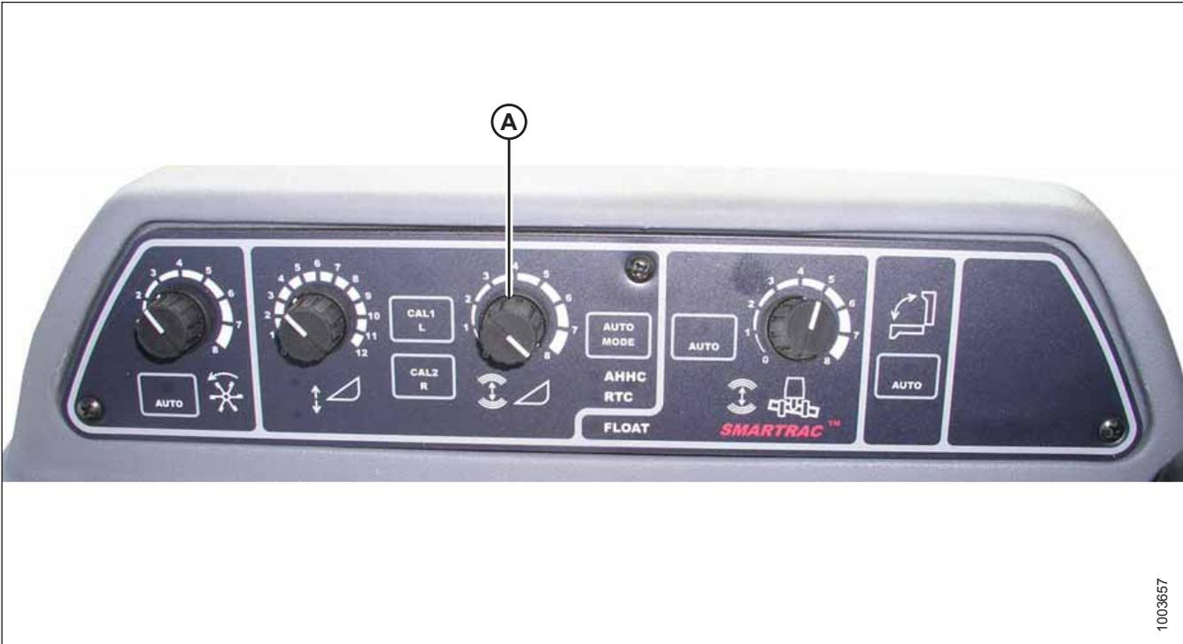
**Abbildung 3.376: Bedienkonsole der automatischen Schneidwerkshöhenregulierung (AHHC)**
