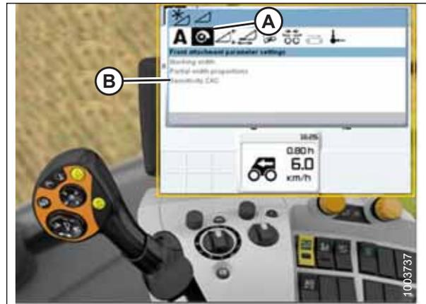
Abbildung 3.324: Display, Bedienkonsole und Multifunktionshebel des CLAAS Mähdeschers
