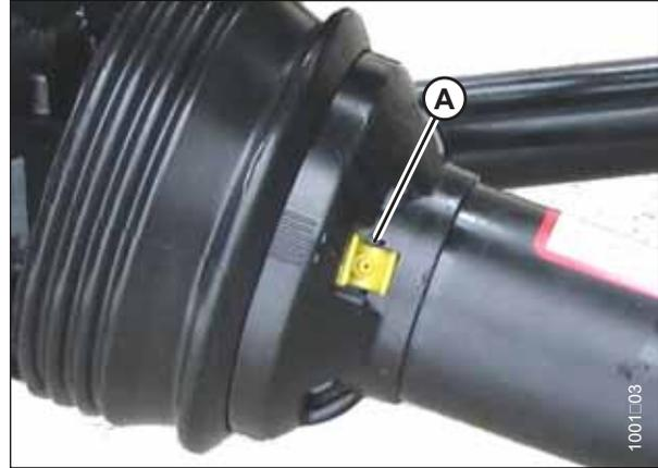
Abbildung 5.48: Antriebswellen-Schutztrichter
