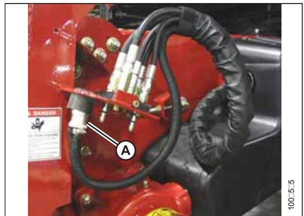
Abbildung 4.91: Multikuppler am Mähdrescher
