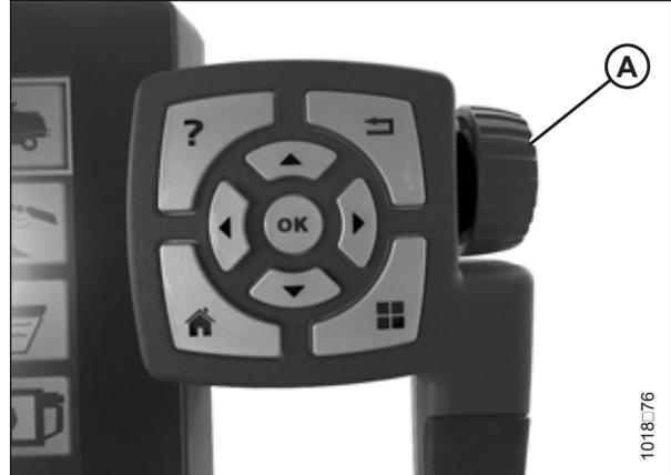
Abbildung 3.411: Scrollrad rechts am Tyton-Terminal
