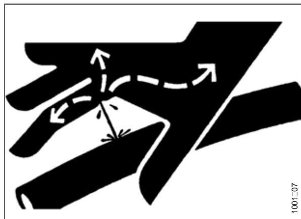
Abbildung 1.12: Gefährdung durch Hydraulikdruck
