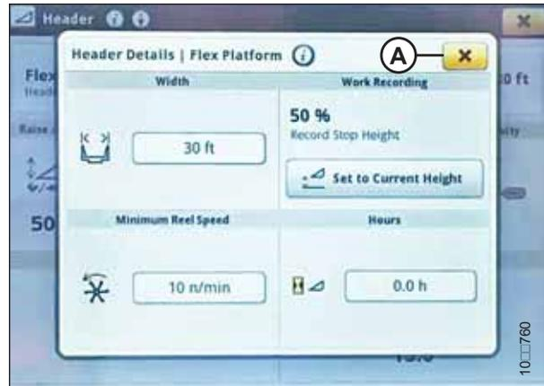
Abbildung 3.491: Display John Deere S7 – Auswahlfeld mit Schneidwerksangaben
