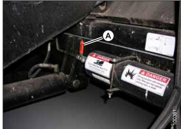
**Abbildung 3.372: Absperrhebel für Druckspeicher**
