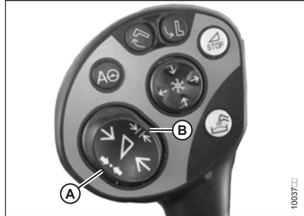
Abbildung 3.303: Tasten auf Multifunktionshebel
