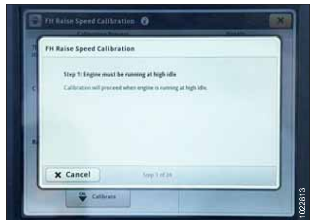
Abbildung 3.487: Display John Deere S7 – Kalibrierung Schrägförderer
