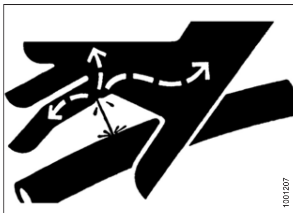
Figure 1.12: Risque lié à la pression hydraulique
