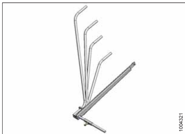
Figure 6.22: Tiges de formage d'andains
