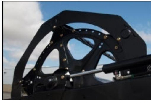
Os protetores de aço acoplam as extremidades do molinete e ajudam na eliminação de material em culturas pesadas e difíceis de cortar.
