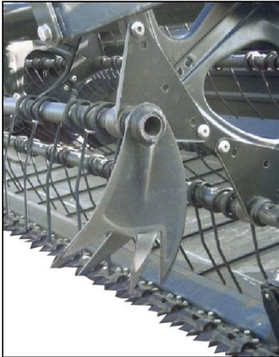
Os dedos de aço acoplam-se às extremidades de todas as outras barras de dente e ajudam na eliminação do material em arroz pesado e amontado.
