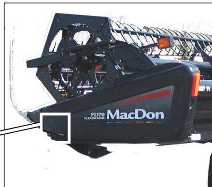
Para evitar aderência e/ou excessivo desgaste causados pela faca pressionando as ponteiros, não aplique muita graxa. Se mais de 6 a 8 injetadas de graxa forem necessárias para preencher a cavidade, substitua a vedação do cabeçalho da faca.
