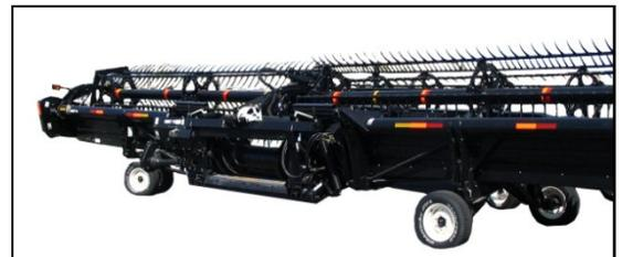
Disponível como um acessório, as rodas de estabilizador ajudam a estabilizar a plataforma em condições de campo que caso contrário poderia causar ondulação da plataforma e resultar em altura de corte irregular.
