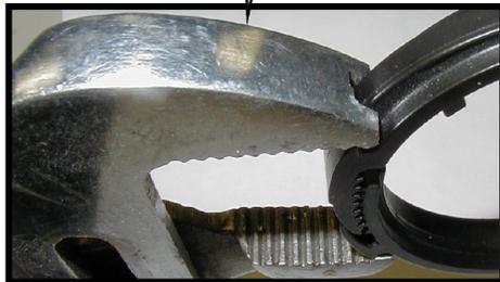
3. Aperte a braçadeira com o alicate de bloqueio de canal modificado (K) para que a pressão do dedo não mova a braçadeira.
