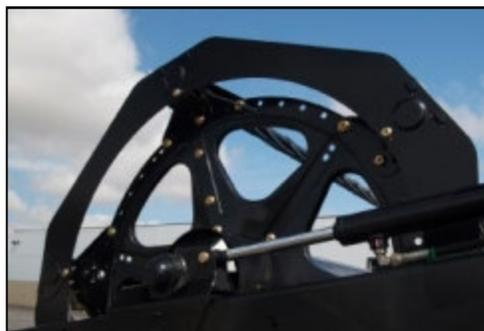
Los blindajes de acero se acoplan a los extremos del molinete y ayudan a limpiar el material en cultivos tupidos y difíciles de cortar.
