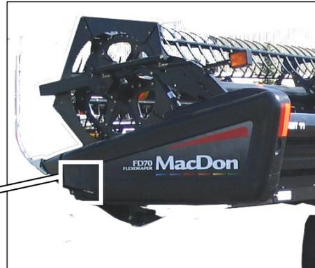
Para evitar la deformación y/o desgaste en exceso a causa de la presión de la cuchilla sobre los puntones, NO engrase en forma excesiva. Si se necesitan más de 6 a 8 bombas de pistola de grasa para llenar la cavidad, reemplace el sello en la cabeza de cuchilla.
