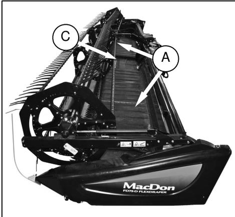
La velocidad de las lonas laterales/ plataforma (A) se regula en el control de flujo (B) en el adaptador CA25. El control tiene valores entre 0-9 en el barril y un orificio en la posición hora 12 en la cubierta del compartimiento hidráulico para fijar la velocidad de lona deseada.
