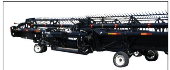
Disponibles como accesorio. Las ruedas estabilizadoras/auto-tráiler ayudan a estabilizar el plataforma en condiciones de campo que, caso contrario, harían que la plataforma rebote produciendo, como resultado, una altura de corte irregular.
