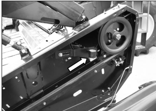
Se puede almacenar una cuchilla de repuesto en el tubo del bastidor de la plataforma del lado izquierdo tal como aparece en la foto arriba. Asegúrese que la cuchilla esté firme en su lugar.
