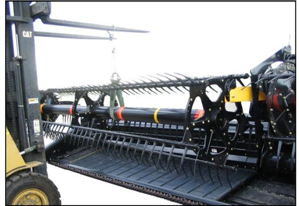
1. Apoye el extremo interno del molinete derecho con una cargadora frontal y eslingas de nylon (o equipo equivalente).
