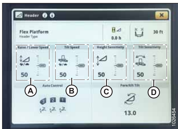
Obrázek 3.471: Displej stroje John Deere řady S7 – stránka adaptéru
