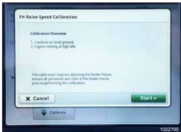
Obrázek 3.486: Displej stroje John Deere řady S7 – kalibrace šikmého dopravníku
