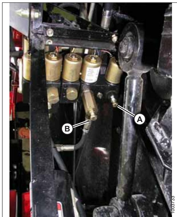
Obrázek 3.351: Nastavitelné omezovače zvedání a spouštění adaptéru
