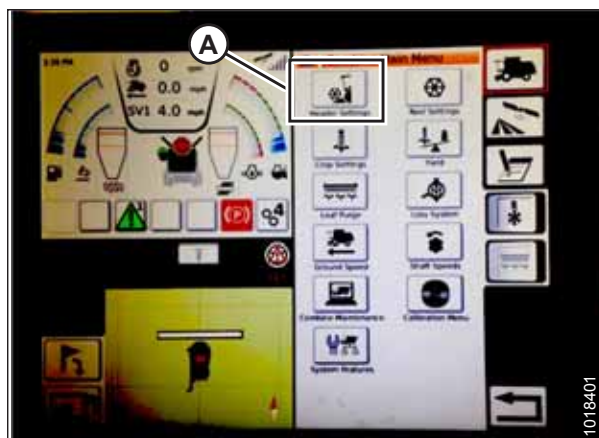
Obrázek 3.359: Nastavení adaptéru v hlavním menu sklízecí mlátičky
