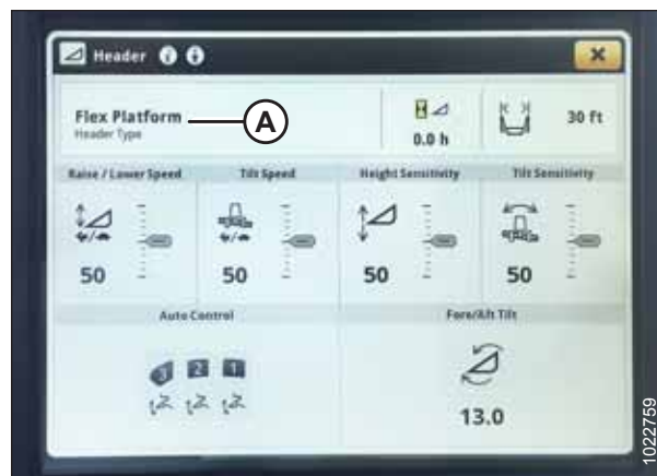
Obrázek 3.467: Displej stroje John Deere řady S7 – stránka adaptéru
