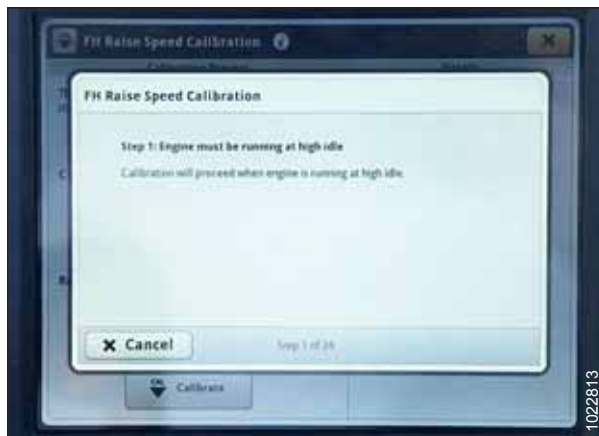
Obrázek 3.487: Displej stroje John Deere řady S7 – kalibrace šikmého dopravníku
