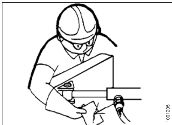
Obrázek 1.11: Kontrola výskytu netěsností v hydraulice
