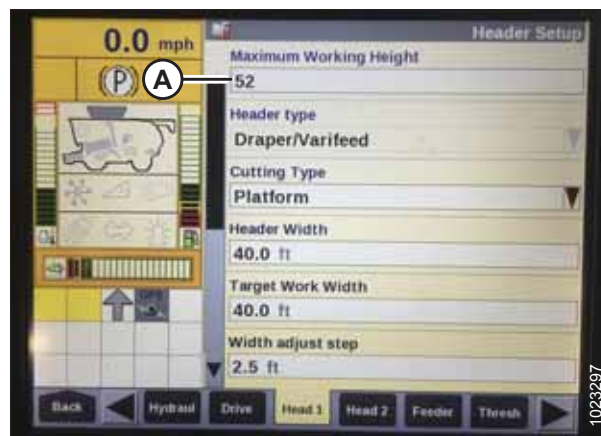
Obrázek 3.242: Displej sklízecí mlátičky Case – stránka Header Setup (nastavení adaptéru)
