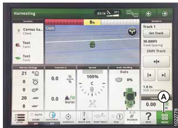
Obrázek 3.482: Displej stroje John Deere řady S7 – stránka sklizně
