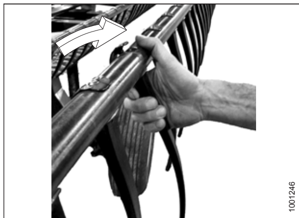
Obrázek 5.246: Montáž plastového prstu
