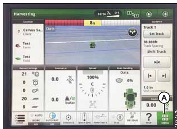
Obrázek 3.478: Displej stroje John Deere řady S7 – stránka sklizeň
