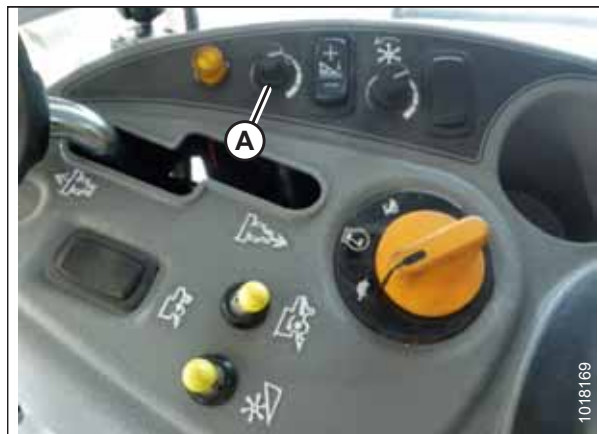
Obrázek 3.295: Ovladač pro nastavení výšky na ovládacím panelu sklízecí mlátičky
