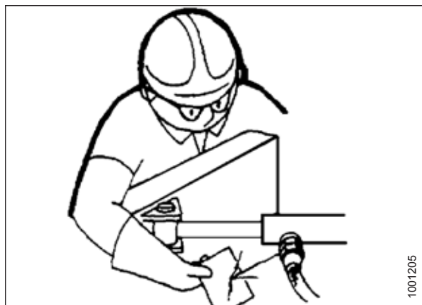
Obrázek 5.3: Kontrola výskytu netěsností v hydraulice
