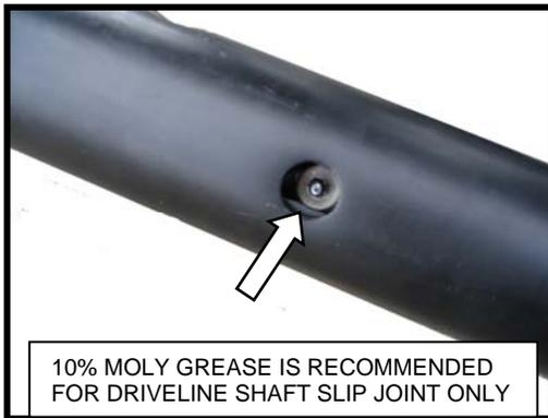
10% MOLY GREASE IS RECOMMENDED FOR DRIVELINE SHAFT SLIP JOINT ONLY
