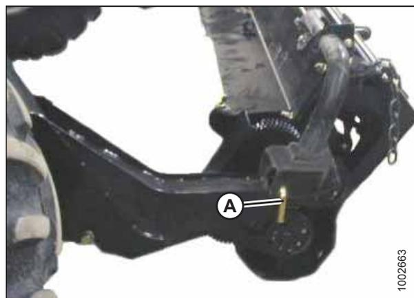
Рисунок 3.34: Рычаги косилки
