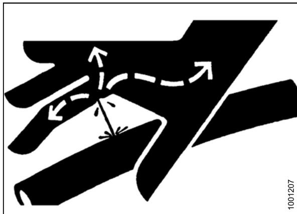
Рисунок 5.3: Опасное давление гидравлической жидкости
