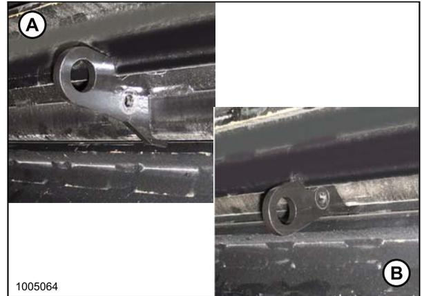
**Рисунок 3.72: Инструмент для синхронизации валцов**
