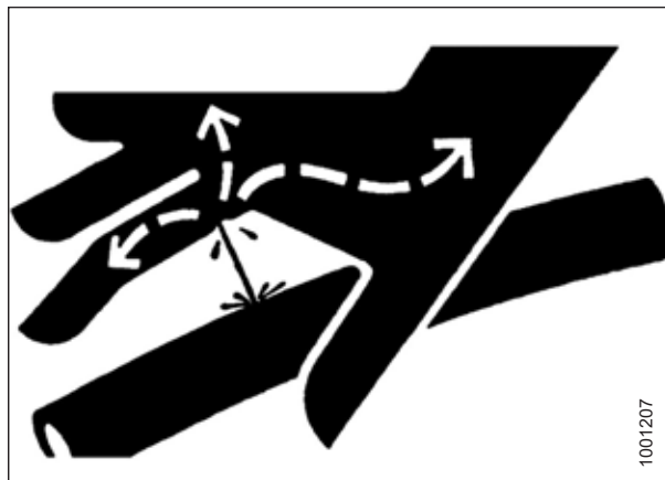
Рисунок 4.238: Опасное давление гидравлической жидкости
