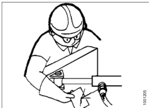
Рисунок 4.239: Проверка наличия гидравлических течей
