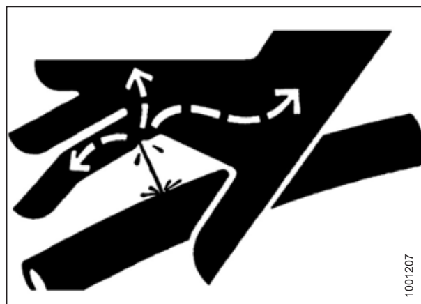
Рисунок 1.12: Опасное давление гидравлической жидкости
