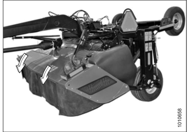
**Figure 3.145: Portes de la barre de coupe en position fermée**
