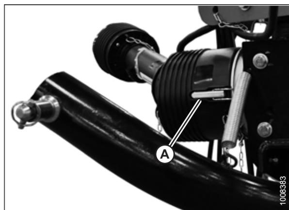
Figure 4.213: Cône de protection de la transmission et verrou de fixation à levier
