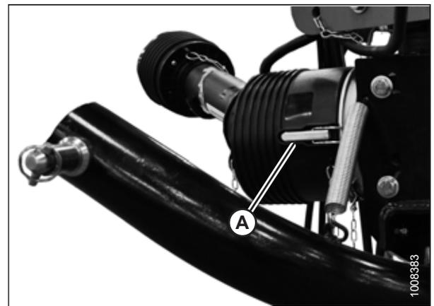
Figure 4.217: Soufflet attaché à la transmission
