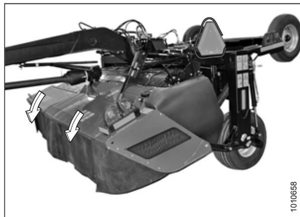
Figure 4.52: Portes de barre de coupe — Type tracté à disques rotatifs série R1
