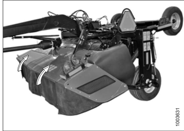
Figure 4.36: Portes de la barre de coupe – Type tracté à disques rotatifs série R1
