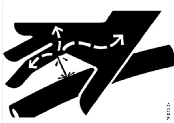
Figure 4.310: Risque lié à la pression hydraulique
