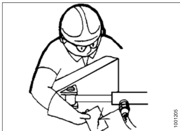
Рисунок 4.204: Проверка наличия гидравлических течей
