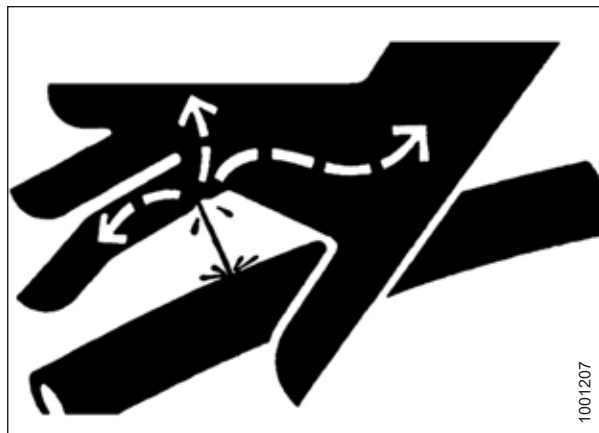
Рисунок 4.203: Опасное давление гидравлической жидкости
