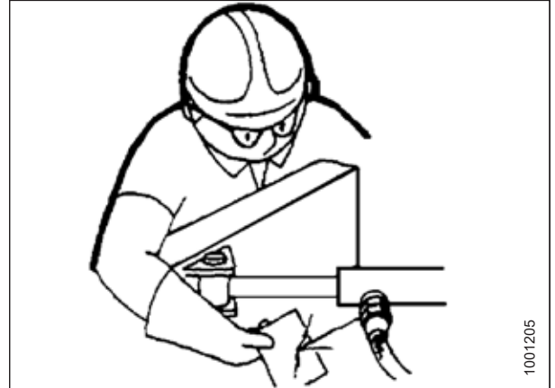
Рисунок 1.11: Проверка наличия гидравлических течей
