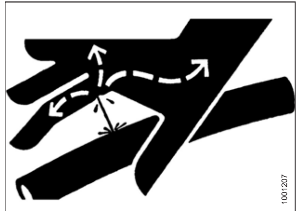
Рисунок 1.12: Опасное давление гидравлической жидкости
