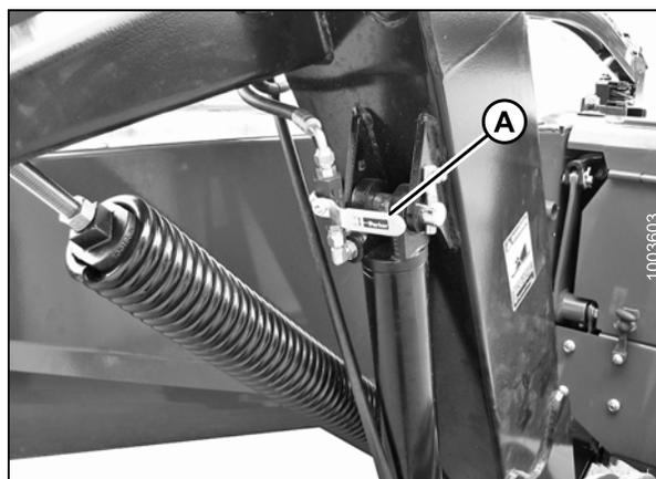
Figure 3.145: Clapets de verrouillage du vérin de levage
