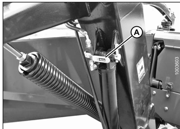
Figure 4.117: Clapets de verrouillage du vérin de levage
