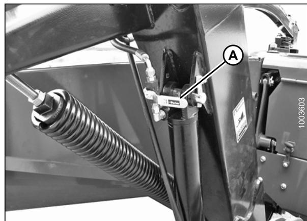
Figure 4.112: Clapets de verrouillage du vérin de levage
