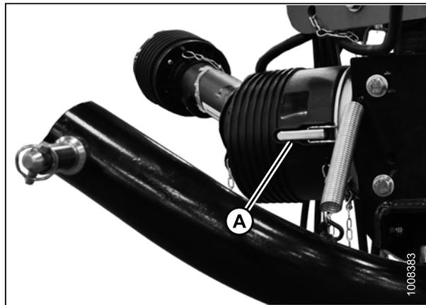
Figure 4.151: Soufflet attaché à la transmission
