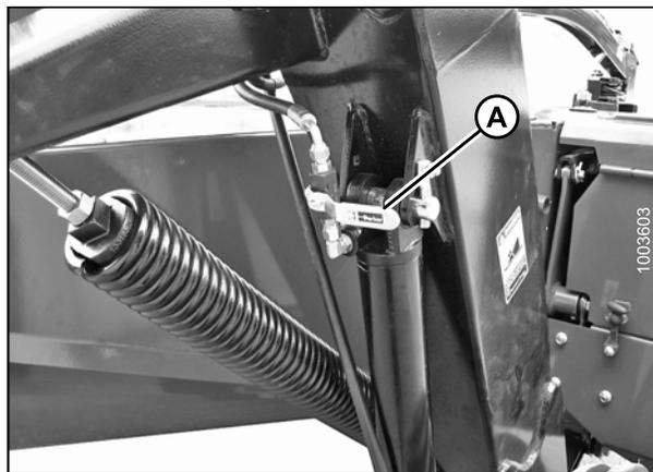
Figure 3.69: Vanne d'arrêt du vérin
