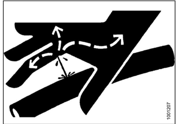
Figure 4.235: Risque lié à la pression hydraulique
