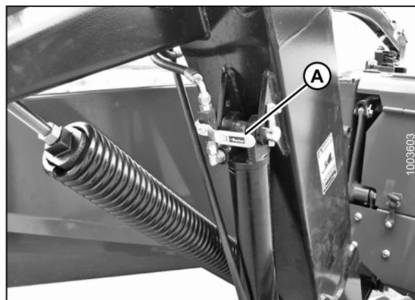
Figure 3.2: Vanne de verrouillage du vérin de levage
