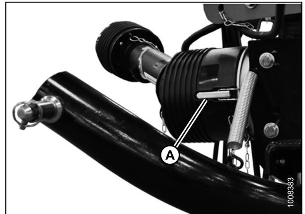
Figure 4.148: Soufflet de protection de la transmission et verrou à levier
