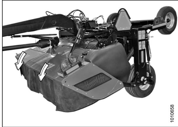
Figure 4.71: Portes de la barre de coupe en position fermée
