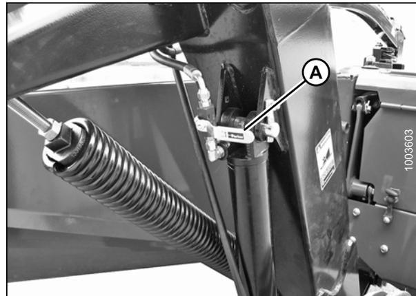
Figure 4.299: Vannes de verrouillage du vérin de levage
