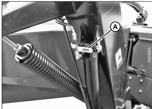
Figure 4.294: Vannes de verrouillage du vérin de levage
