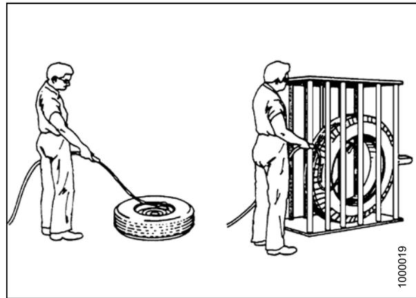
Figure 1.15: Gonflage sécuritaire d'un pneu avec de l'air
