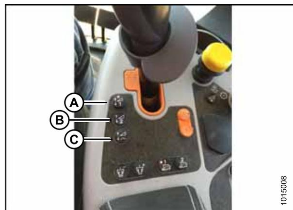
Figura 4.135: Controles de la cosechadora New Holland
