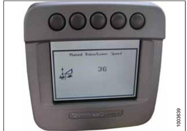
**Figura 4.77: Pantalla de la cosechadora John Deere**
