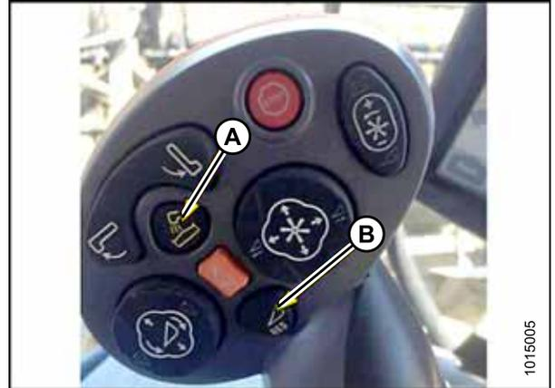
Figura 4.115: Controles de la cosechadora New Holland
