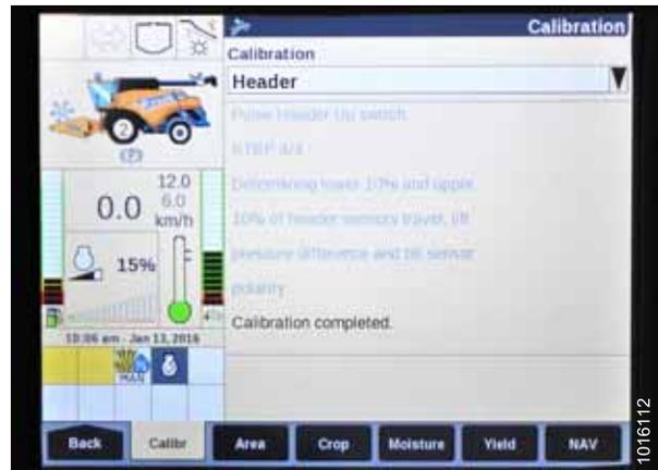
Figura 4.134: Pantalla de la cosechadora New Holland
