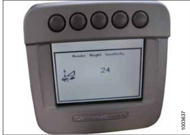
Figura 4.75: Pantalla de la cosechadora John Deere
