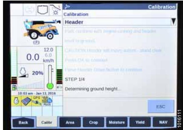
Figura 4.133: Pantalla de la cosechadora New Holland
