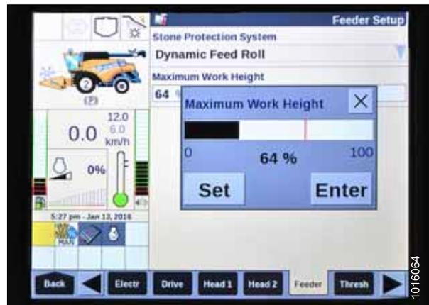
Figura 4.140: Pantalla de la cosechadora New Holland
