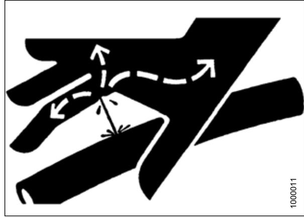
Figura 5.188: Peligro de presión hidráulica
