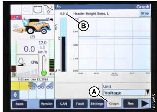
Figura 4.129: Pantalla de la cosechadora New Holland
