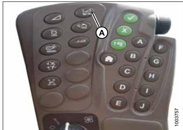
Figura 4.92: Centro de comando de la cosechadora John Deere
