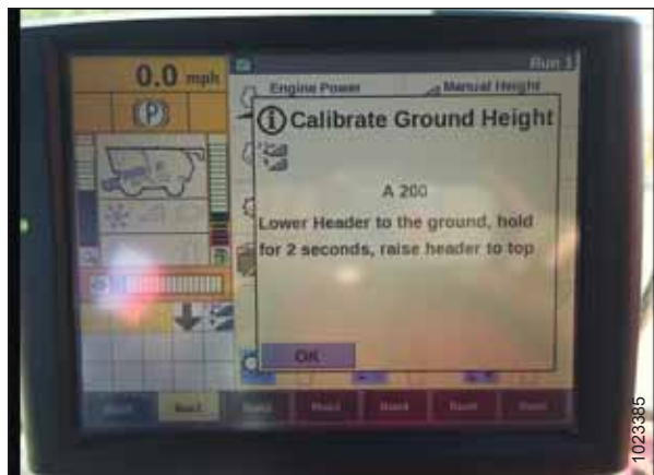
Рисунок 4.34: Калибровка системы автоматического контроля высоты подборщика
