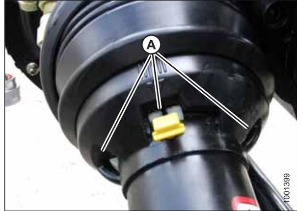
Figura 5.19: Proteção do eixo de transmissão
