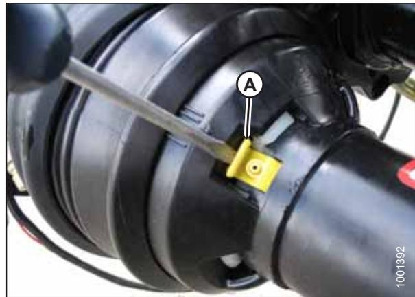
Figura 5.16: Proteção do eixo de transmissão
