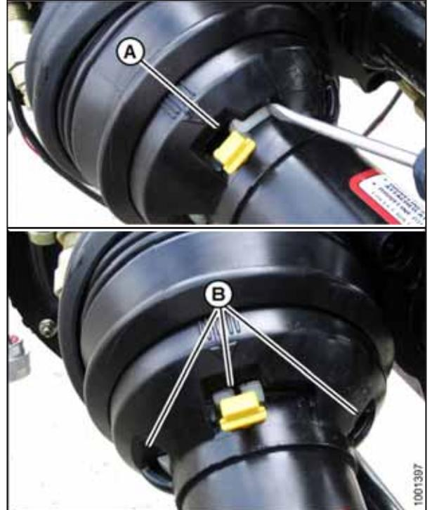
Figura 5.17: Proteção do eixo de transmissão
