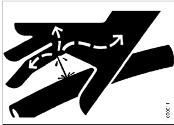
Figura 5.196: Perigo da pressão hidráulica
