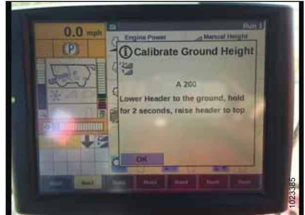
Figura 4.34: Calibração da altura automática da plataforma
