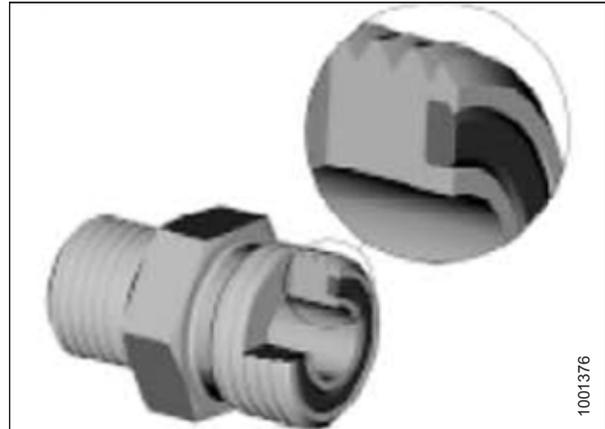
Figura 8.10: Encaixe hidráulico
