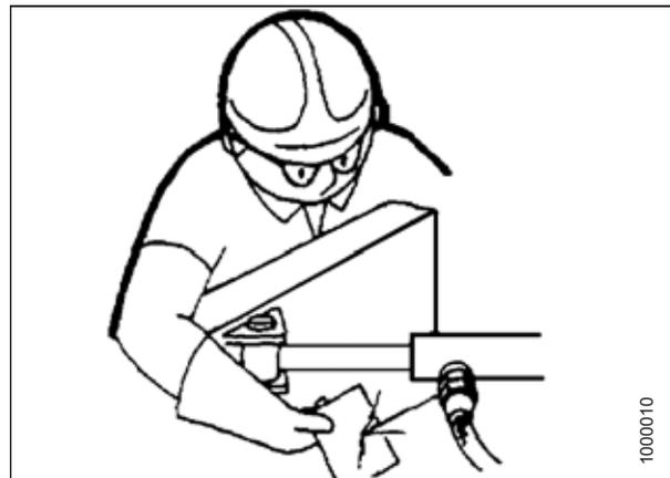
Figura 5.197: Teste para vazamentos hidráulicos
