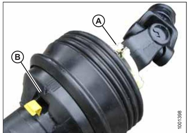
Figura 5.18: Proteção do eixo de transmissão
