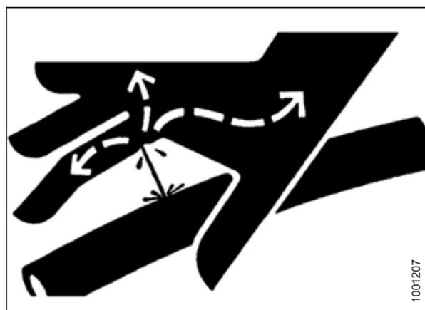
Figura 1.12: Perigo da pressão hidráulica
