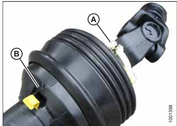
Figura 5.18: Proteção do eixo de transmissão
