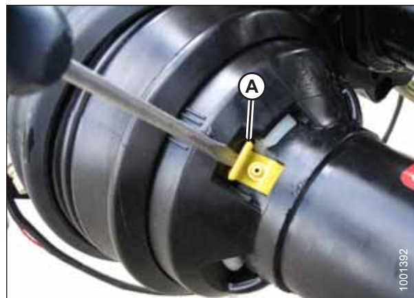
Figura 5.16: Proteção do eixo de transmissão
