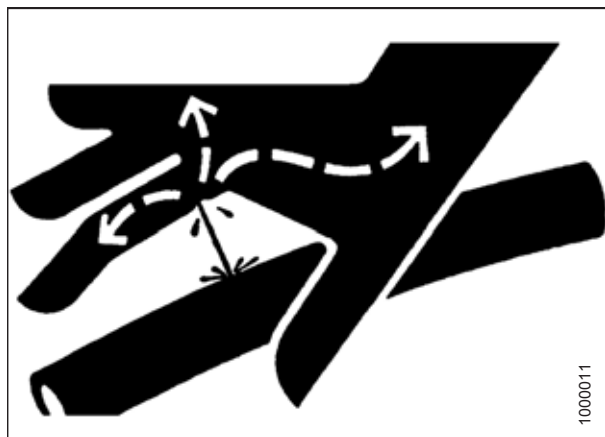
Figura 5.188: Perigo da pressão hidráulica
