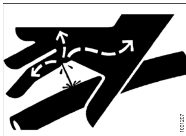
Figura 1.12: Perigo da pressão hidráulica
