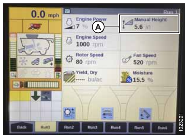
Figura 4.37: Monitor da colheitadeira Case - Tela Run 1 (Executar 1)
