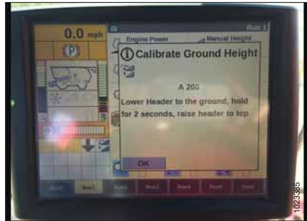
Figura 4.34: Calibração da altura automática da plataforma
