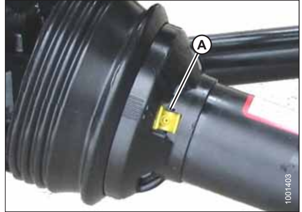
Figura 5.21: Proteção do eixo de transmissão
