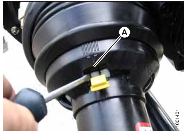
Figura 5.20: Proteção do eixo de transmissão
