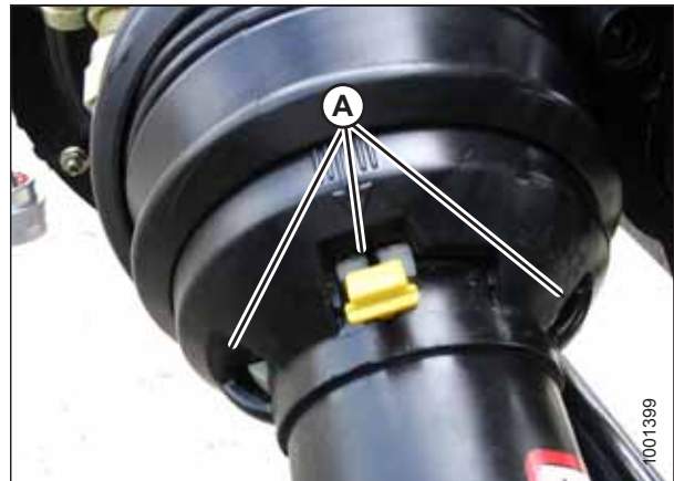
Figura 5.19: Proteção do eixo de transmissão
