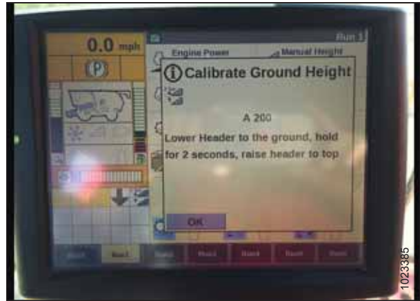
Figure 4.34: Étalonnage de la hauteur automatique de la plateforme
