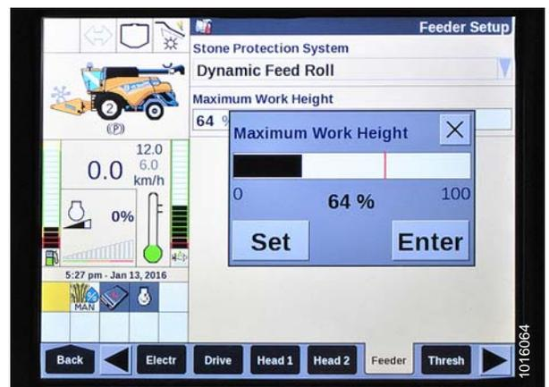
Figura 4.136: Pantalla de la cosechadora New Holland
