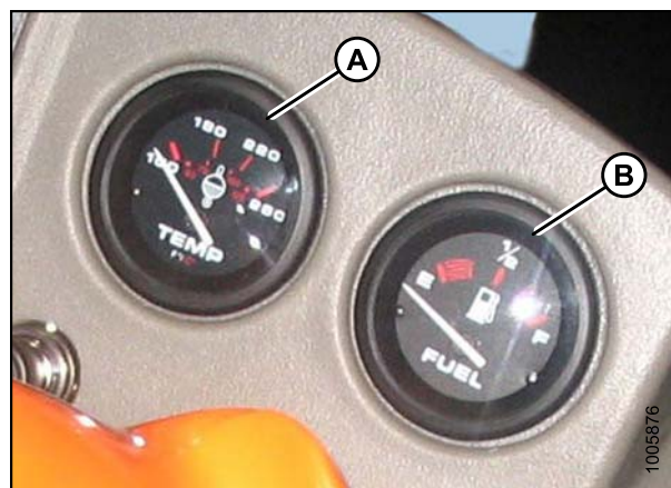
Рисунок 7.28: M155 и M205 Датчики температуры и уровня топлива
