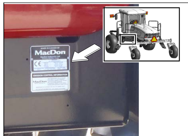
Рисунок 7.2: Расположение серийного номера M155/M205
