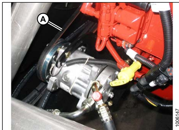
Рисунок 7.18: Ремень компрессора кондиционера
