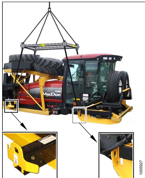
Рисунок 5.4: Точки подъема транспортной рамы
