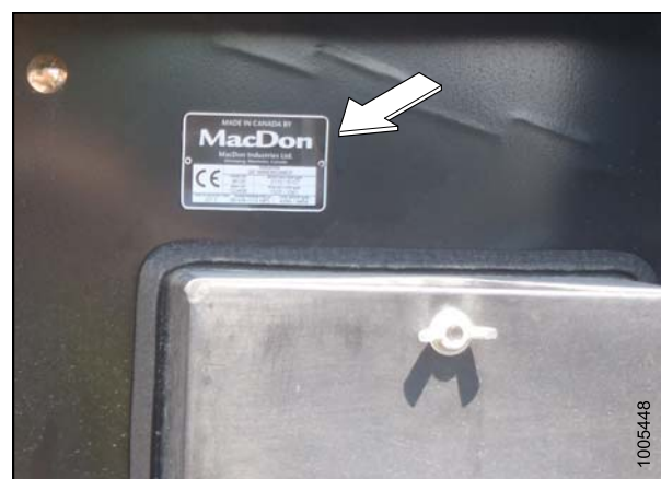
Рисунок 7.1: Расположение серийного номера M105
