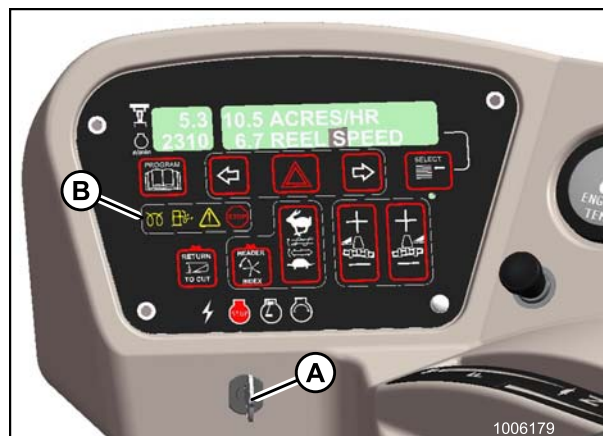
Рисунок 7.22: Модуль дисплея кабины (CDM) M155/M205
