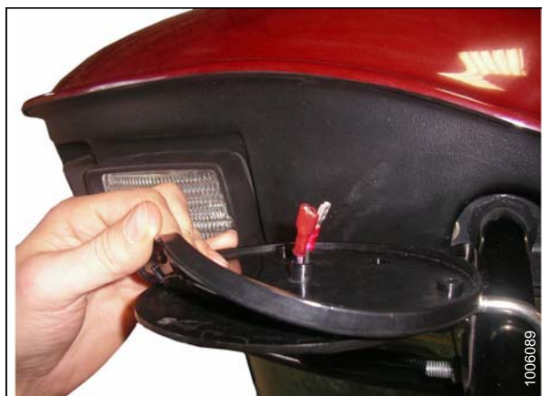
Рисунок 6.149: Резиновое основание проблескового маяка на монтажном кронштейне
