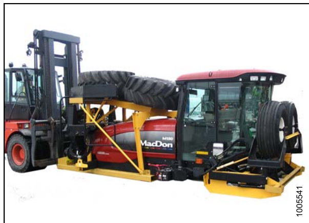
Рисунок 5.6: Перемещение транспортного комплекта косилки вилочным погрузчиком
