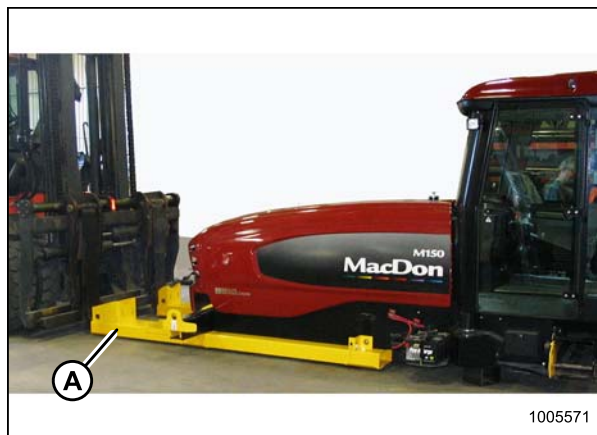
Рисунок 6.6: Подъем косилки вилочным погрузчиком
