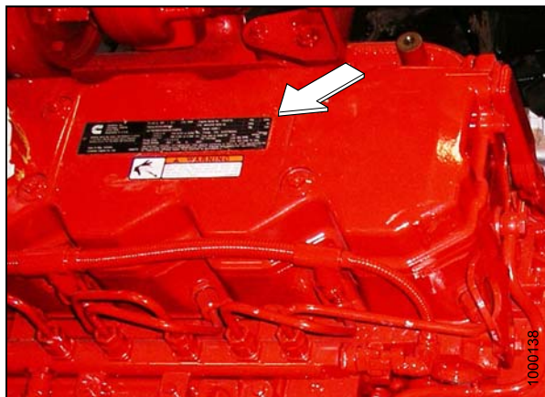
Рисунок 7.3: Расположение серийного номера двигателя
