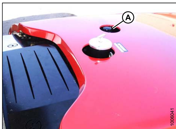
Рисунок 6.121: Крышка заливки масла/масляный щуп в капоте двигателя
