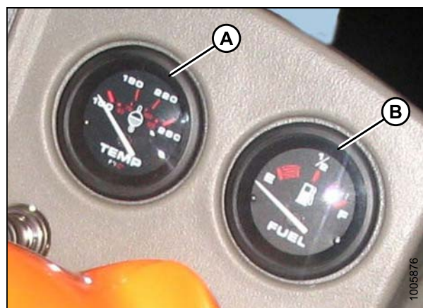
Рисунок 7.55: Датчики температуры двигателя и уровня топлива
