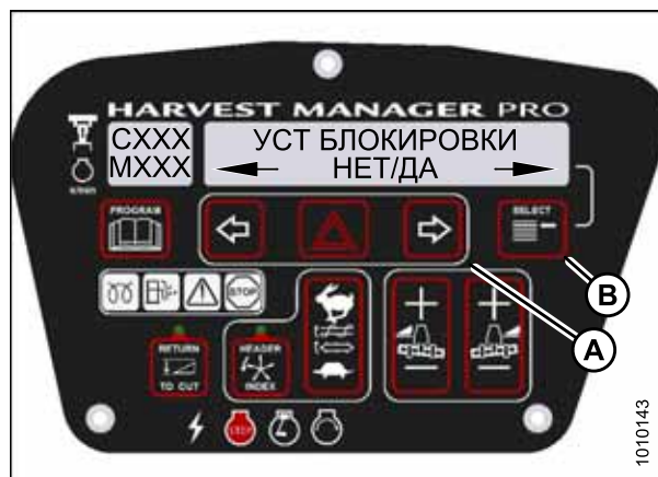
Рисунок 3.112: Блокировка органов управления M155
