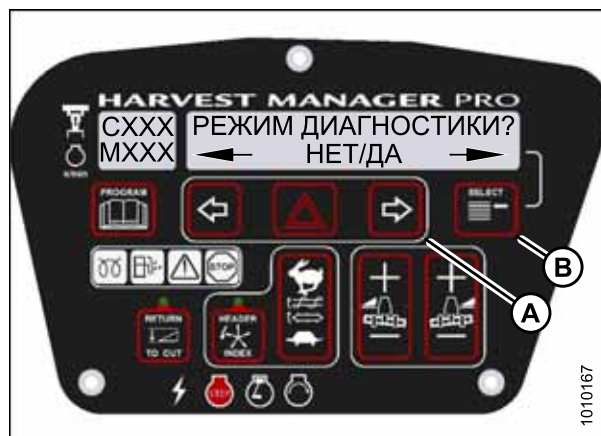
Рисунок 3.155: Функции диагностики M155
