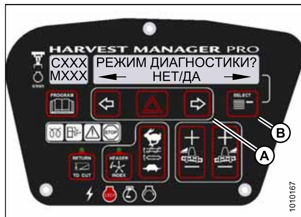
Рисунок 3.181: Функции диагностики M155
