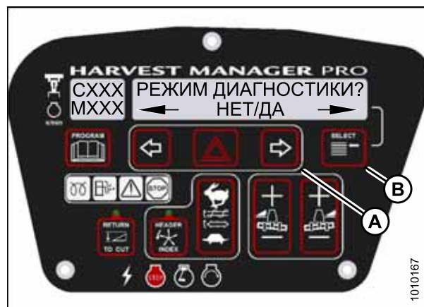
Рисунок 3.185: Функции диагностики M155
