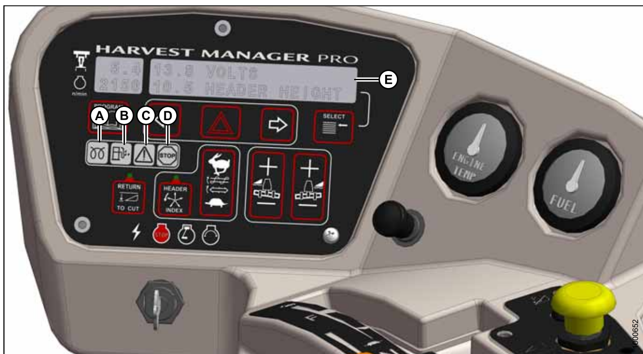
Рисунок 3.59: Сигнальные лампы двигателя CDM
