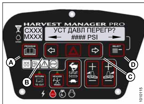
Рисунок 3.69: Гидравлическое давление перегрузки
