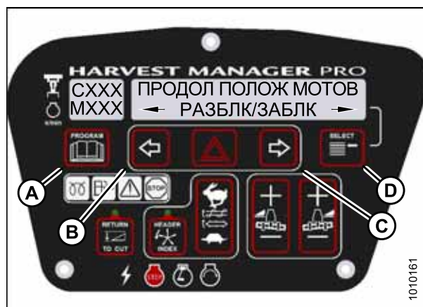
Рисунок 3.107: Блокировка управления продольным перемещением мотовила М155
