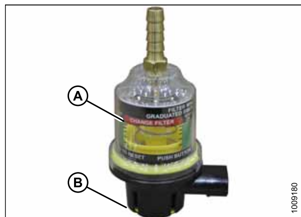
Рисунок 5.52: Индикатор сопротивления воздушного фильтра
