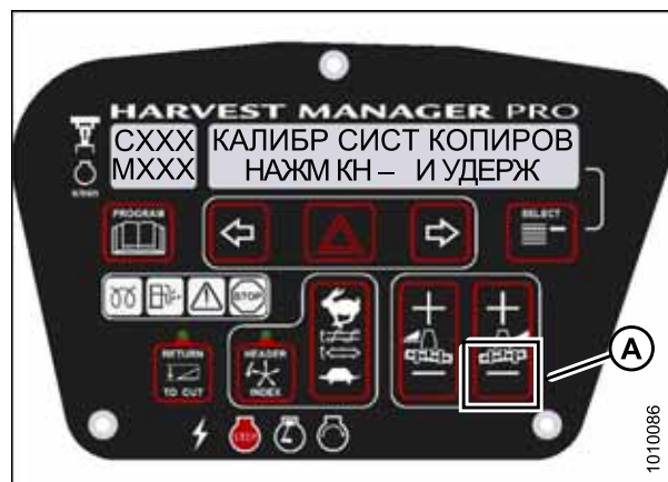
Рисунок 3.153: Отображение отрицательной флотации жатки M155
