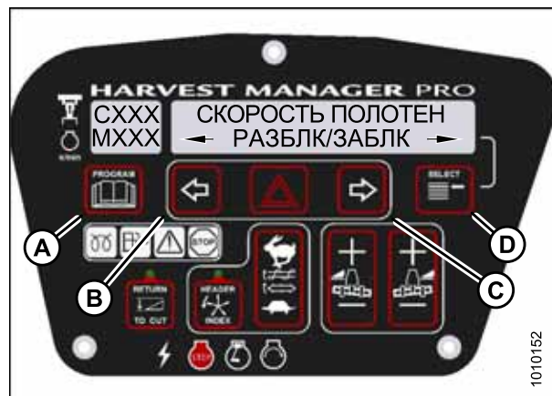
Рисунок 3.110: Блокировка управления движением полотна M155
