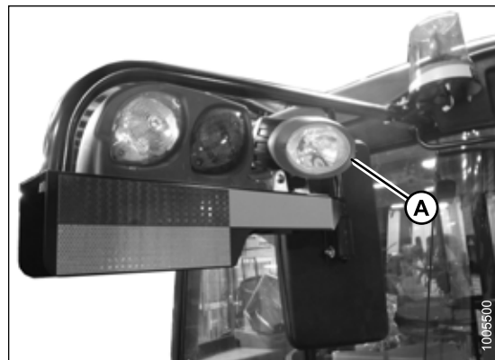
Рисунок 3.19: Дополнительные ксеноновые лампы (опционально)
