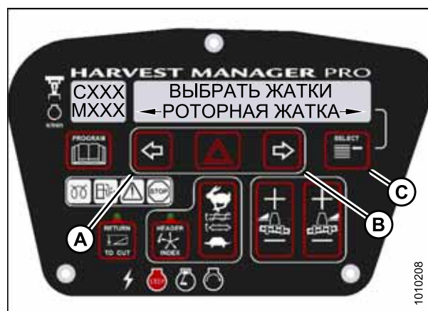
Рисунок 3.167: Тип жатки M155
