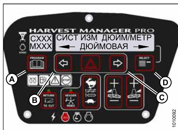
Рисунок 3.131: Единицы измерения дисплея M155
