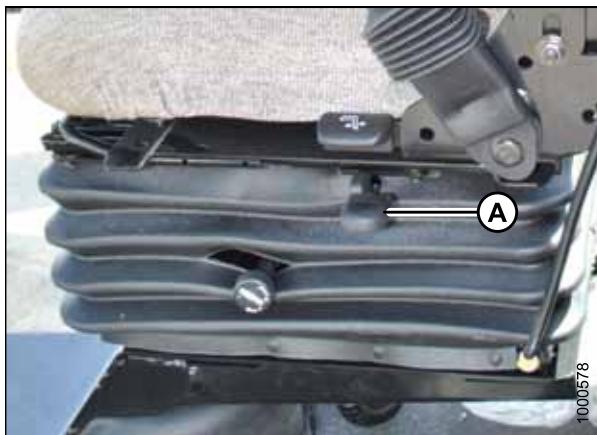
Рисунок 3.8: Фиксация перемещения амортизатора вперед-назад
