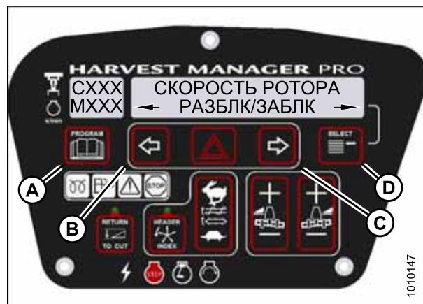
Рисунок 3.119: Блокировка управления скоростью диска M155
