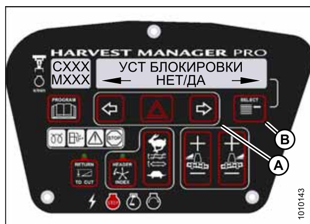
Рисунок 3.118: Блокировка органов управления M155
