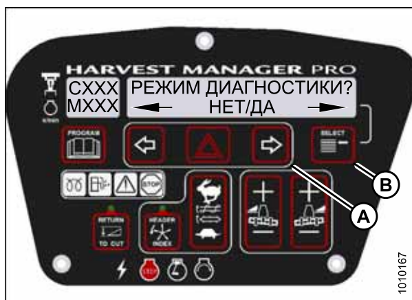
Рисунок 3.173: Функции диагностики M155
