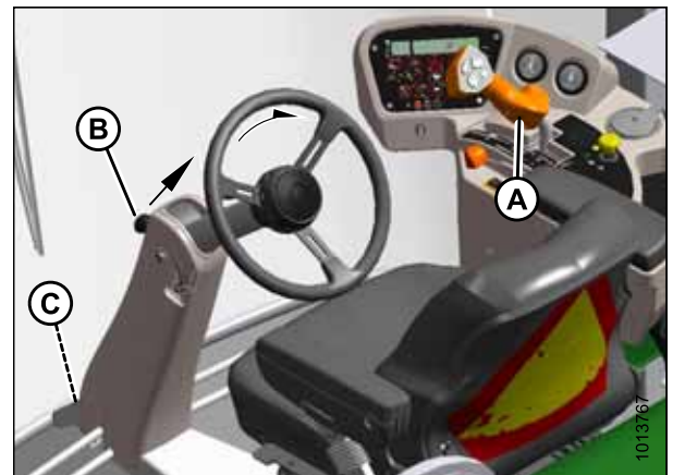
Рисунок 4.20: Двигатель вперед — сиденье обращено к двигателю
