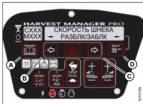
Рисунок 3.113: Блокировка управления шнеком M155
