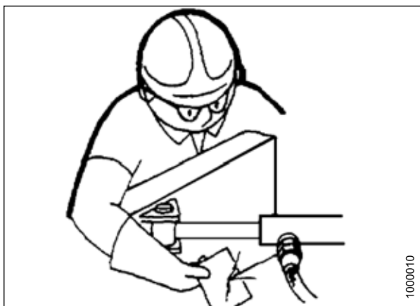
Рисунок 5.177: Проверка герметичности гидросистемы
