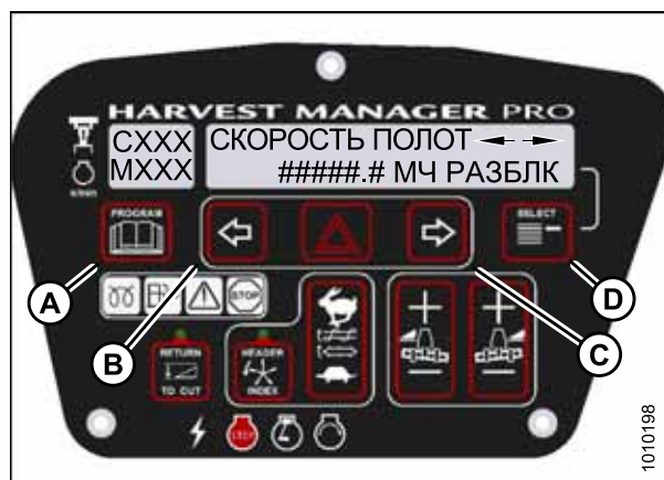
Рисунок 3.125: Блокировка органов управления M155
