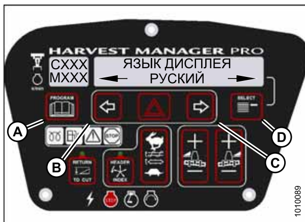
Рисунок 3.128: Отображение языка M155
