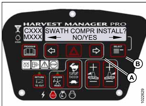
Рисунок 3.87: Органы управления уплотнителя валков
