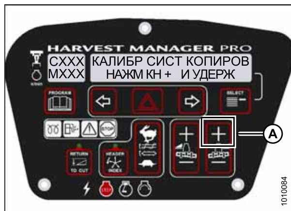
Рисунок 3.152: Отображение положительной флотации жатки M155
