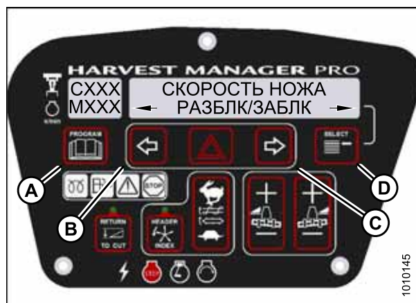
Рисунок 3.116: Блокировка управления скоростью ножа M155
