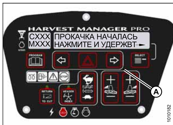
Рисунок 3.208: Цикл гидравлической прокачки M155
