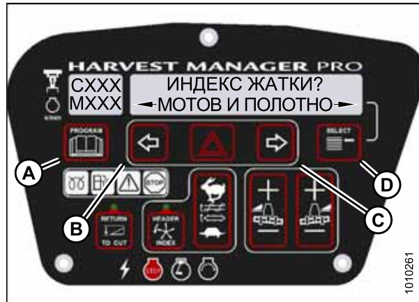
Рисунок 3.71: Дискретный режим жатки
