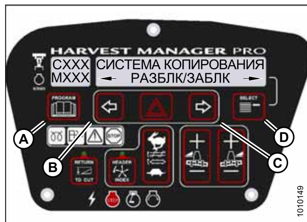
Рисунок 3.104: Блокировка управления флотацией жатки M155
