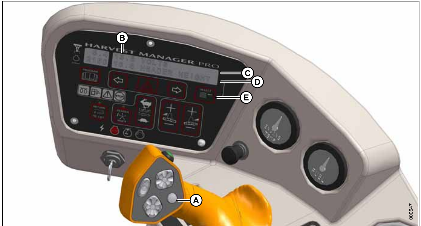
Рисунок 4.74: Процесс регулировки флотации на дисплейном модуле (CDM)
