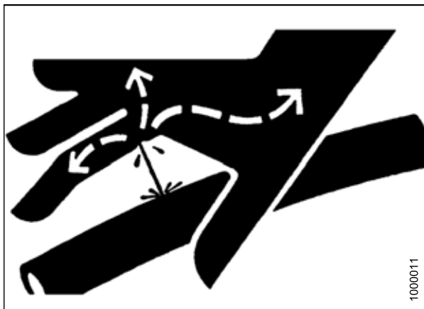
Рисунок 5.176: Опасное давление гидравлической жидкости
