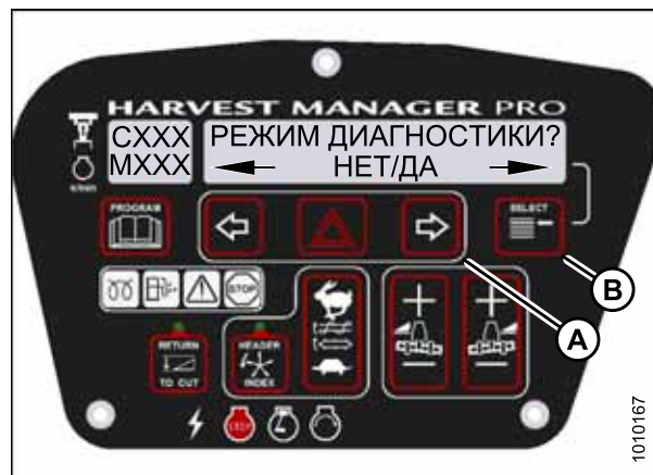
Рисунок 3.162: Функции диагностики M155
