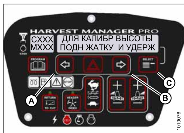
Рисунок 3.142: Калибровка высоты жатки M155
