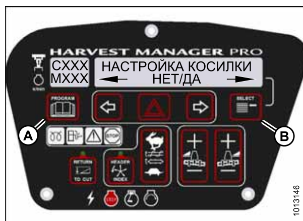
Рисунок 3.189: Функции диагностики M155
