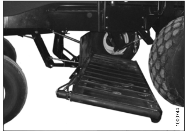
Рисунок 4.98: DWA на самоходной валковой косилке
