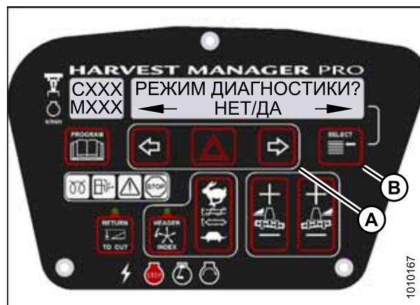
Рисунок 3.193: Функции диагностики M155
