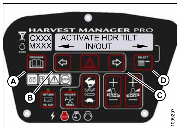
Рисунок 3.179: Угол наклона жатки M155
