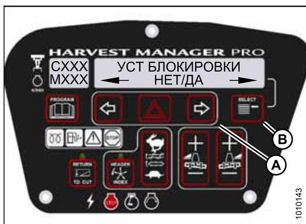
Рисунок 3.121: Блокировка органов управления M155
