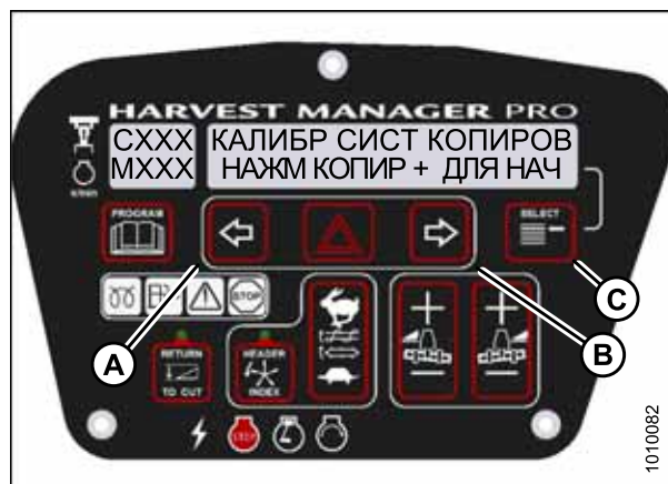
Рисунок 3.151: Отображение флотации жатки M155
