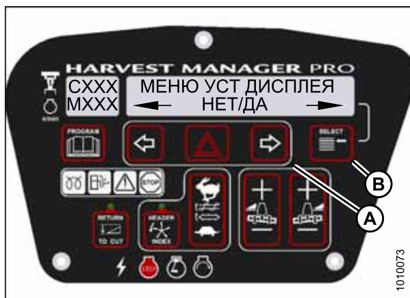
Рисунок 3.133: Настройки дисплея кабины M155
