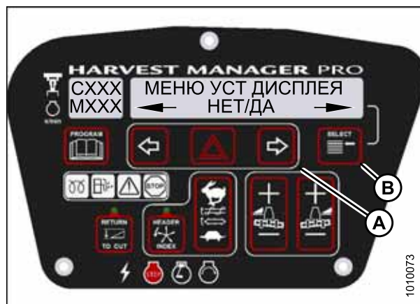
Рисунок 3.139: Настройки дисплея кабины M155
