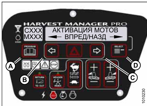
Рисунок 3.203: Продольное перемещение мотвила M155
