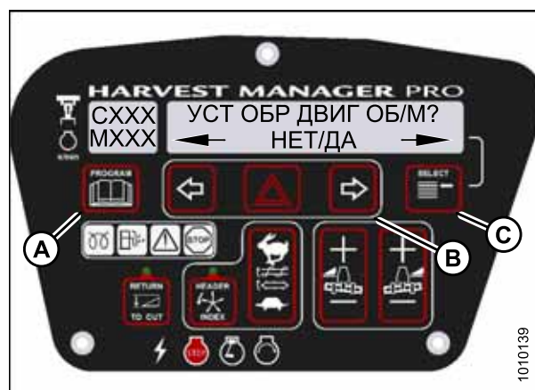
Рисунок 3.96: Обороты ISC двигателя M155
