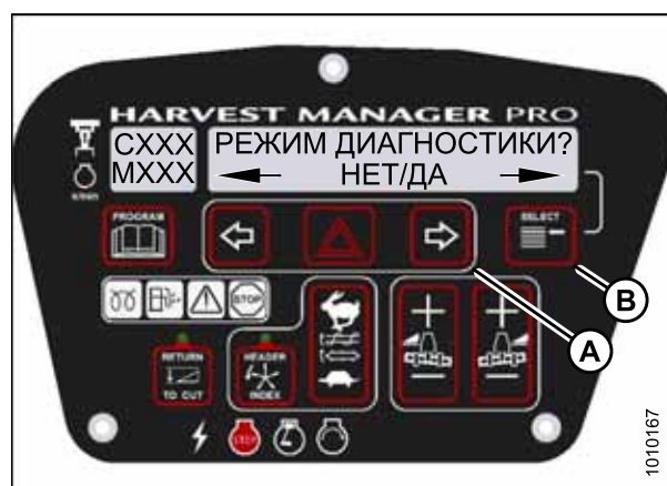
Рисунок 3.201: Функции диагностики M155
