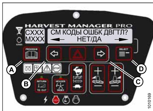
Рисунок 3.157: Коды двигателя M155
