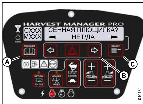
Рисунок 3.90: На рисунке показано подключение сеной плющилки M155
