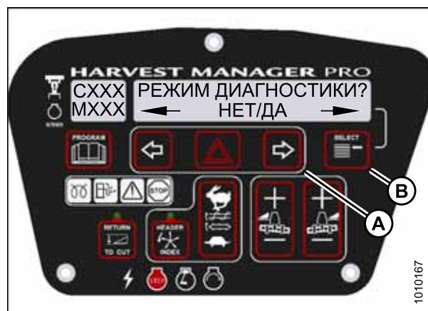
Рисунок 3.159: Функции диагностики M155
