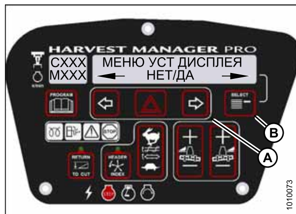
Рисунок 3.136: Настройки дисплея кабины M155
