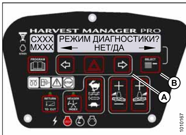
Рисунок 3.169: Функции диагностики M155
