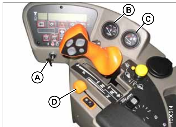
Рисунок 3.41: Органы управления двигателем и измерительные приборы
