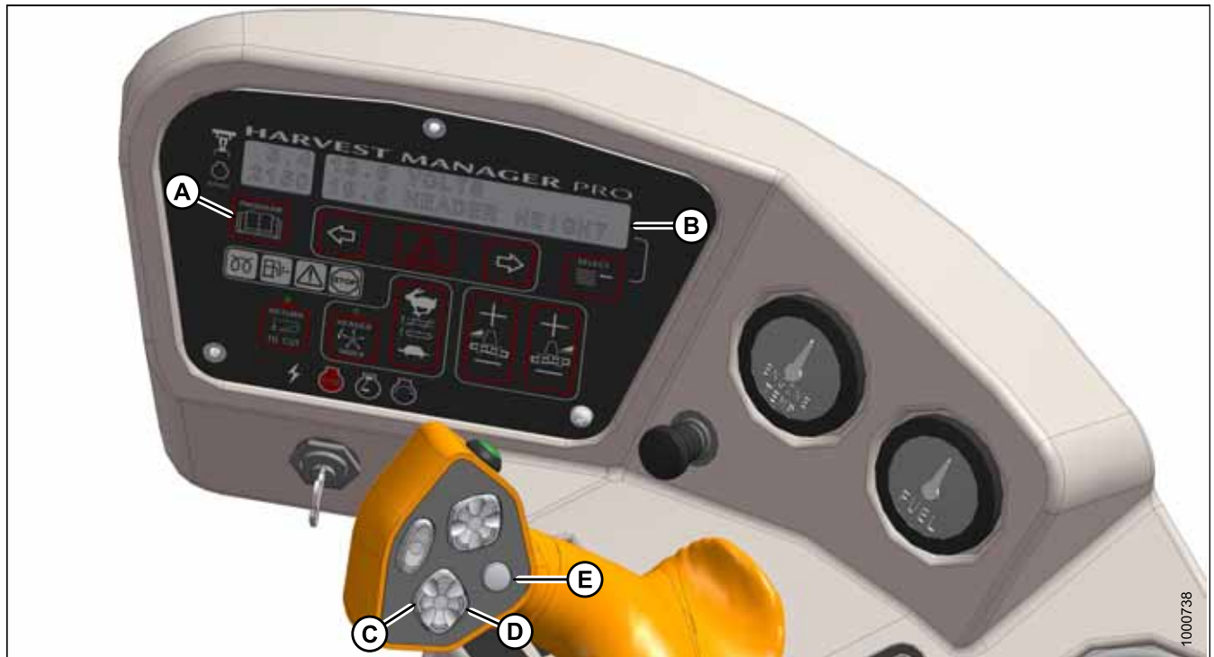
A — кнопка программирования B — дисплей C — наклон жатки вниз D — наклон жатки вверх E — селектор дисплея
