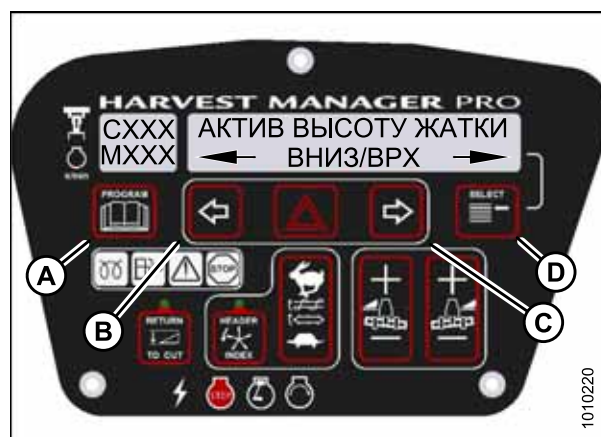
Рисунок 3.171: Высота жатки M155
